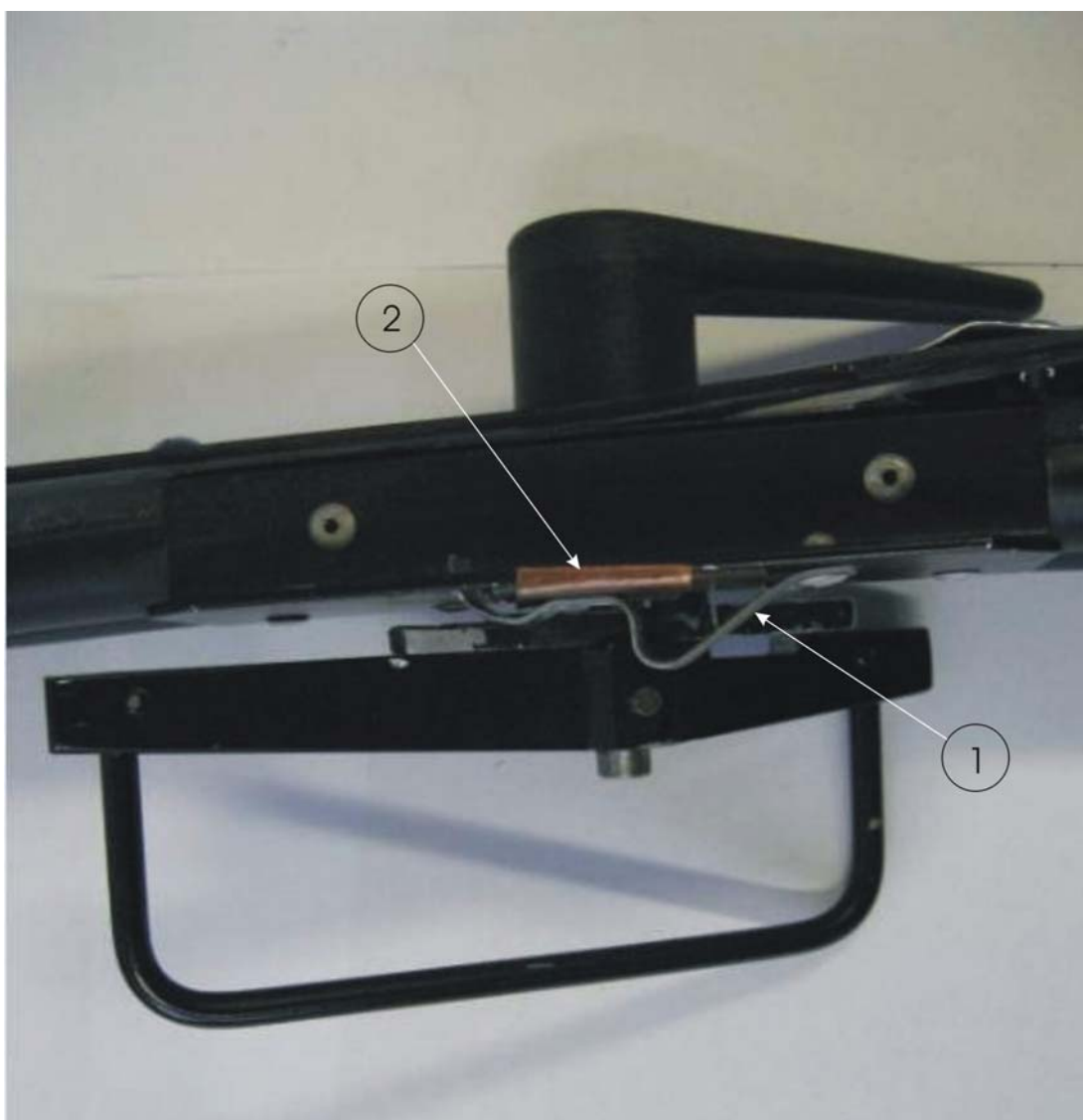
Kuva 4. Kuomun lukituskahva, kahvan kiinniasennossa pitävä lukitusjousi ja sen alle asennettu lisälevy. Kuvassa lukituskahva on auki-asennossa. Selite: 1. Lukitusjousi ja 2. lisälevy.
