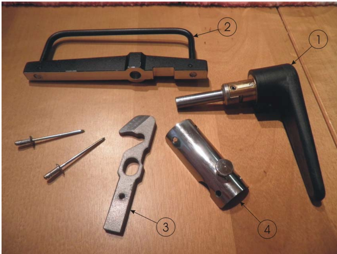
Kuva 3. Toisen EV-97 Eurostar-lentokoneen kuomun lukituksen muutostyöhön toimitetut osat. Selite: 1. ulkopuolinen kahva, 2. sisäpuolinen kahva, 3. sisäpuoliseen kahvaan kiinnitettävä lukituskoukku ja 4. laipallinen lukitustappi.
