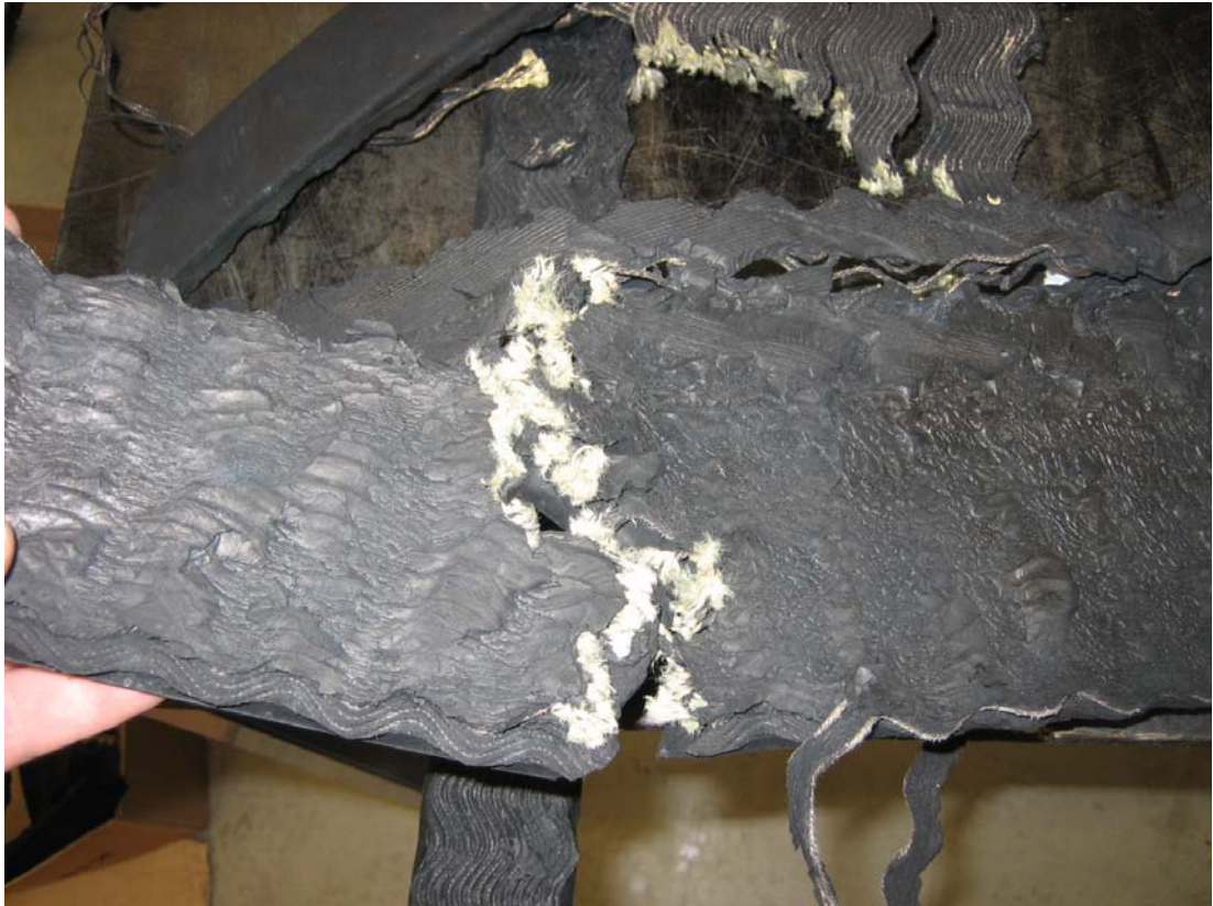
Kuva 3. Revennyt pinnoite ja aramidi-suojakudosta (valkoinen materiaali)
