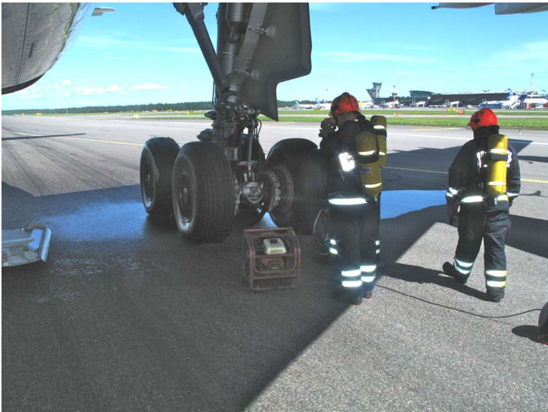
Kuva 1. Kiitotielle vuotanut hydraulineselammikko
