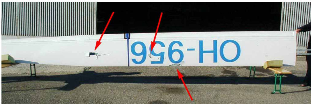
Kuva 2. AC:n vasemman siiven alapinta. Nuolet osoittavat siivestä löydettyihin reikiin.
