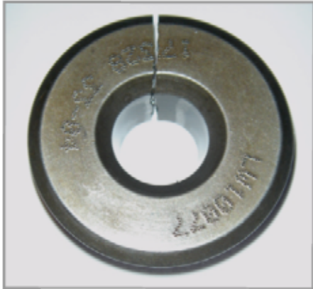
Kuva 6. Sylinterin no 4 imuventtiilin ulompi jousilautanen
