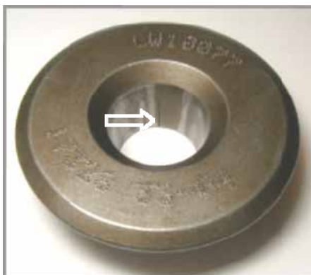
Kuva 8. Sylinterin no 3 imuventtiilin ulompi jousilautanen
