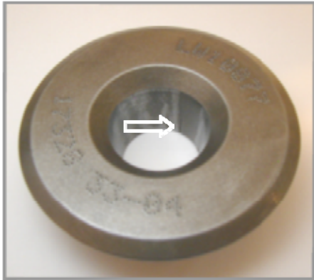
Kuva 7. Sylinterin no 2 imuventtiilin ulompi jousilautanen
