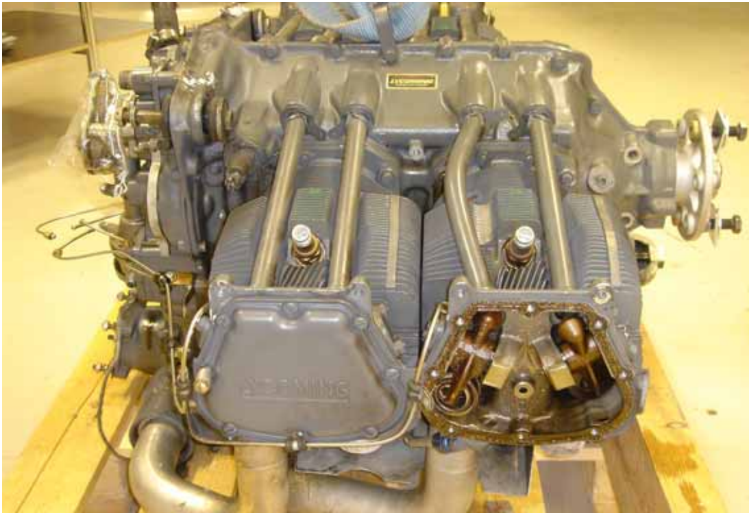
Kuva 3. Sylinterin no 1 imuventtiin työntötangon taipunut suoja-putki.
