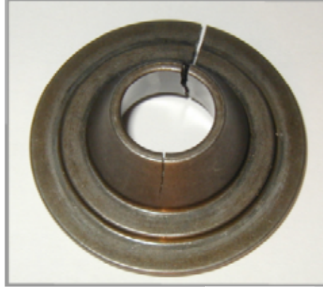
Kuva 6. Sylinterin no 4 imuventtiilin ulompi jousilautanen
