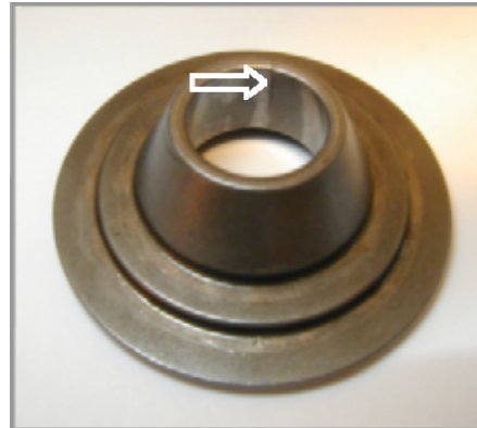
Kuva 7. Sylinterin no 2 imuventtiilin ulompi jousilautanen
