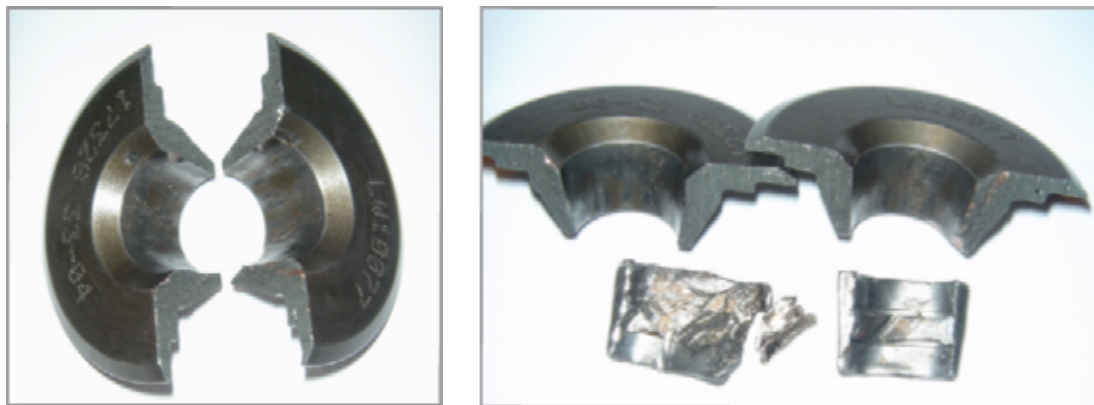
Kuva 5. Sylinterin no 1 haljennut imuventtiilin ulompi jousilautanen ja lukituskiilat
