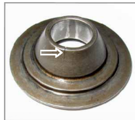
Kuva 8. Sylinterin no 3 imuventtiilin ulompi jousilautanen
