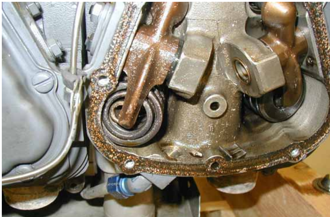
Kuva 4. Sylinterin no 1 imuventtiili oli siirtynyt sylinteriin.
