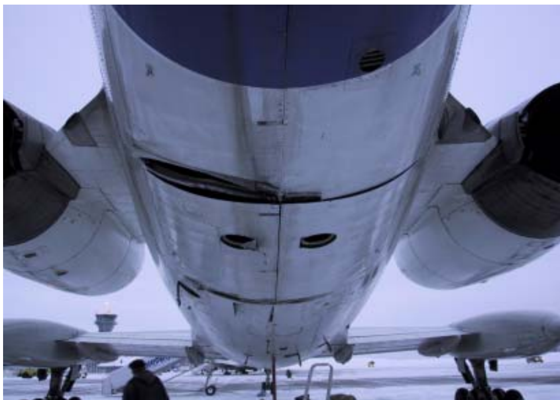
Kuva 3, Lentokoneen takarungon vauriot
