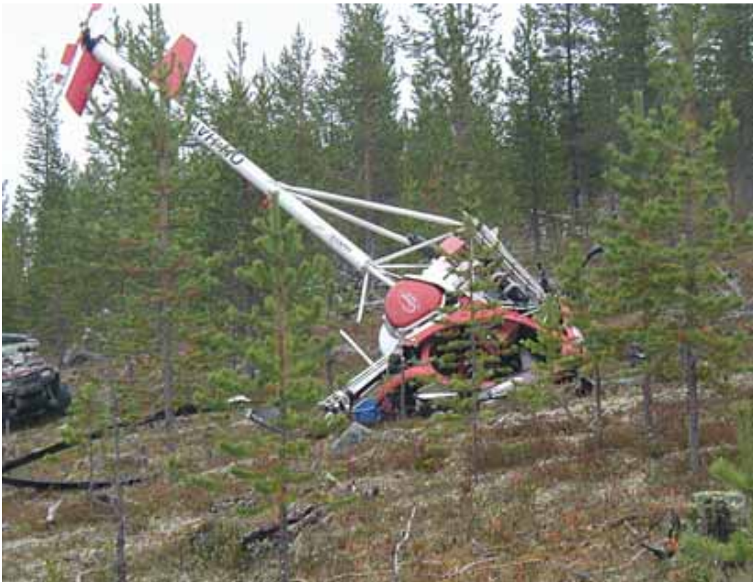
Kuva 4. Kuvassa näkyy nurjahtamalla katkennut maston takatuki
