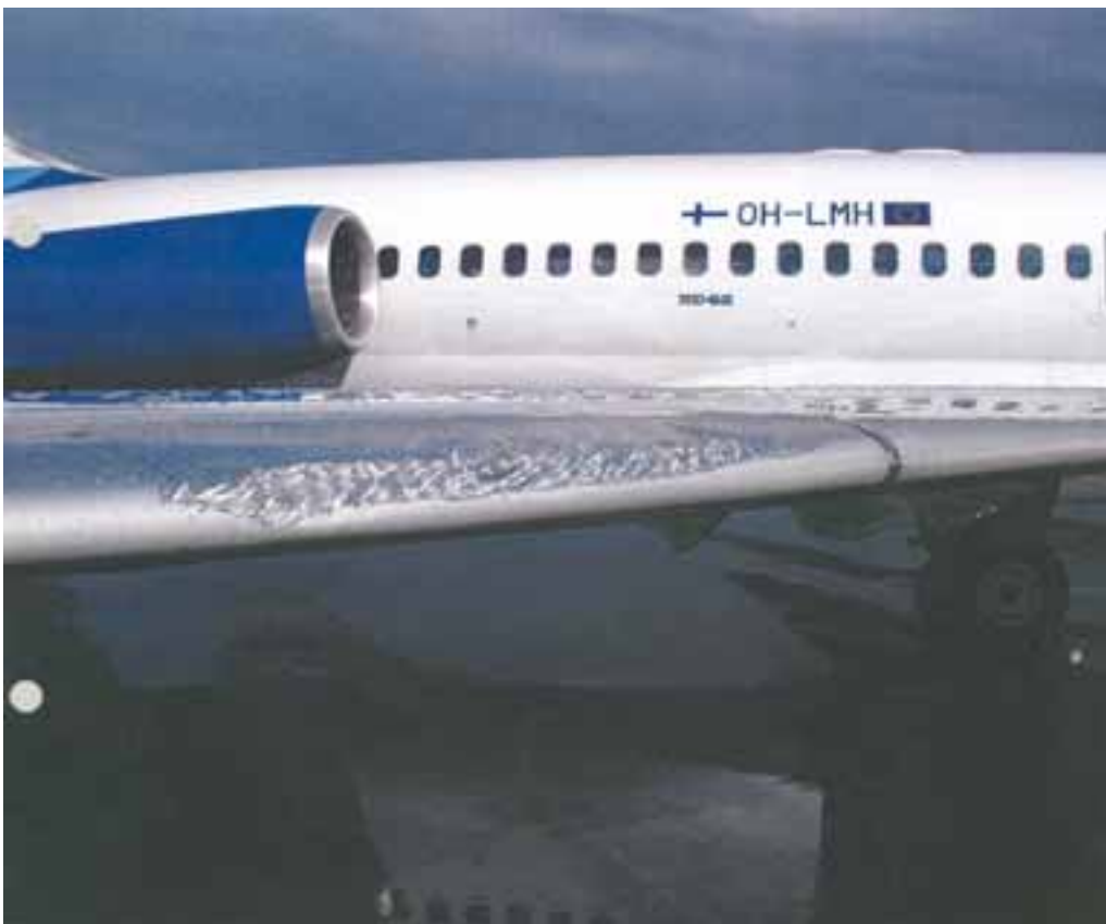
Kuva 5. MD-82 -koneen vaurioitunut siipi. (Kuva: Finnair Oyj tekniikka)
