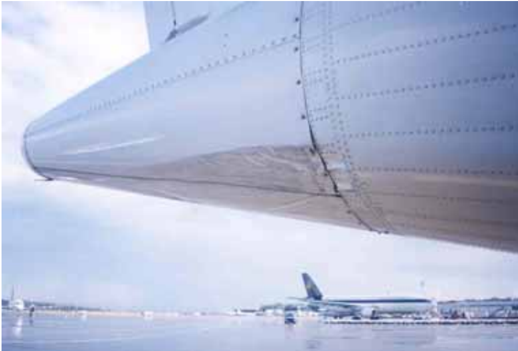
Kuva 4. ATR 72 -koneen vaurioitunut pyrstökartio. (Kuva: Liikkuva Poliisi, lentoaseman yksikkö)
