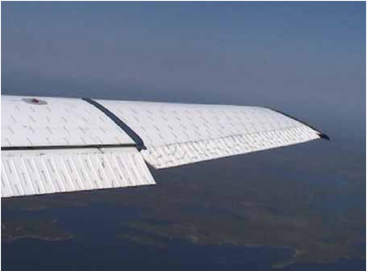
Kuva 8. Laskusiiveke lentoonlähtöasennossa (20°), jolloin kallistussiiveke on 13° alaspäin kääntyneenä nopeudella 80 solmua. Virtauksen irtaantuminen näkyy kallistussiivekkeen yläpinnalla villalankojen asennosta.
