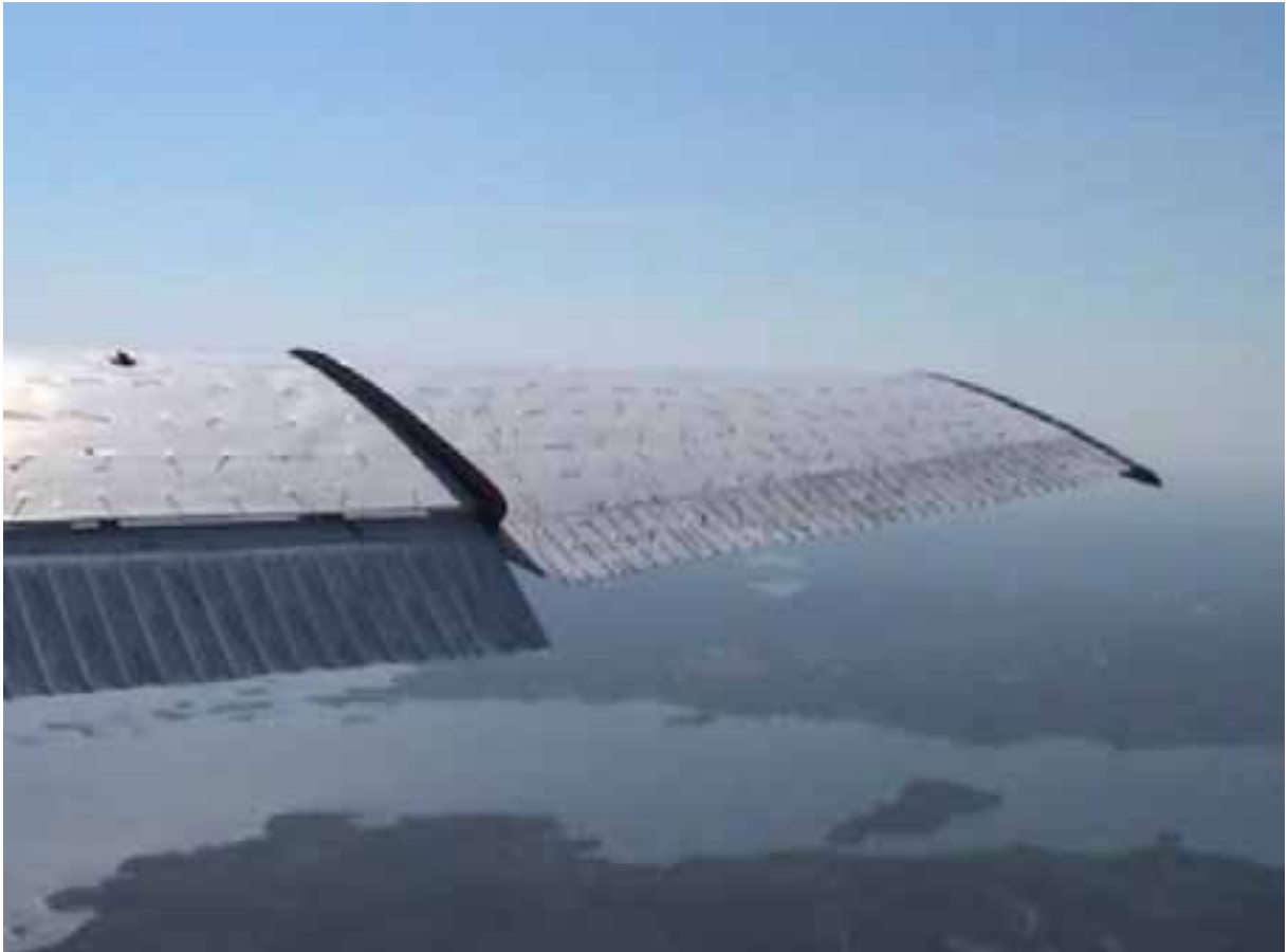
Kuva 10. Virtauksen irtoaminen koko oikeasta siivestä, jolloin koko siipi on sakannut.
