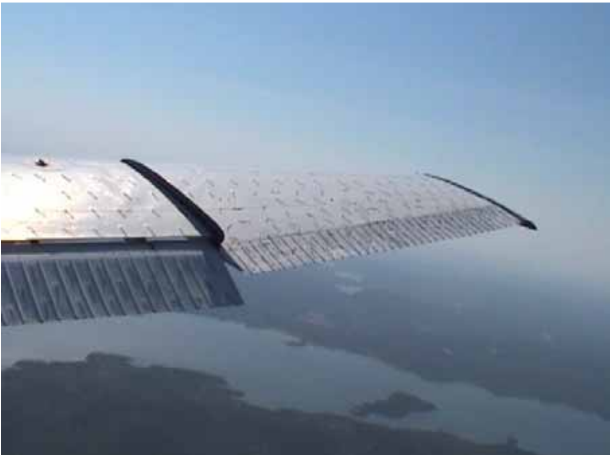
Kuva 9. Virtauksen irtoaminen oikean siiven kärjestä sakkauksen alkaessa.
