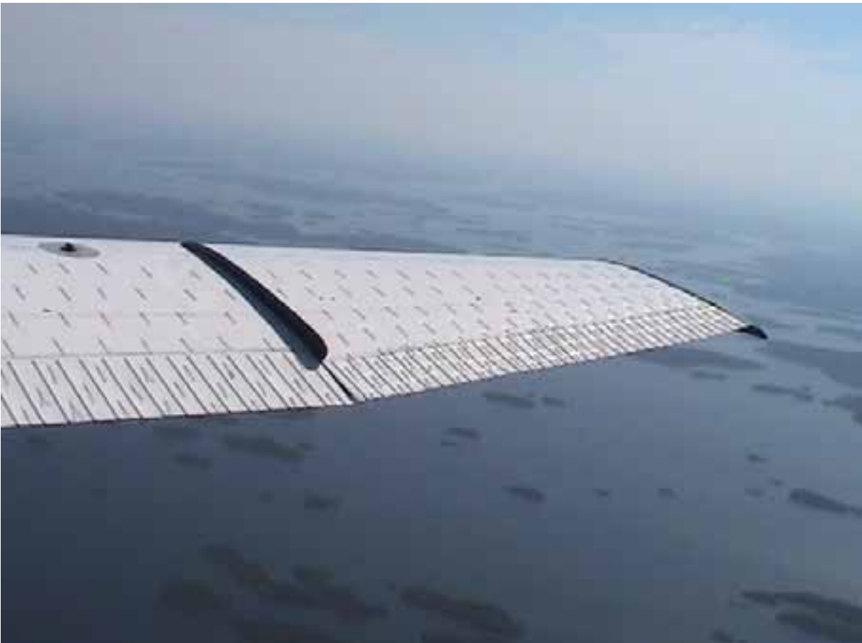
Kuva 7. Oikea siipi laskusiiveke ylhäällä ja kallistussiiveke neutraaliasennossa. Tällöin virtaus on kiinni koko siiven yläpinnalla ja siivekkeissä.
