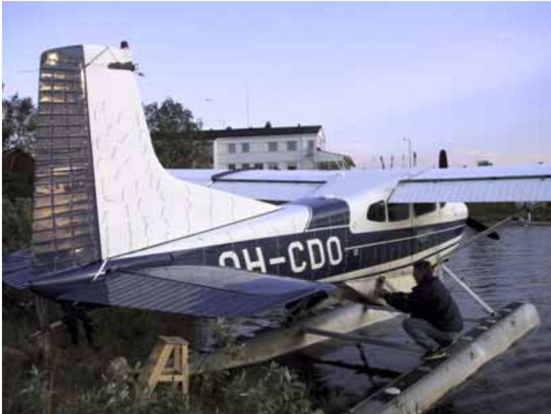
Kuva 3. Lentokoneen runkoon ja oikea siiven yläpinnalle liimattiin virtausindikaattoreiksi villalankoja. Lankojen liikkeitä kuvattiin viidellä videokameralla.
