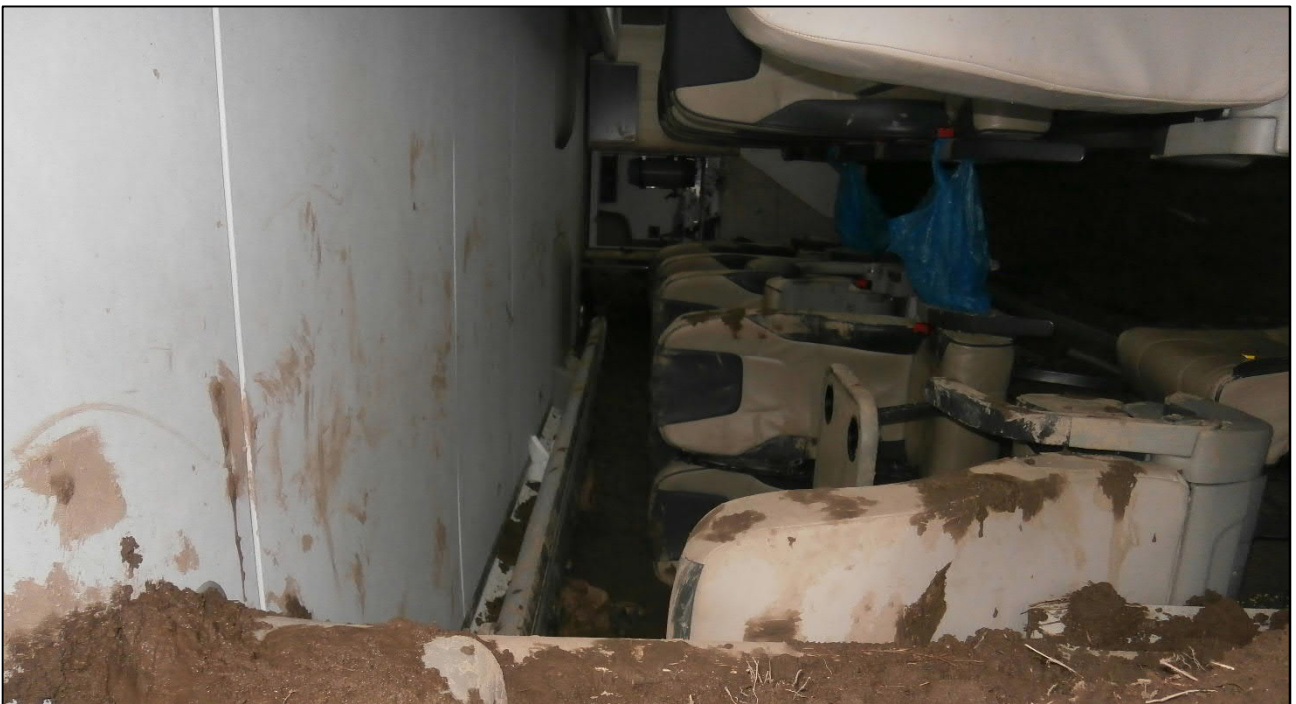
Kuva 3. Erityisesti linja-auton alakertaan tunkeutui pellon multaa. (Kuva: OTKES)
