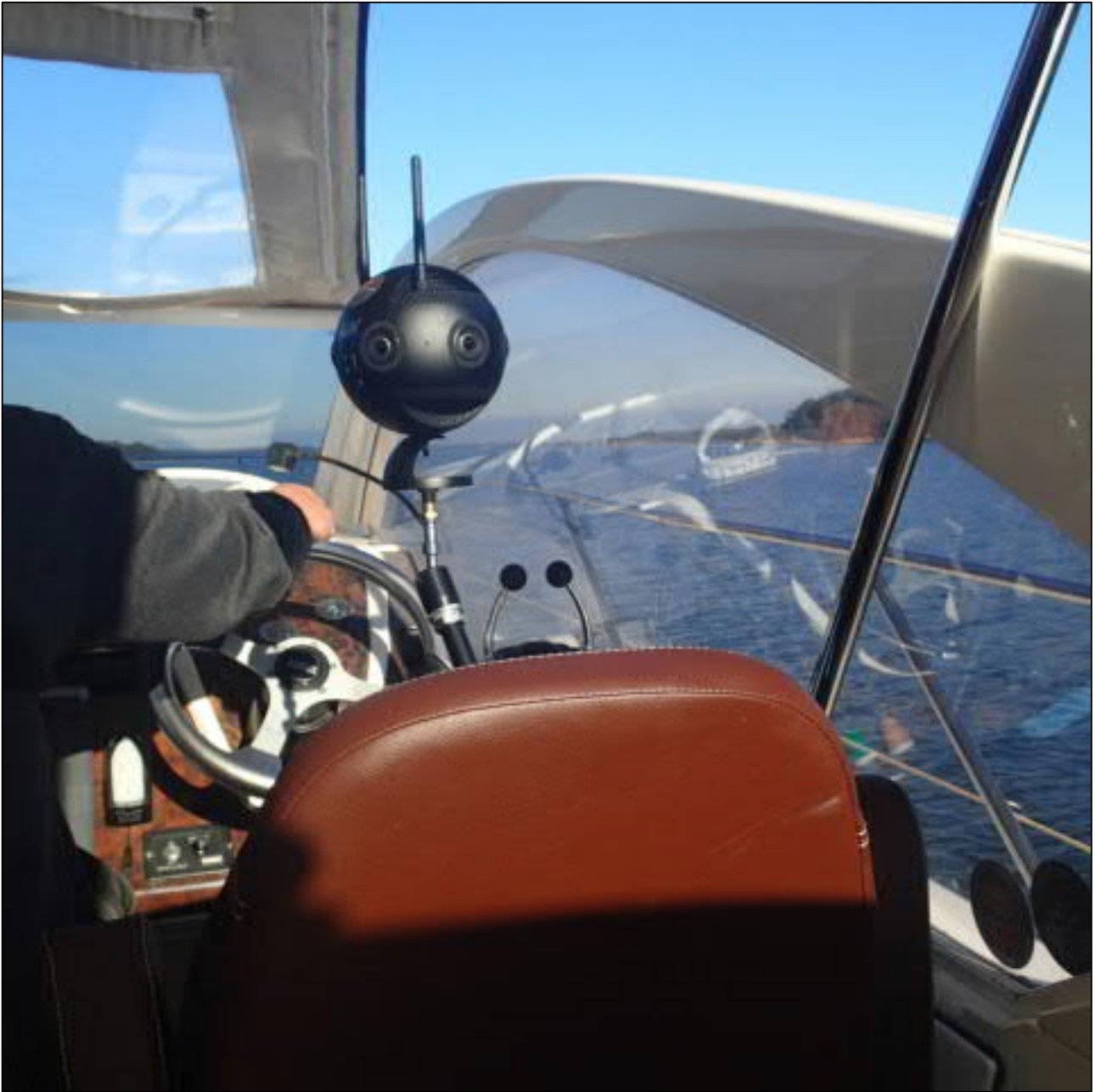
Kuva 8. Rekonstruktiossa käytetty 360 astekamera isomman veneen ohjaamossa ohjaajan paikalla silmien tasolla. Venettä ohjaava henkilö istuu kuvassa matkustajan paikalla rekonstruktion aikana. (Kuva: OTKES)
