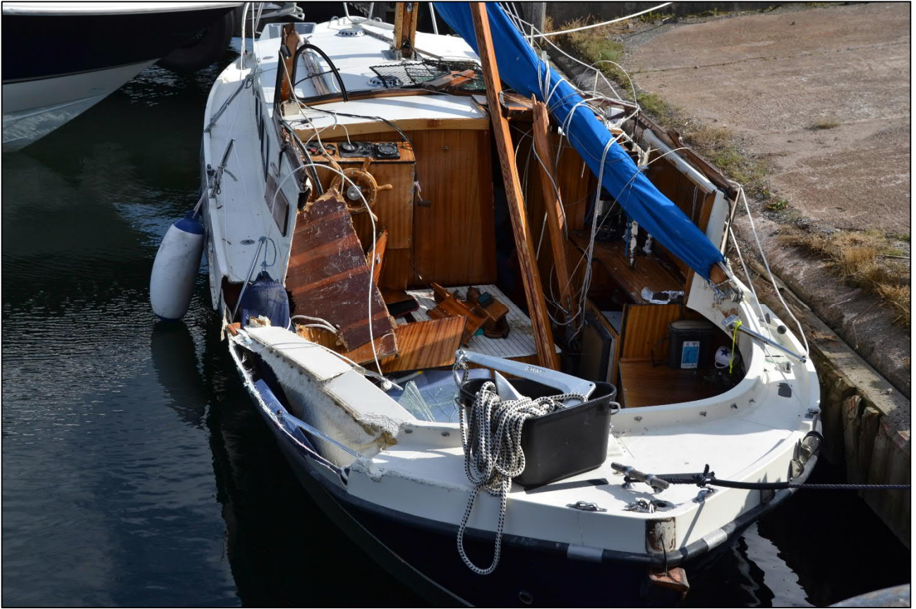
Kuva 3. Pienemmän veneen vaurioita. Törmäys takavasemmalta. Ohjaamon päällä ollut kattorakenne on irronnut eikä ole kuvassa. (Kuva: OTKES)
