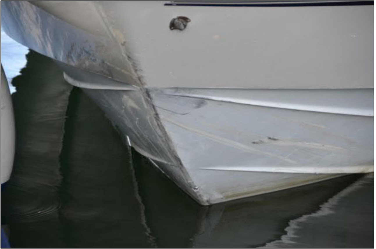
Kuva 4. Isomman veneen vauriot olivat vähäisiä. Vauriot ulottuivat keulasta veneen pohjaan noin kolmen neljäsosan matkalta. (Kuva: OTKES)
