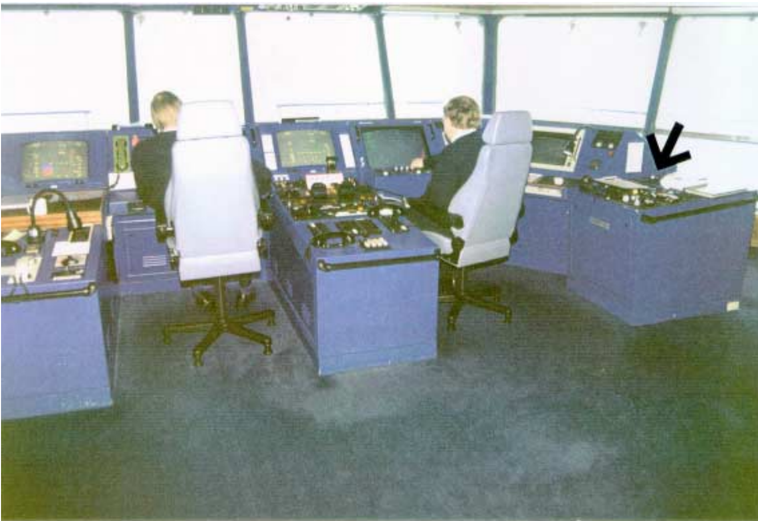
Lähikuva navigointipulpetista. Onnettomuushetkellä vasemmanpuoleisella istuimella istui linjaluotsi ja oikeanpuoleisella istuimella vahtipäällikkö. Nuoli osoittaa BY-PASS-kytkimen paikan.
