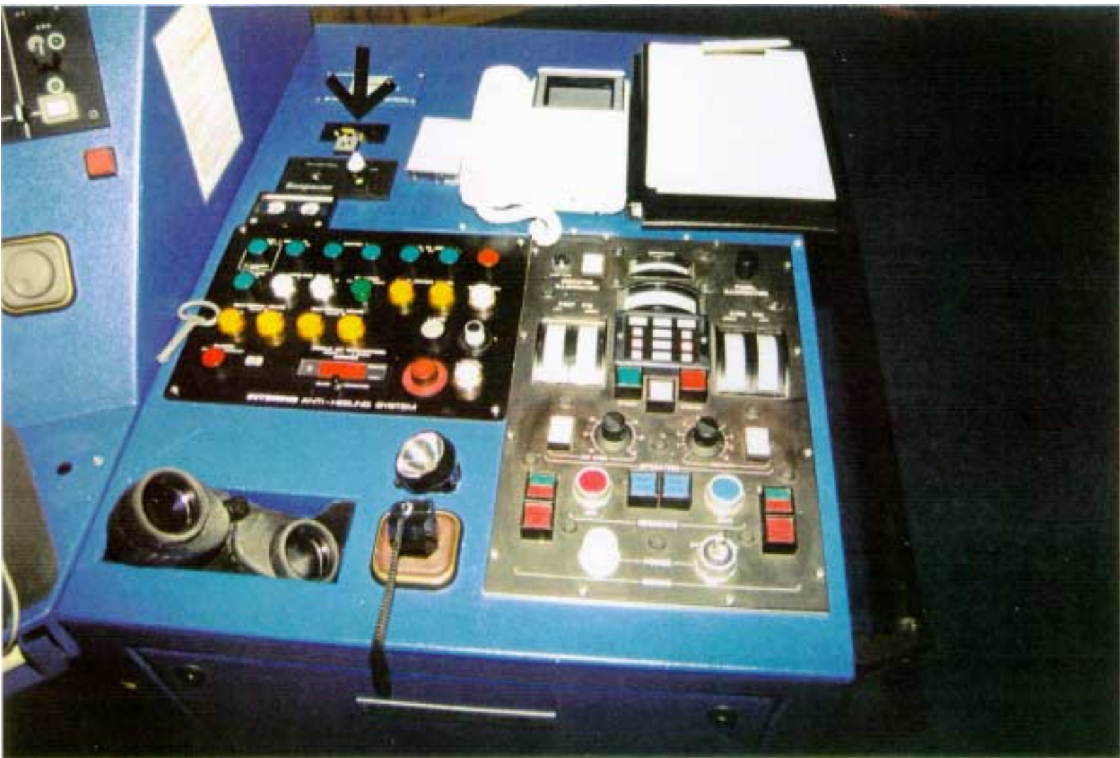
Navigointipulpetin oikeanpuoleinen osa. Nuoli osoittaa BY-PASS-kytkimen paikan.
