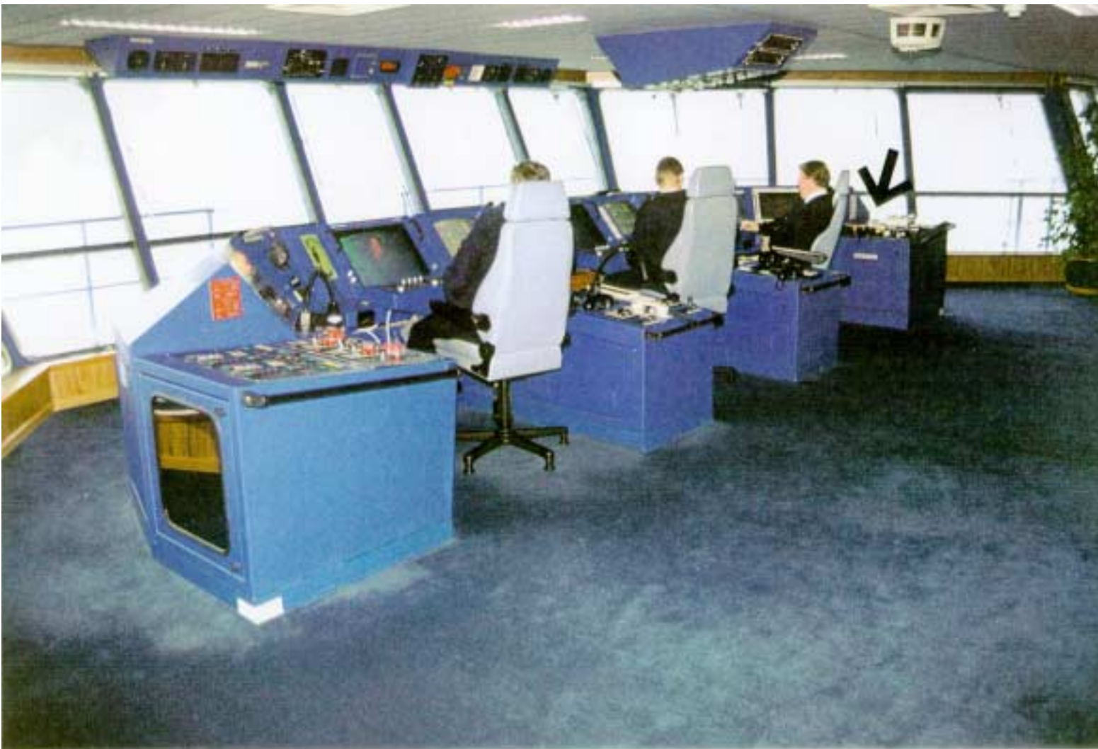
M/S SILJA EUROPAN komentosillan navigointipulpetti. Nuoli osoittaa BY-PASS-kytkimen paikan.
