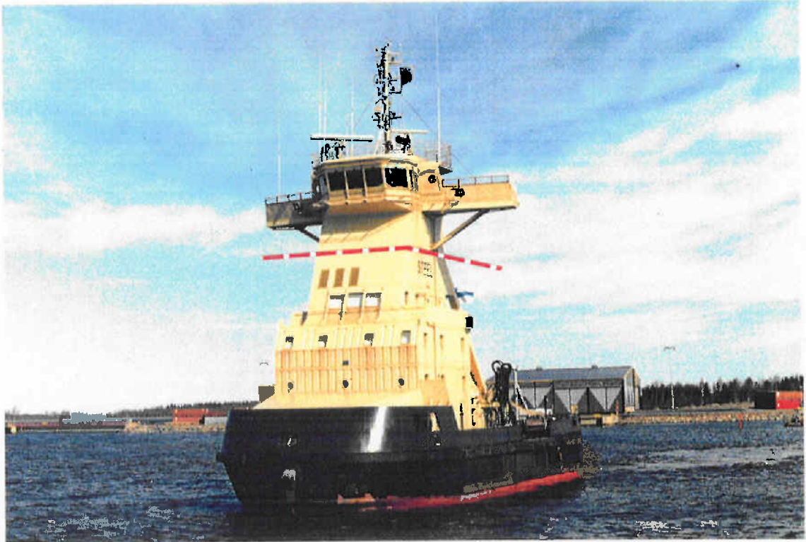
Puskija edestä. Kansirakennuksen katkeamiskohta merkitty kuvaan punaisella katkoviivalla.
