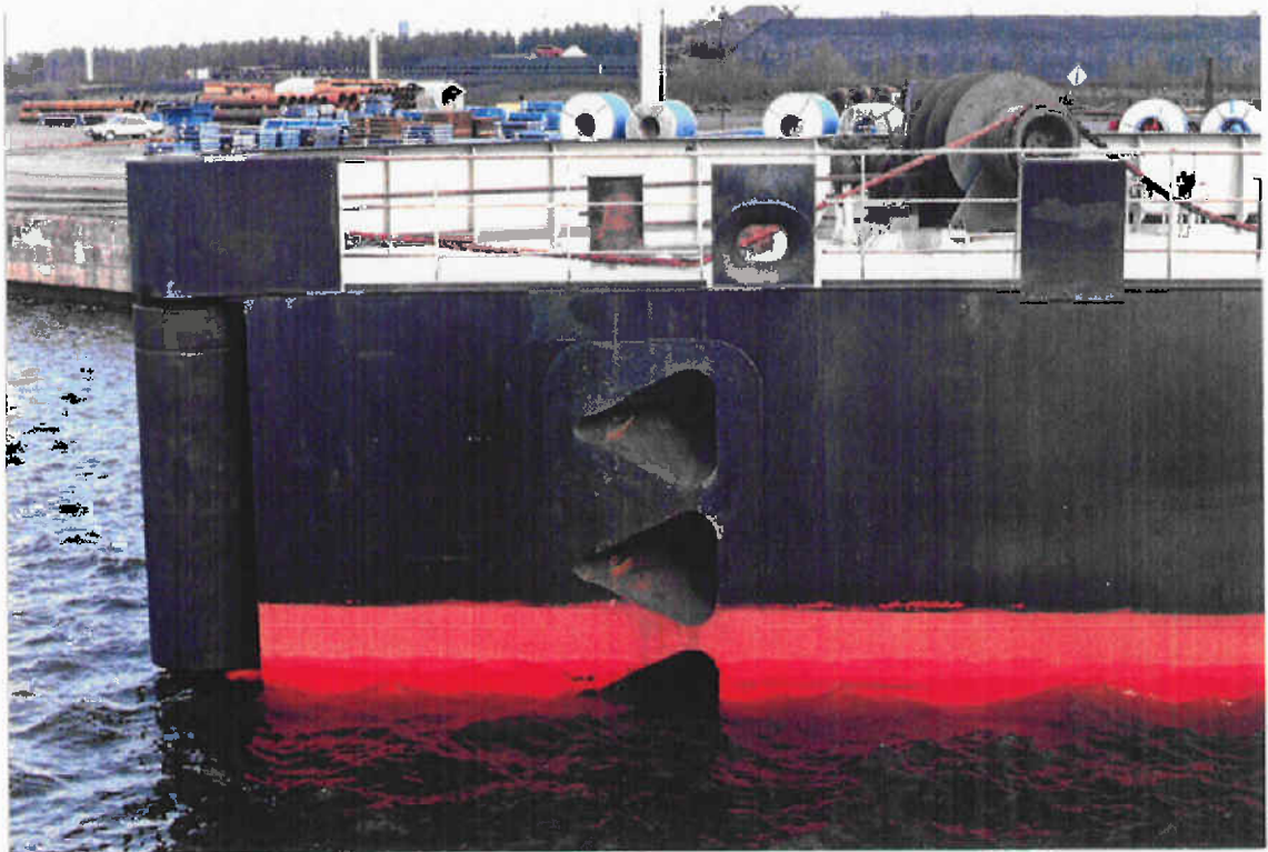
Sivukiinnityksen vastakappaleet proomun vasemmassa siivessä.
