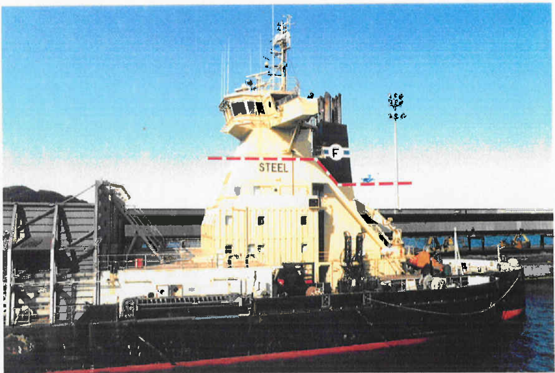
Puskijan vasen sivu. Kansirakennuksen katkeamiskohta merkitty kuvaan punaisella katkoviivalla.
