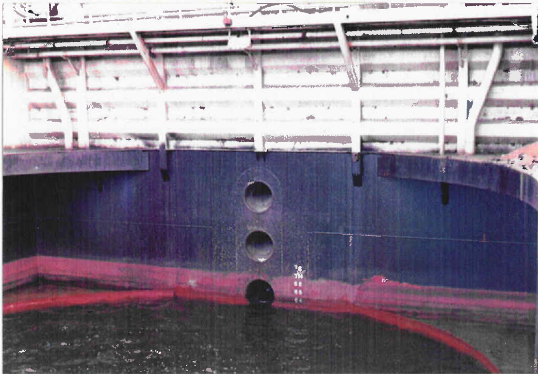
Proomun perähaarukan etuseinässä olevat vastakappaleet, johon puskiijan keulatappi kiinnittyy.
