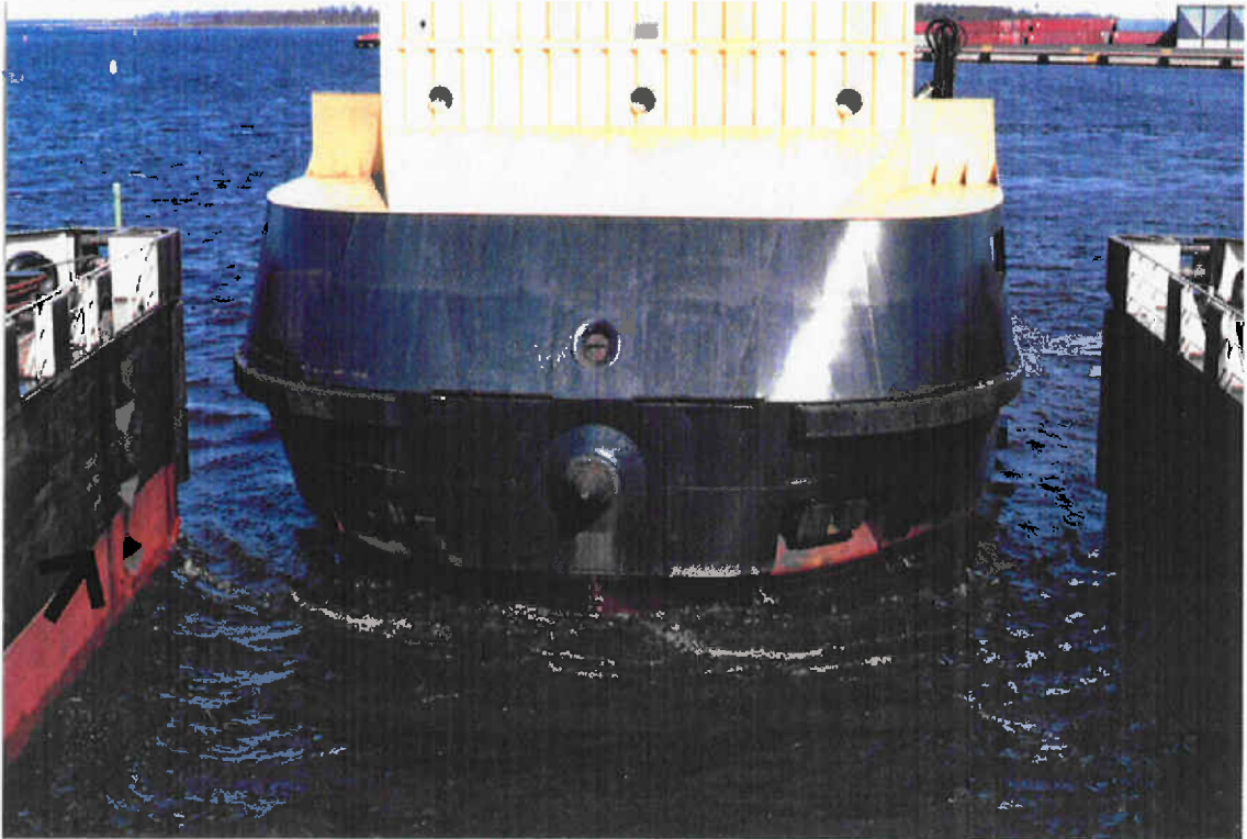
Puskija ajamassa proomun perähaarukkaan. Keskellä puskijan keulassa keulakiinnityksen kartio. Proomun haarukkakiinnityksen vastakappale näkyy proomun siivessä vasemmalla, nuoli kuvassa.
