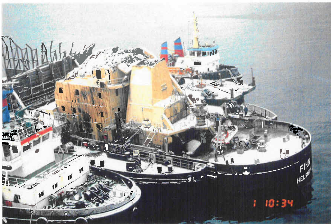
FINNin kansirakennuksen ruhjoutuminen.
