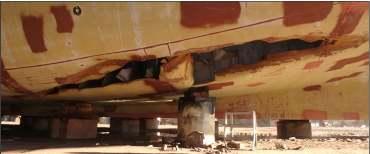
Kuva 10. Aluksen pohjaan karilleajossa aiheutunut repeämä. (Kuva: Teijon telakka)
