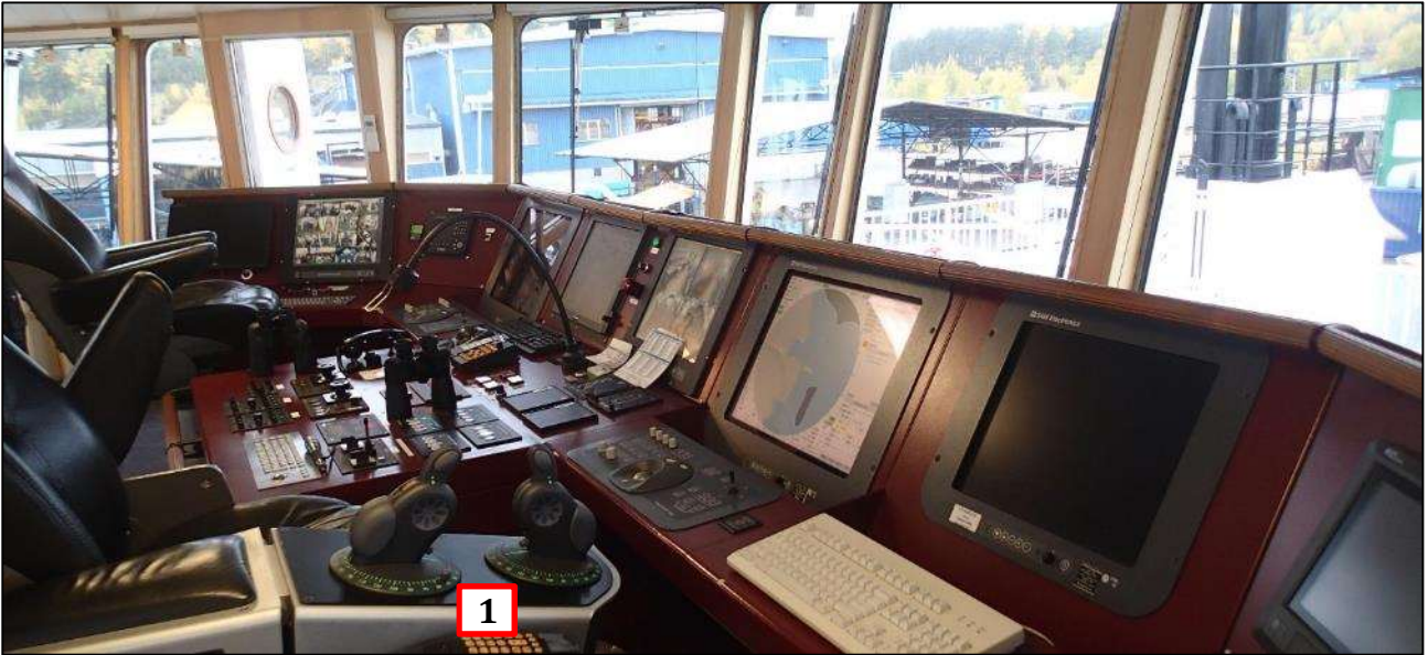
Kuva 16. Komentosillan perän suunnan ohjauspiste. Ruoripotkureiden ohjauskahvat sijaitsevat istuimen oikeassa käsinojassa. (1). Keulan suunnan ohjauspiste on näiltä osin identtinen. (Kuva: OTKES)
