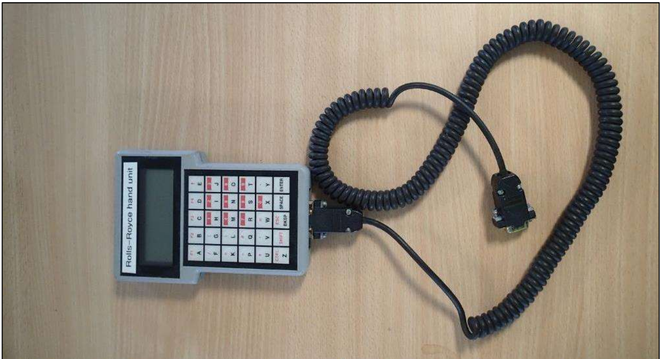
Kuva 27. Ruoripotkureiden ohjausautomaatiojärjestelmän vikojen selvittämiseen käytettävä HHT-huoltopäätte. (Kuva: OTKES)
