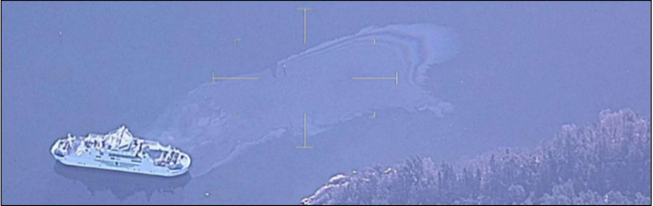
Kuva 9. M/S Skarvenin törmäyslistan alta vuotaneen ruosteenestoöljyn muodostama öljylautta. (Kuva: Rajavartiolaitos)
