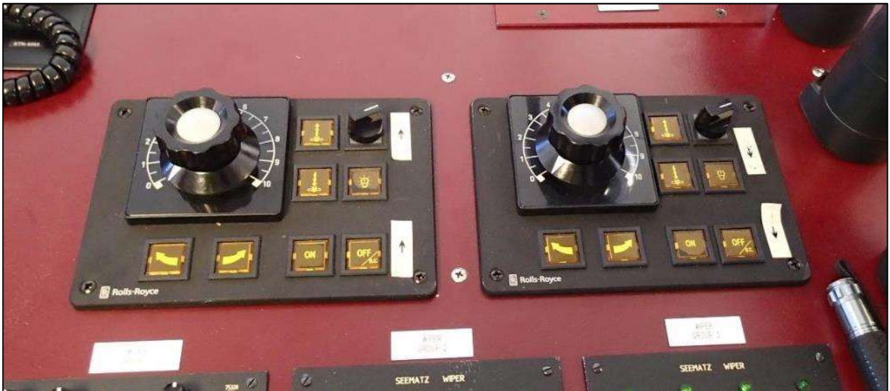
Kuva 21. Komentosillan perän suunnan ohjauspisteen varaohjauspaneelit. (Kuva: OTKES)
