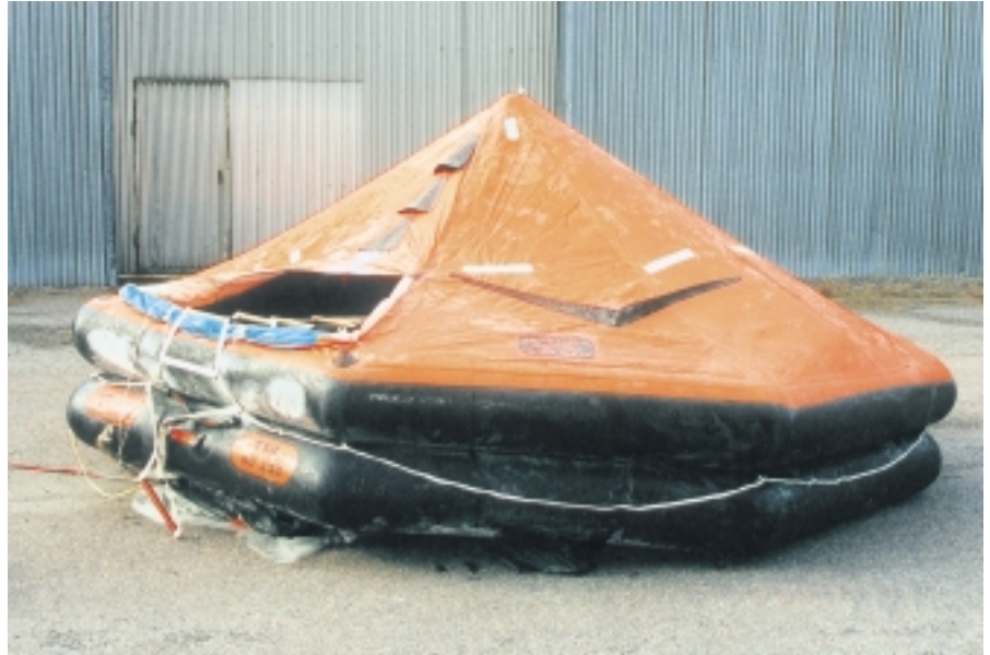
Kuva 17.7 ESTONIAN Viking 25-K-tyyppinen pelastuslautta.
