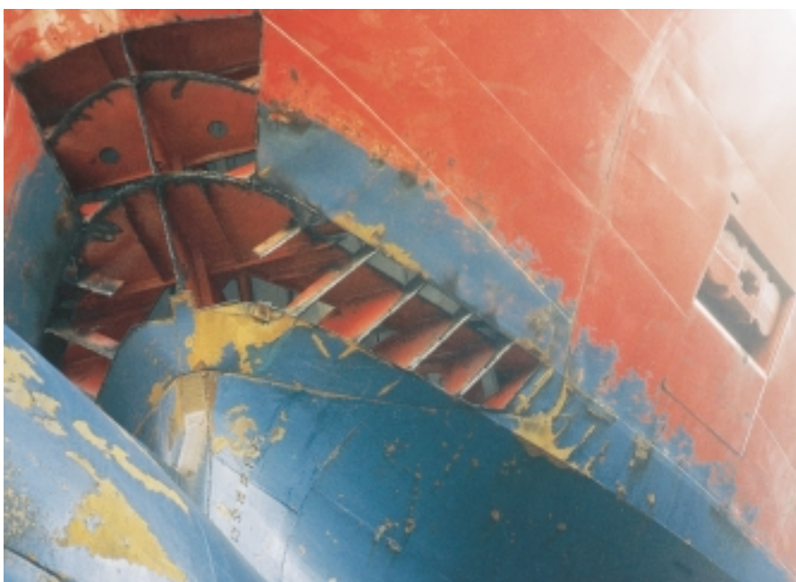
Kuva 3.12 Jäävaurioiden laajuus vuoden 1987 korjausten yhteydessä.
