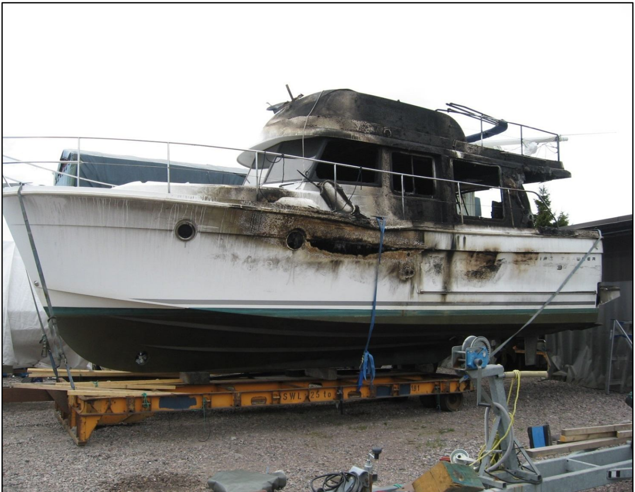
Kuva 2. Palanut vene nostettuna tutkintaa varten, veneen runko on palanut puhki vasemman puolen hytin kohdalla. (Kuva: OTKES)
