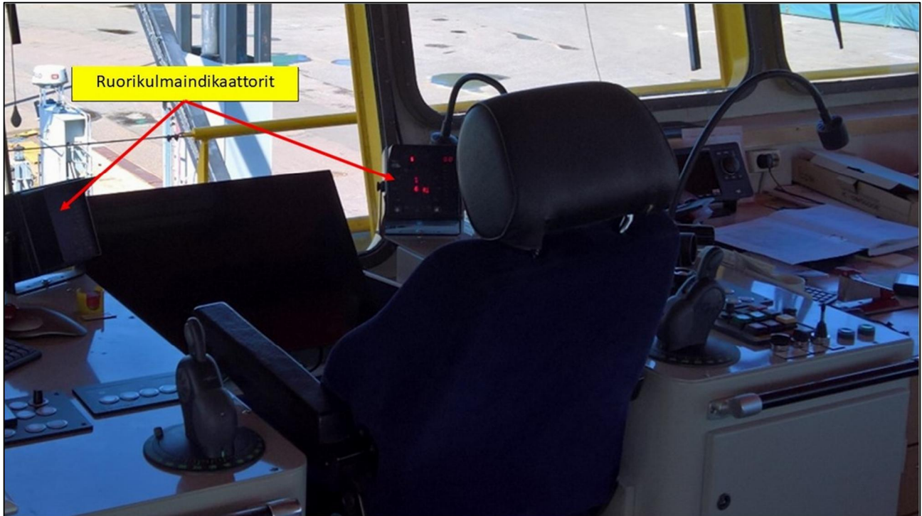
Kuva 7. Ruorikulmaindikaattorien sijainti ohjauspulpetissa (Kuva: OTKES)
