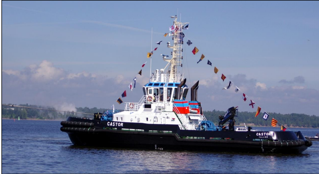
Kuva 7. Hinaaja Castor. Castorin pituus on 34,5 m, leveys 12,10 m, syväys 4,5 m ja paaluveto SBP 65 tonnia. (Kuva: Alfons Håkans AS)
