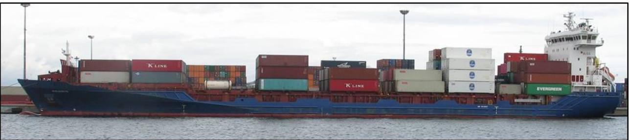
Kuva 3. MV Priamos 15.9. Lastitilanne sama kuin onnettomuudessa. Aluksen ja lastin tuulipinta-ala oli noin 2100 m 2 . (Kuva: OTKES)
