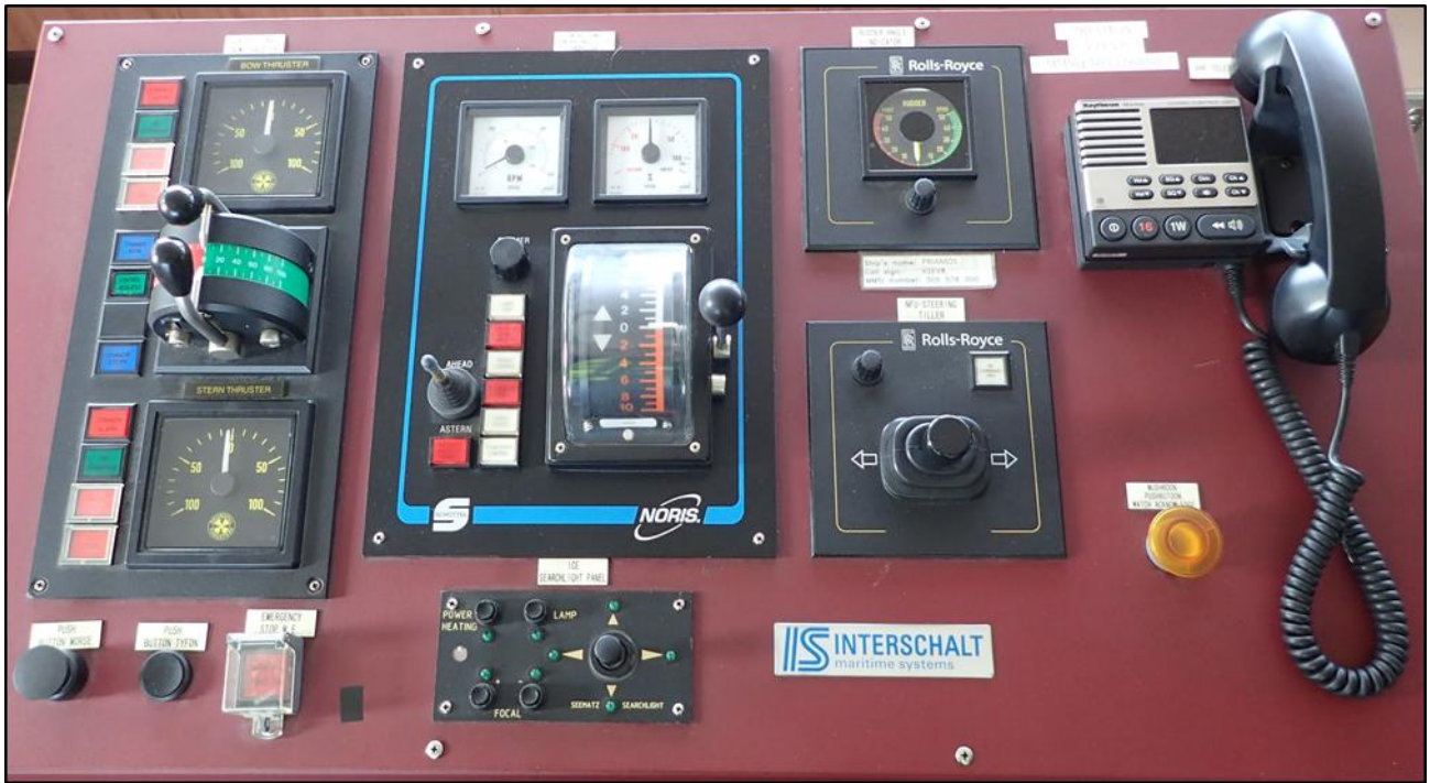
Kuva 13. Lähikuva vasemman siiven ohjauspaikan pulpetista, josta luotsi ohjaili alusta. Vasemmalla alhaalla perän ohjailupotkurin näyttö ja ohjausvipu, ylhäällä vastaavasti keulapotkurin vipu ja näyttö. Keskellä pääkoneen ja potkurin ohjausvivut sekä niiden yläpuolella vasemmalla kierrosluvun (pääkone ja potkuri) ja oikealla potkurin nousun näytöt. Oikealla peräsimen ohjaus ja näyttö sekä puhelin. (Kuva: OTKES)
