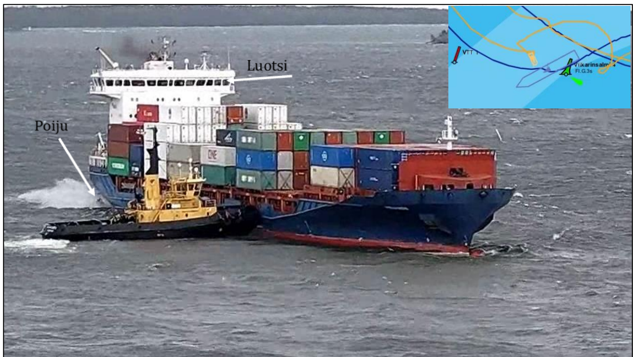
Kuva 23. MV Priamos osuneena poijuun kello 18.42.36. (Kuvakaappaus videolta: HaminaKotka satama). Pikkukuvassa Viikari on irtoamassa MV Priamoksen kyljeltä kello 18.44.12. (Kuvakaappaus videolta: Finnpiilot AISLap)
