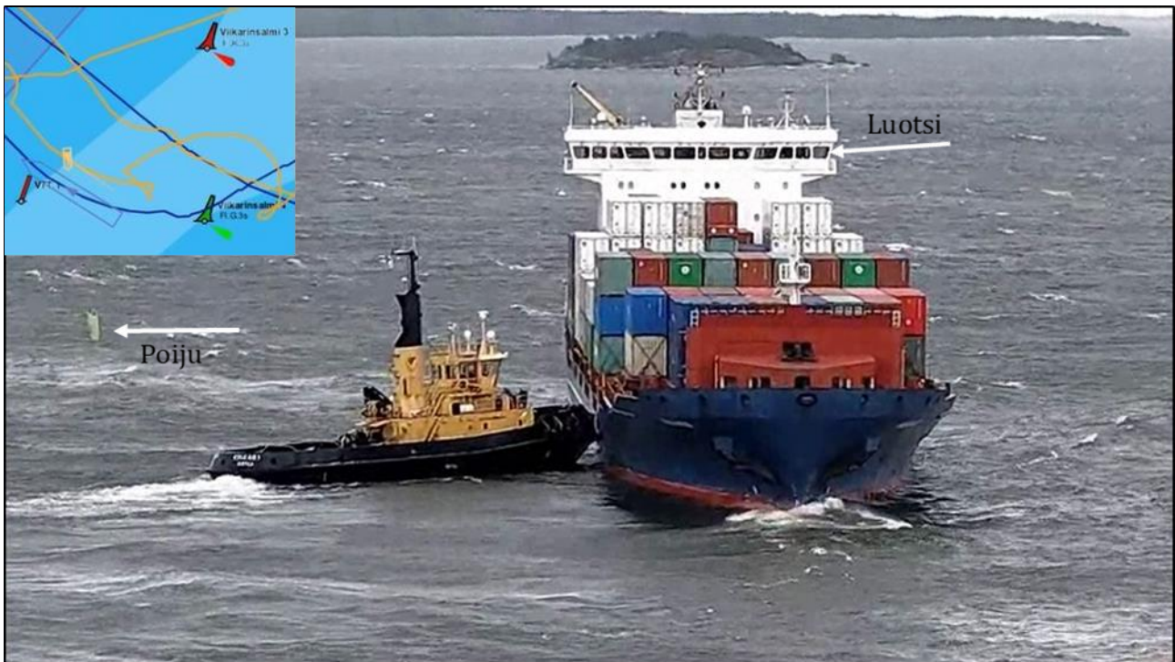
Kuva 22. Hinaaja Viikari puskemassa MV Priamosta kello 18.41. (Kuvakaappaus videolta: Hamina-Kotka satama). Pikkukuvassa näkyy Viikarin asento. Etäisyys aluksen perästä poijuun on 100 m. (Kuvakaappaus videolta: Finnpiilot AISLap)
