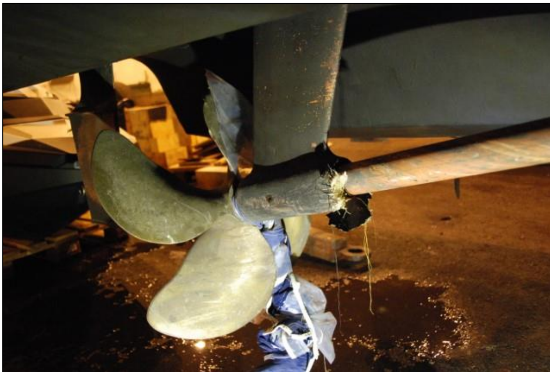
Bild 5. En del av den mindre båtens kapell fastnade i den större båtens propeller. (Bild: Gränsbevakningsväsendet)
