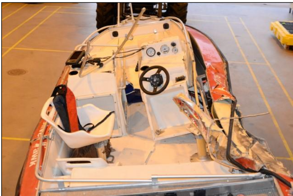
Bild 9. Skadorna på den mindre båten. (Bild: Gränsbevakningsväsendet)
