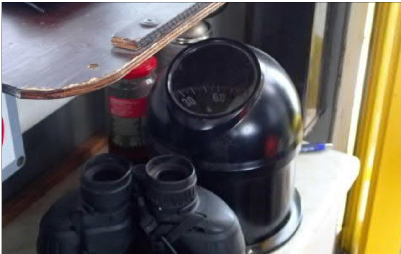
Kuva 15. Kompassi sijaitsee osittain karttapöydän reunan alla. (Kuva: Onnettomuustutkintakeskus)
