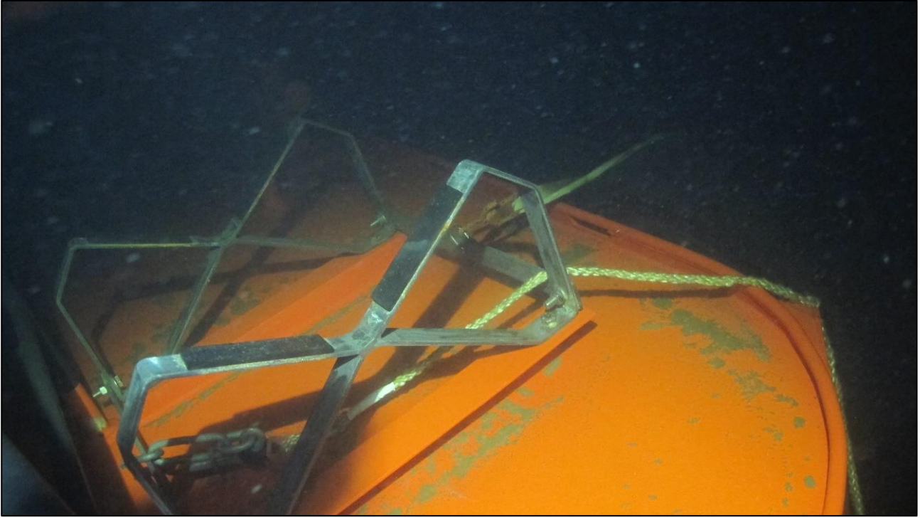
Kuva 7. Luotsiveneen L-242:n pelastuslautan tyhjä teline. (Kuva: OTKES)
