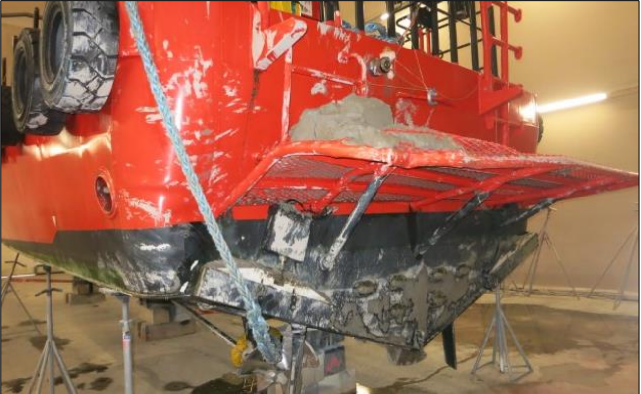
Kuva 12. Pohjan tarkastelussa havaittiin luotsiveneen perässä olevan tason vääntyneen vasemmasta reunastaan. Peräsimet olivat hyväkuntoiset ja kääntyneenä jyrkästi vasemmalle noin 40 asteen kulmaan. (Kuva: OTKES)
