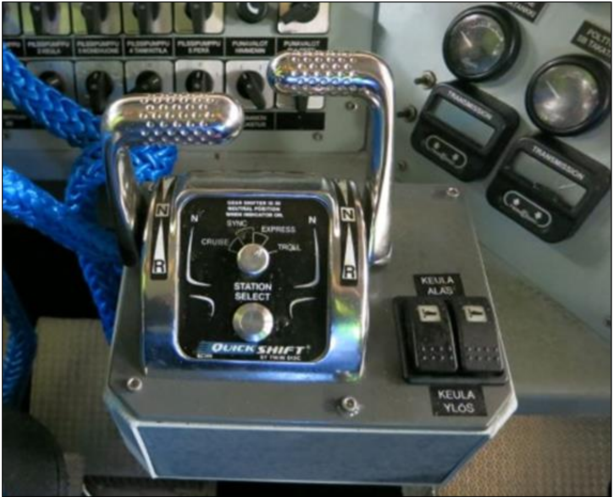
Kuva 15. Ohjauskahvojen asennoista vasemman puoleisen moottorin kytkin oli nolla-asennossa ja oikeanpuoleinen osoitti noin 20 % tehoa eteenpäin. (Kuva: OTKES)
