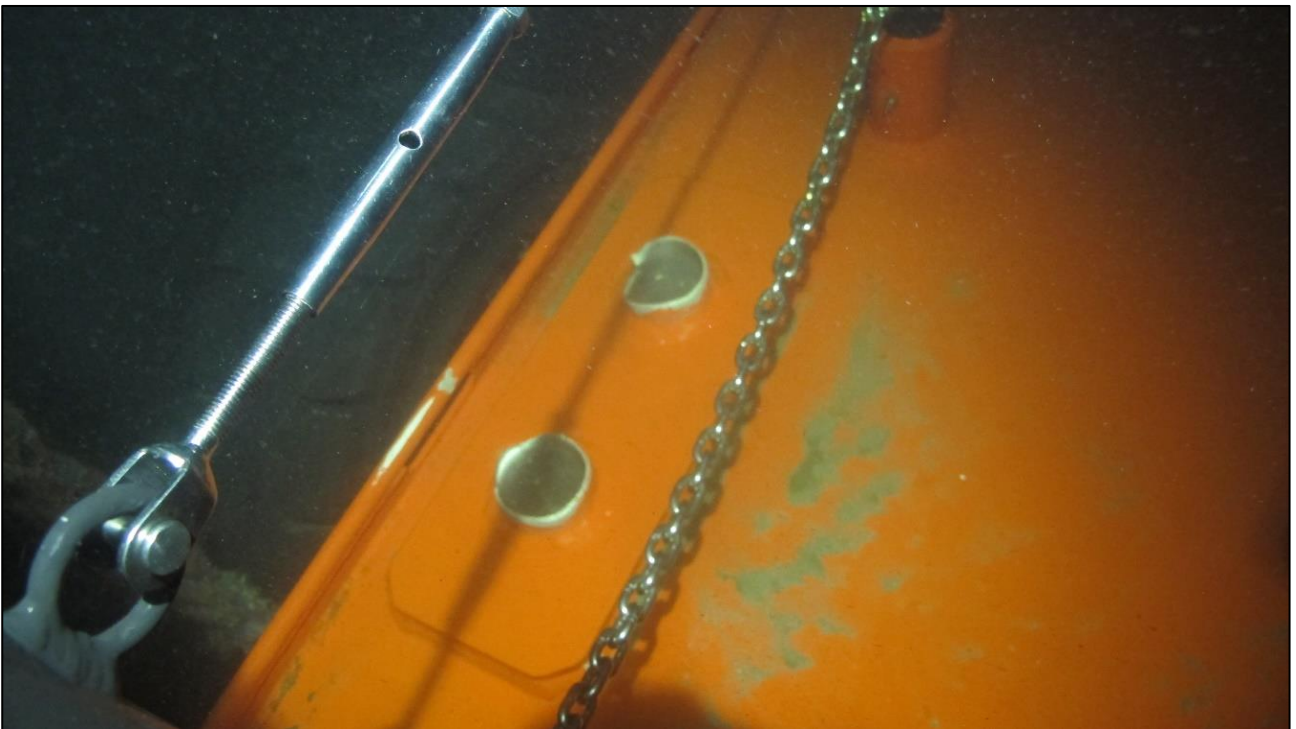
Kuva 6. Luotsiveneen L-242:n repeytynyt vasen peräpollari. (Kuva: OTKES)
