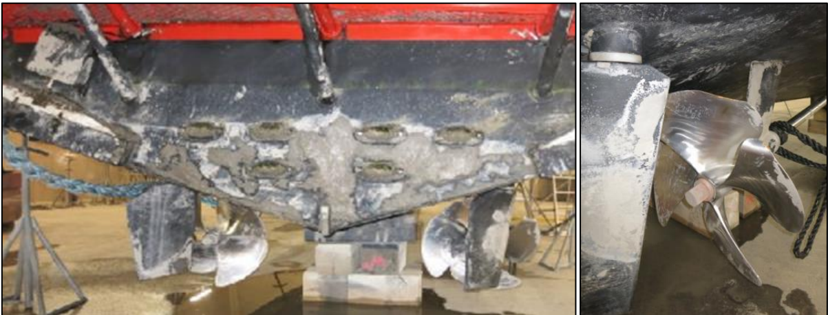
Kuva 13. Peräsimet olivat ääriasennossa vasemmalla. Oikeanpuolen potkurin kahden lavan päässä oli pieni taipuma. Trimmitasot olivat lokeroissaan. (Kuva: OTKES)
