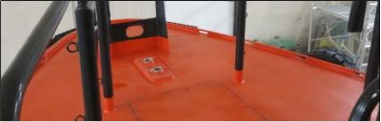
Kuva 14. Keulan kiinnityspollari oli repeytynyt irti. Repeytymiskohdasta oli kaksi 50 mm yhteyttä aluksen suljettuun keulatilaan. (Kuva: OTKES)
