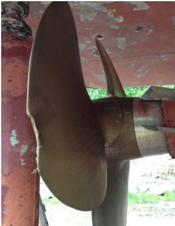
Kuva 8. Lavasta 1 on irronnut suurempi palanen sen osuessaan karikkoon. (Kuva: Otkes)
