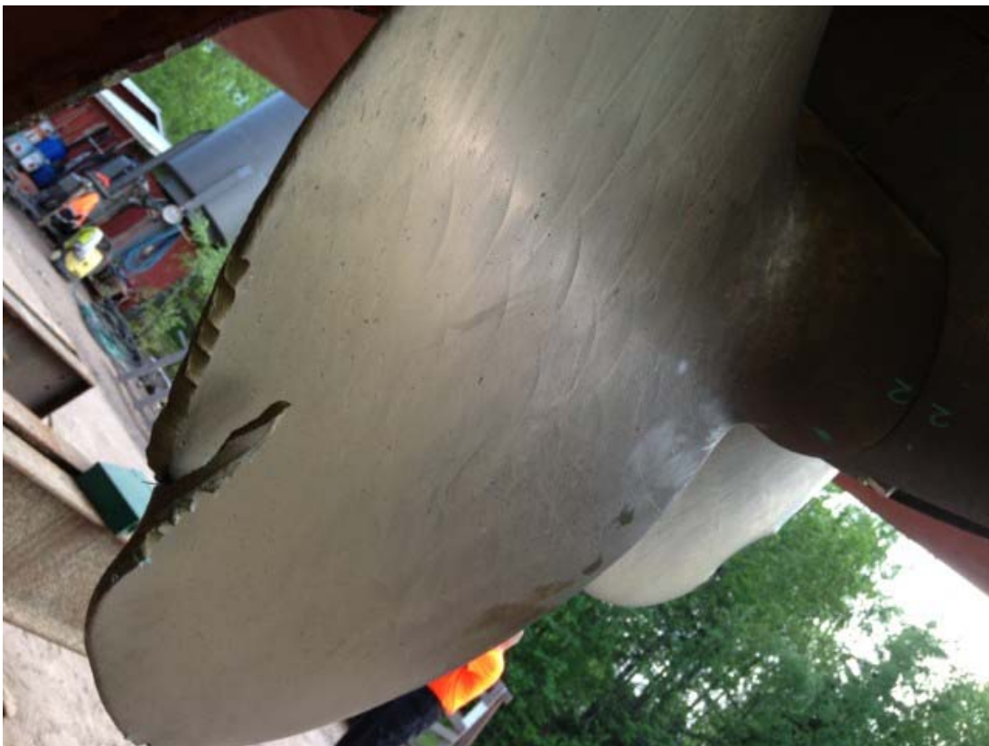
Kuva 7. Halkeama lavassa 2 oli noin 30 mm. (Kuva: Otkes)
