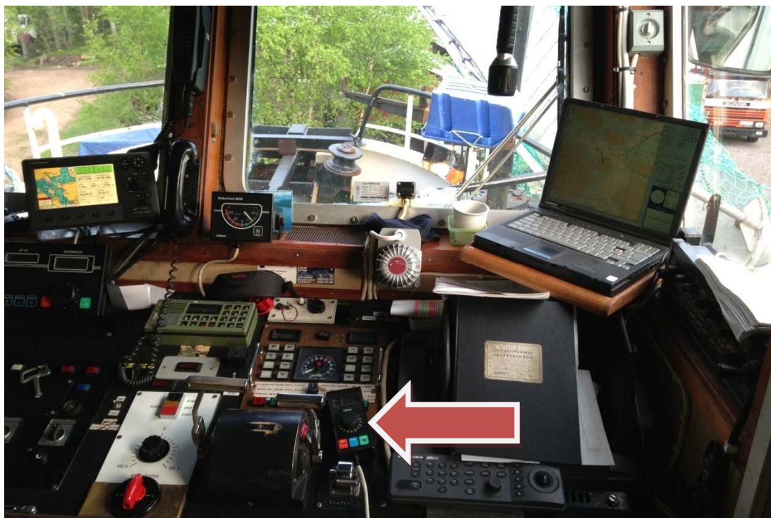
Kuva 11. Ohjauspulpetin oikea puoli. Nuolella merkitty automaattiohjauksen kaukosäädin. (Kuva: Otkes)
