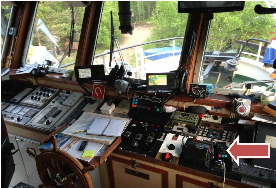
Kuva 2. Ohjauskonsoli, nuolella merkitty automaattiohjauksen kaukosäädin. (Kuva: Ot-kes)
