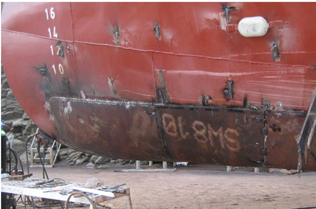
Kuva 12. Vasemman puolen repeämän kylkilevyjä uusittavana. (Kuva: OTKES)
