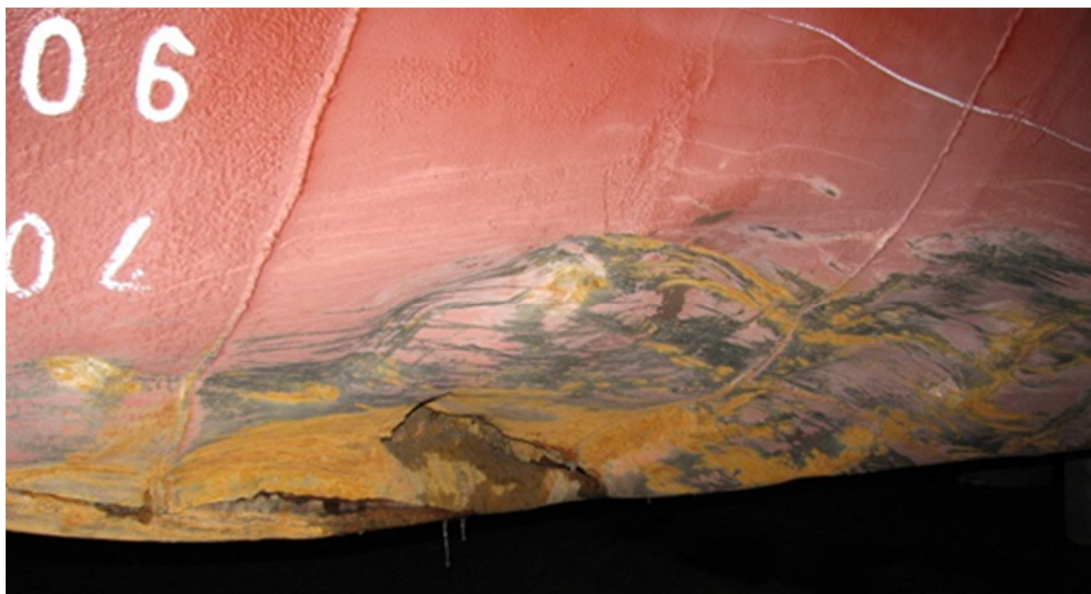
Kuva 9. Kuva telakoinnissa. Repeämä aluksen pohjassa keulan vasemmalla puolella. (Kuva: OTKES)
