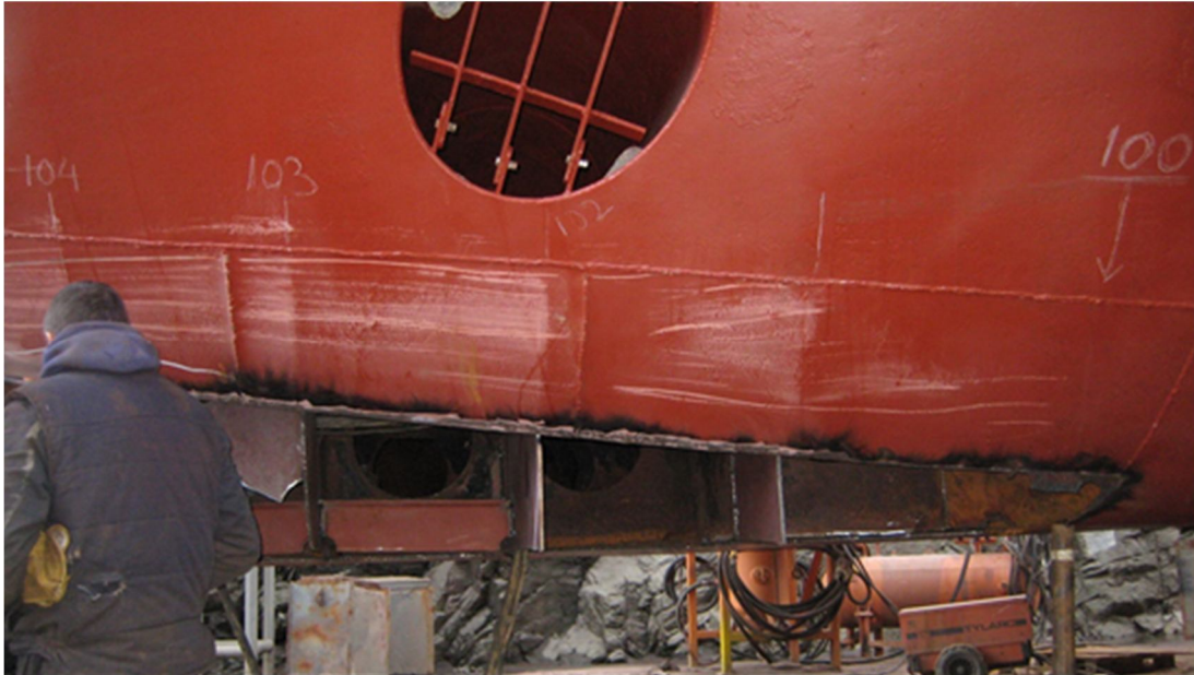
Kuva 11. Kuva telakoinnissa. Vasemman puolen repeämä avattuna, kaaret vahvistettu. (Kuva: OTKES)
