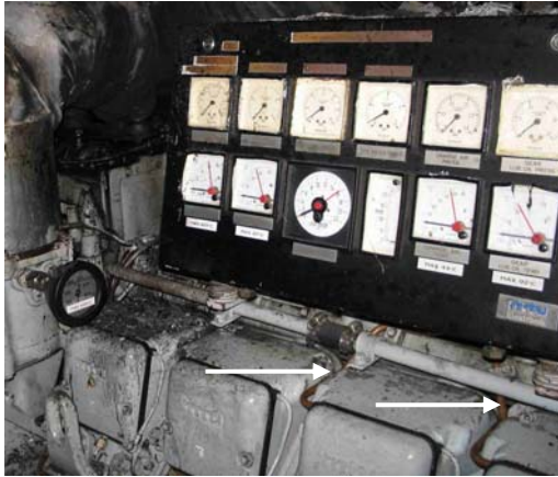
Kuva 15. Kuvissa on nähtävissä myös kuparinvärisiä ja likaantuneita polttoaineen ruiskutusputkia, joista muutamia on näytetty nuolilla.
