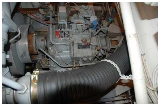
Kuva 4b. Vasemmassa kuvassa pääkoneen alennusvaihte ja toinen, SB puolen ahkimelle menevä ilmanottoletku. Molemmat letkut korvattiin tulipalon jälkeen suodattimella. Kuvassa oikealla apukone. Kuvat ovat aluksen huutokauppaesittelystä internetissä syksyllä 2009.
