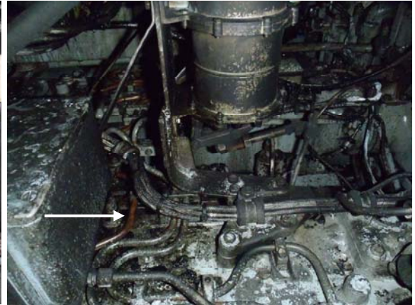
Kuva 15. Kuvissa on nähtävissä myös kuparinvärisiä ja likaantuneita polttoaineen ruiskutusputkia, joista muutamia on näytetty nuolilla.
