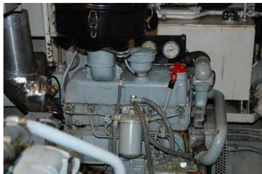
Kuva 4b. Vasemmassa kuvassa pääkoneen alennusvaihte ja toinen, SB puolen ahkimelle menevä ilmanottoletku. Molemmat letkut korvattiin tulipalon jälkeen suodattimella. Kuvassa oikealla apukone. Kuvat ovat aluksen huutokauppaesittelystä internetissä syksyllä 2009.
