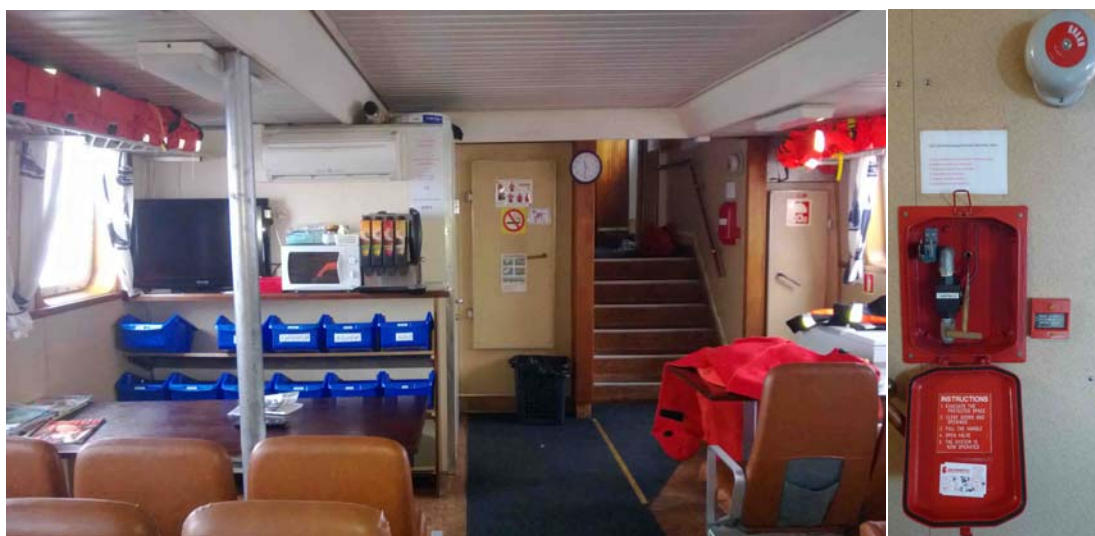
Kuva 5. Matkustamo. Oikealla on ovi komeroon, jossa ovat CO 2 -pullot. Ohjaamoon vievän portaikon oikealla seinällä on CO 2 -laukaisu, suurennos kuvassa oikealla. (Laukaisuohjeet ovat avatun luukun sisäpuolella englanniksi ja yläpuolella suomeksi). Matkustamon kuva Rauma Survey.
