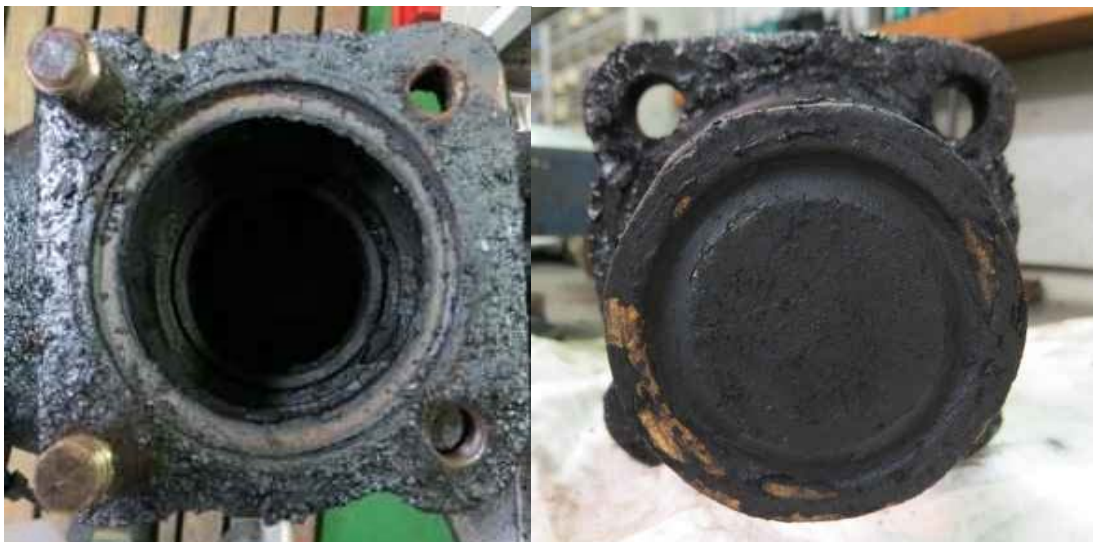
Kuva 31c. Venttiilin, josta kara oli katkennut, pesä (vasemmalla) ja venttiililautanen (oikealla).
