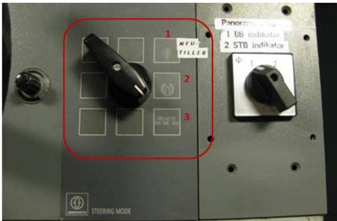
Kuva 4a. Ohjauspaikan valintakytkin ruoripylväässä. Numerointiselvitys tekstissä.
