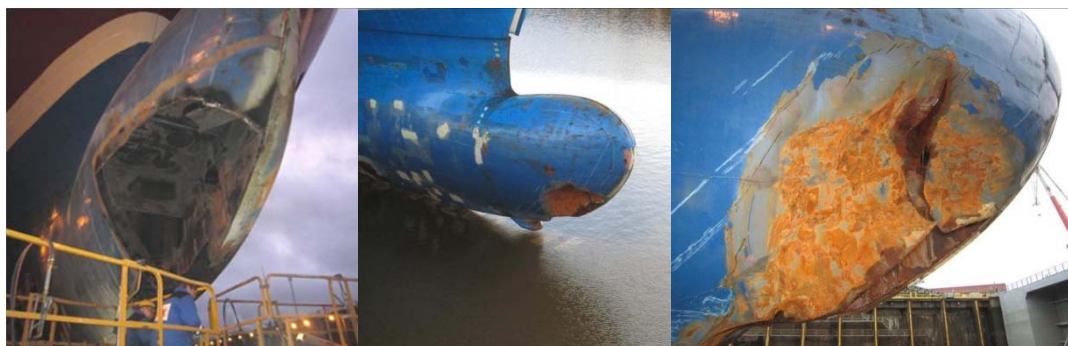
Kuva 21. Keulabulbin vaurioita ja bulbi avattuna (oikealla). Kuvat: DNV GL.
