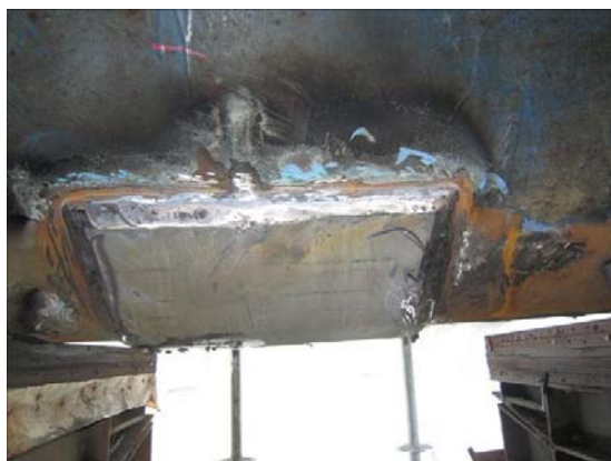
Kuva 30. Vasemmalla tilapäiskorjaus päällystyslevyllä aluksen kolin kohdalla ja oikealla keulabulbin uutta levytystä. Kuvat: Luokituslaitos DNV GL.
