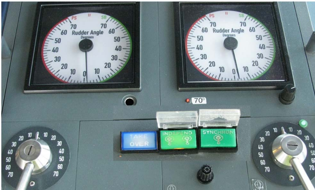
Kuva 4b. Siipikonsolin ohjauspaikan valintapaneeli ja ruorikulmaosoittimet. Vihreät painikkeet ovat peräsimien käyttövalinnalle: vasen, ohjaus toisistaan riippumaton ja oikea, synkronoitu kääntymään yhdessä.
