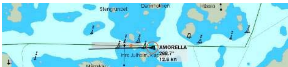
Kuva 25a. Noin 1,5 minuuttia arvioidun sähköhäiriön alun ja potkurien pysähtymisen jälkeen, kello 12:34:22, alus oli kääntymässä vasemmalle väylän imuvaikutuksen johdosta. Hieman tätä ennen linjaluotsi kytki hätäohjausjärjestelmän ja käänsi peräsimet oikealle. Nopeus oli 12,6 solmua.
