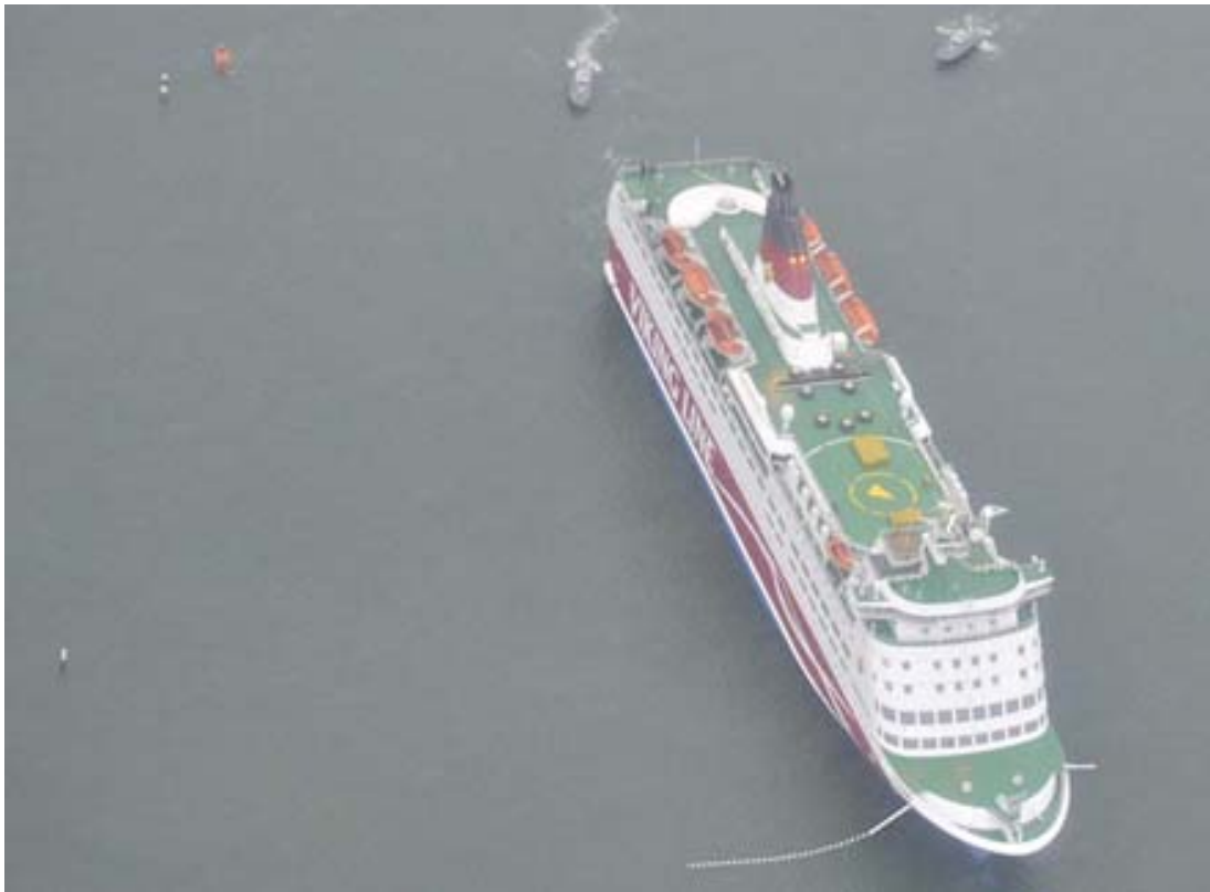
Kuva 20. AMORELLA karilla ja SB-ankkuri vedessä. Aluksen perässä näkyy potkurivirtaa. Alusta estettiin liukumasta pois karilta käyttämällä SB-potkuria. Ankkurikettinki näkyy kuvassa korostettuna. Kuva: RVL.
