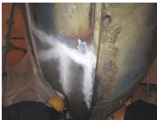
Kuva 30. Vasemmalla tilapäiskorjaus päällystyslevyllä aluksen kolin kohdalla ja oikealla keulabulbin uutta levytystä. Kuvat: Luokituslaitos DNV GL.
