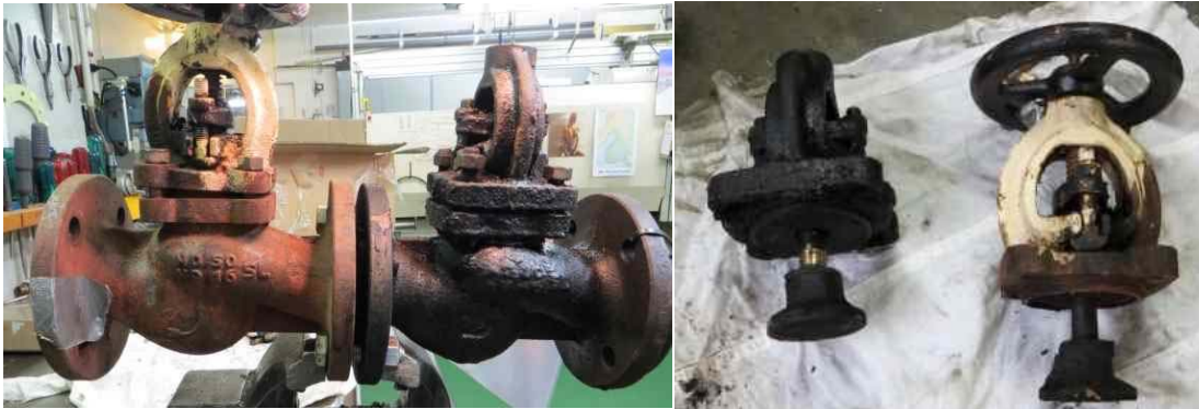
Kuva 31a. Vasemmalla venttiilit sivusta, oikealla karat ja venttiililautaset, toinen poikki.
