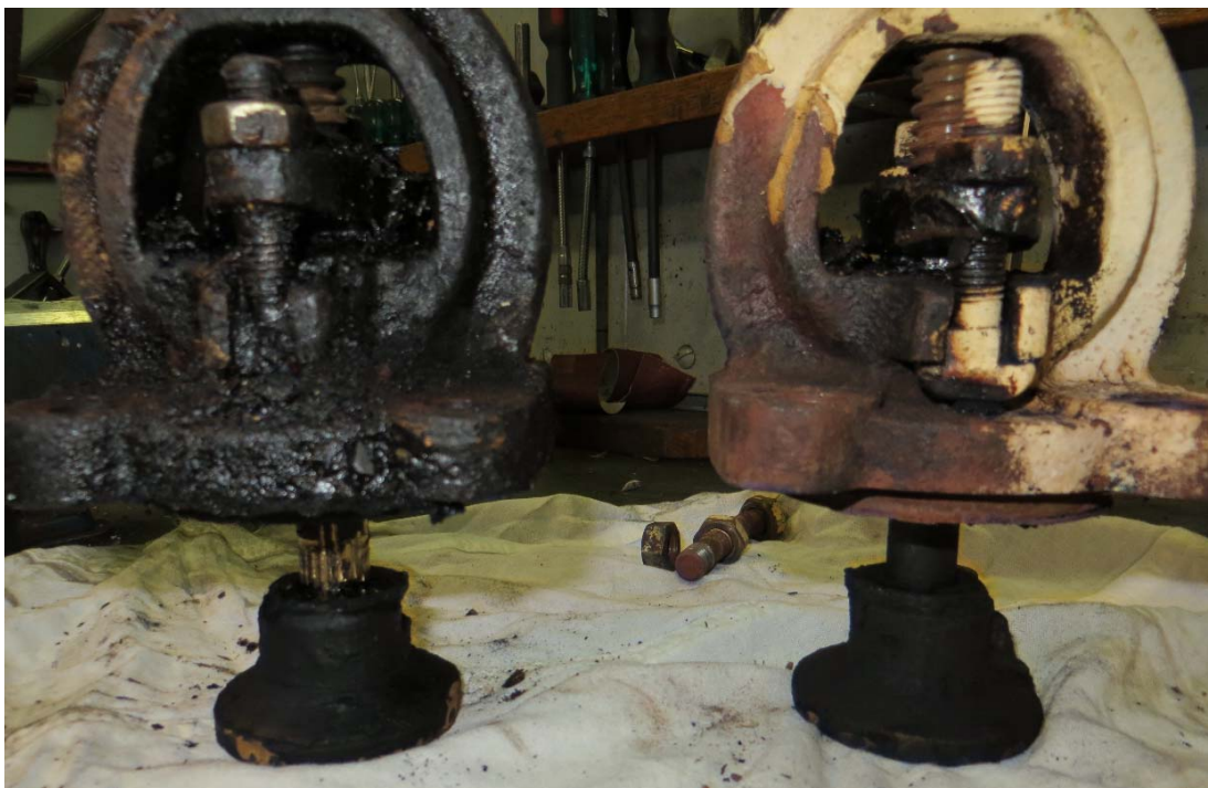
Kuva 31b. Vasemmalla venttiili, jonka kara oli poikki. Venttiililautasen varressa näkyy tartuntauria, jotka ovat syntyneet, kun venttiili avattiin työkalulla. Ensi yrityksellä kara oli mennyt poikki.
