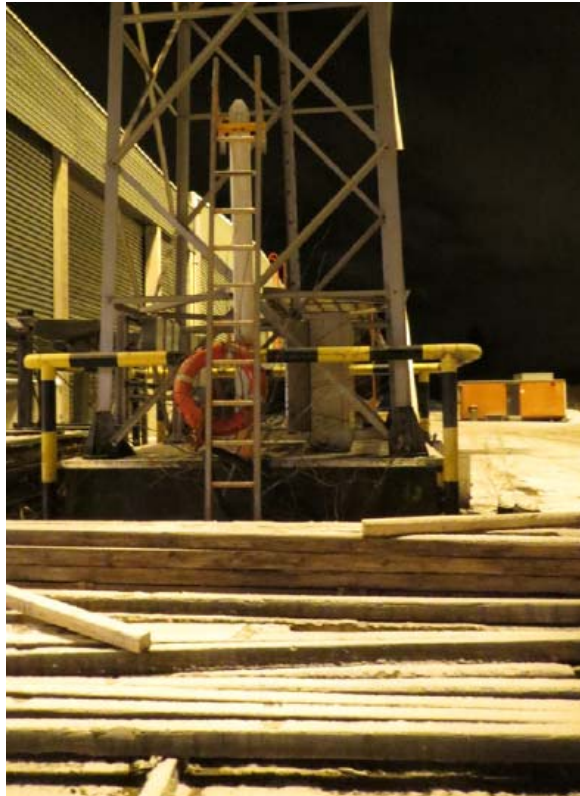
Kuva 12. Onnettomuuspaikkaa lähinnä olleet tikkaat ja pelastusrenkas kuvattuna onnettomuusiltana 26.11.2013. Satamien työturvallisuutta koskeva asetus (633/2004) vaatii näiden lisäksi pyöreäkärkisen varrellisen haan. (kuva: Stora Enson tehdaspalokunta)
