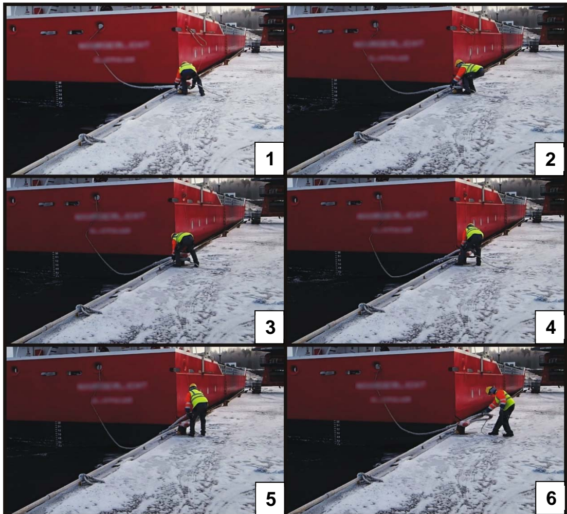
Kuva 8. Kuvasarja köysimiehen toiminnasta onnettomuusalueella vastaavan kokoisen aluksen irrottamisesta Vuoksen sataman laituripaikan 2 kohdalta talviolosuhteissa. Kuvassa toimivalla alihankkijalta tilatulla köysimiehellä ei ole pelastusliivejä. Kuvattu 14.1.2014. (Kuvat: Otkes)
