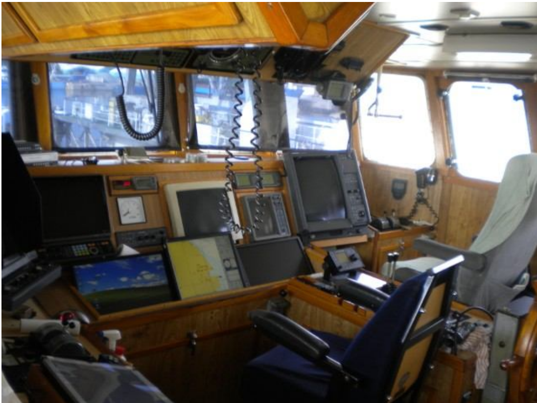
Kuva 2. Aluksen ohjaamo, jossa ohjailupaikalla edessä kaksi elektronista merikarttanäyttöä ja tutkanäytöt. Koneen hallintakahvat ovat istuinten välissä. Näkyvä ulos ohjailupaikalta on rajoittunut.
