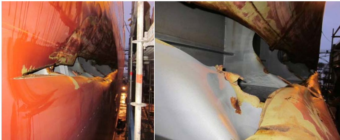
Kuva 10. Vauriot vasemmalla kyljellä.
