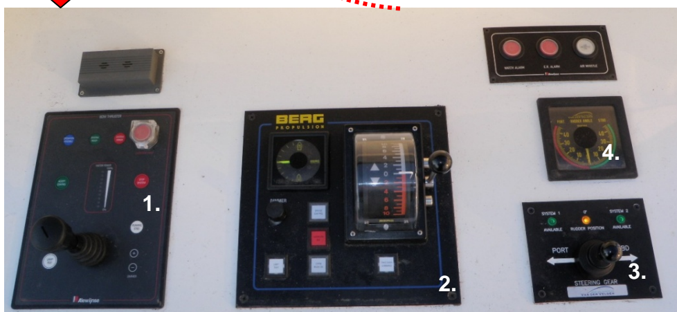
Kuva 4. Komentosillan siiven laitteet: 1. Keulapotkurin säätö, 2. Säätolapapotkurin säätö (CPP), 3. Ruori "Tiller", 4. Ruorikulman näyttö, 5. Hyrräkompassin toisionäyttö (ylempi kuva).
