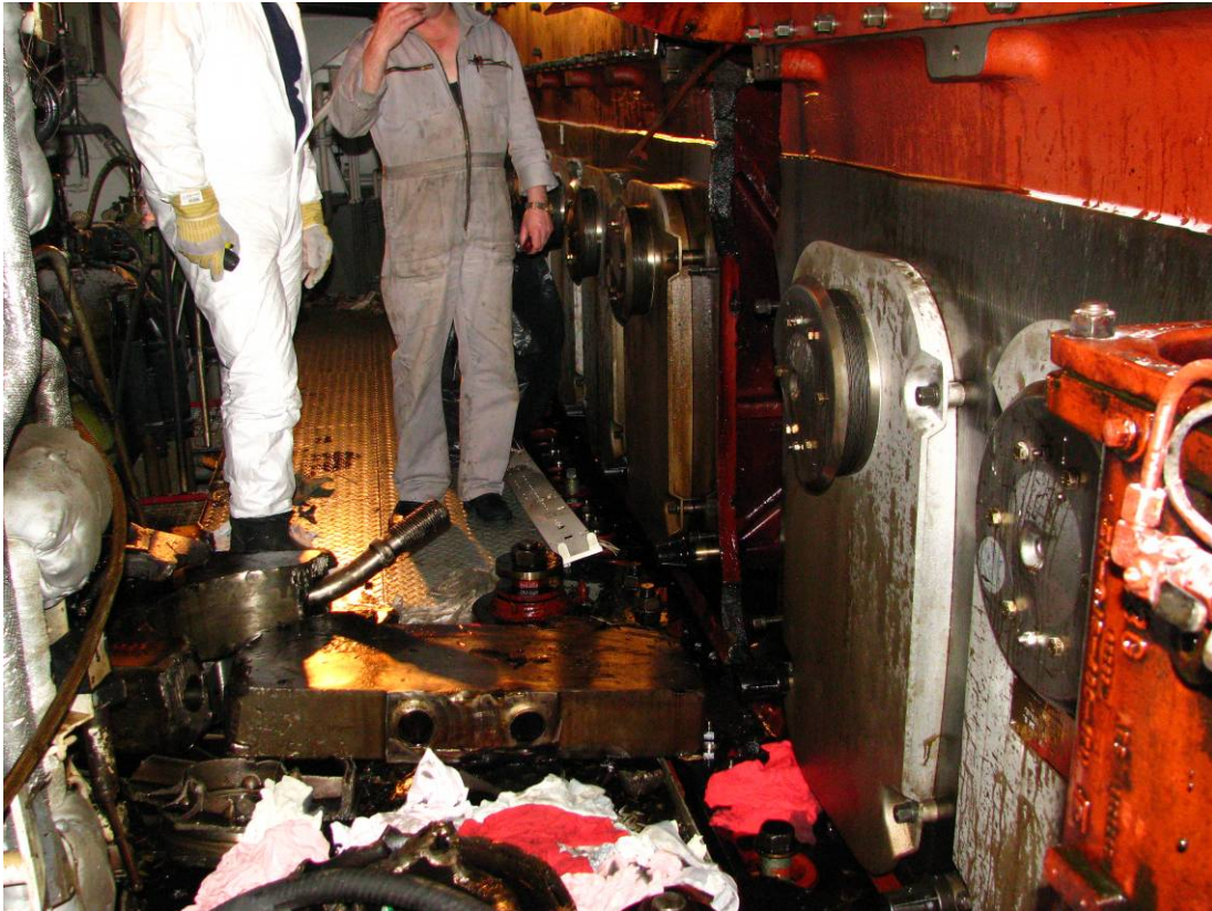
Kuva 4. Ulos konehuoneeseen sinkoutuneita koneen osia, huomaa pääkoneen runkoon syntynyt aukko.
