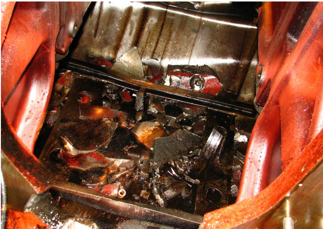
Kuva 6. Palasia pääkoneen kampikammion pohjalla.
