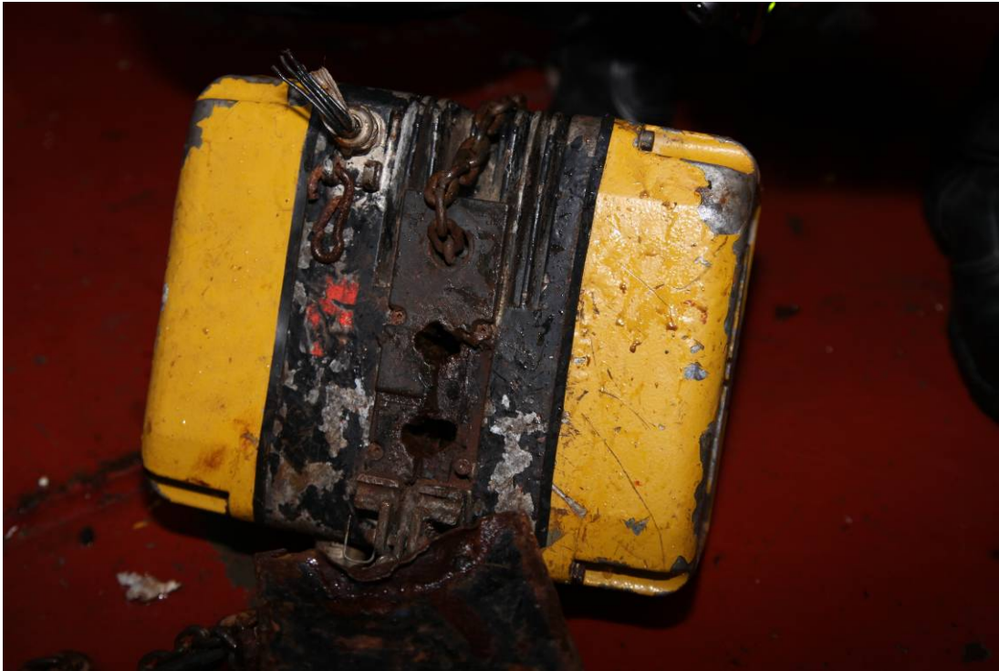
Kuva 8. Rikkoutuneen nostimen alaosa.
