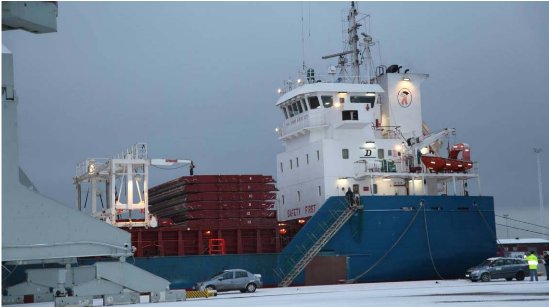
Kuva 2. Aluksen kansiluukkunosturi, johon kiinnitetty laiturinpuoleinen nostin näkyy luukkupinon yläpuolella. Onnettomuusnostin oli merenpuolella.
