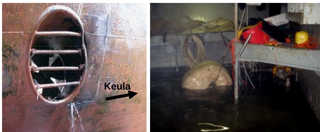
Kuva 11. Vasemmalla: Vauriot WILLEMPJE HOEKSTRAN oikealla puolella keulapotkuritunnelissa. Oikealla: Vettä WILLEMPJE HOEKSTRAN keulavarasto/ keulapotkurihuoneessa. (Kuva vasemmalla: © SCUA Rotterdam B.V., kuva oikealla: © Koninklijke Nederlandse Redding Maatschappij)
