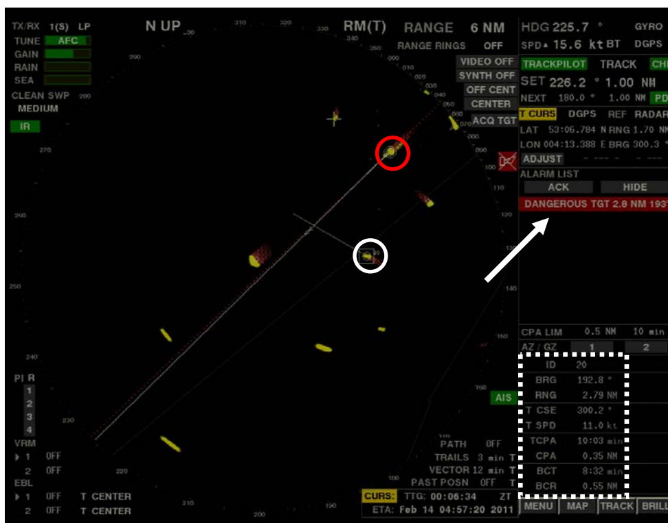
Kuva 5. Kello 3:50:47. BIRKA TRANSPORTERin ARPA-tutkan vaarallisen kohteen hälytys aktivoituu (valkoinen nuoli). Vaarallisen maalin rajoiksi oli asetettu CPA 0,5 mpk ja TCPA 10 minuuttia. Tilanteessa CPA on 0,35 mpk ja TCPA 10,03 minuuttia. Aikaa törmäykseen on noin 10 minuuttia. WILLEMPJE HOEKSTRAN ARPA-tiedot on merkitty valkoisella pisteiviivasuorakulmiolla.
