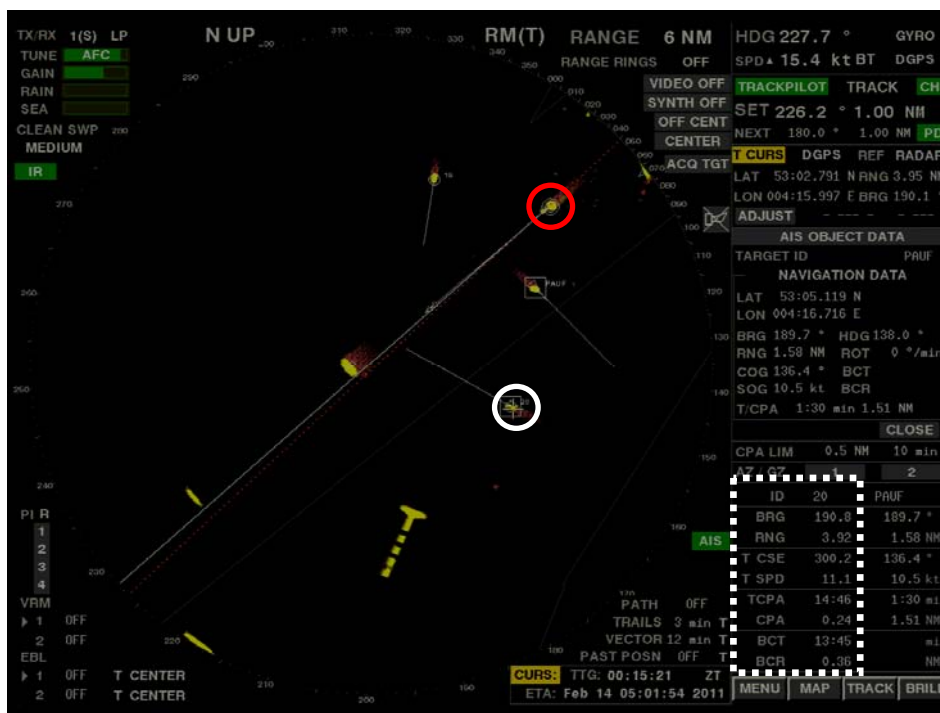
Kuva 7. Kello 3:46:36. Aikaa törmäykseen on noin 14 min. WILLEMPJE HOEKST-RAN (valkoinen ympyrä) ARPA-tiedot (valkoinen suorakulmio pisteviivalla) aktivoitiin. BIRKA TRANSPORTER on merkitty punaisella ympyrällä. CPA on 0,24 mpk ja TCPA 14,46 min.
