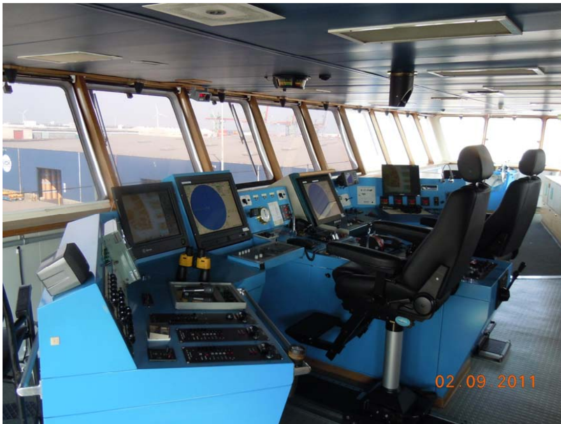
Kuva 3. BIRKA TRANSPORTERin komentosilta. Ohjailu tapahtui taaemmalta tuolilta ennen yhteentörmäystä.
