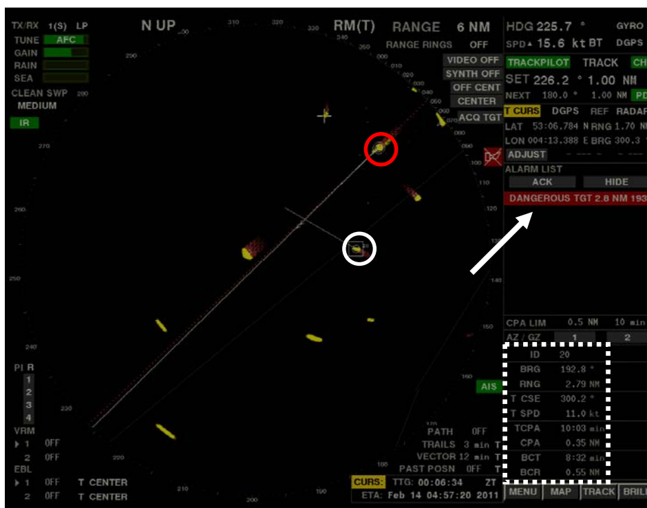
Kuva 8. Kello 3:50:50. Aikaa törmäykseen on noin 10 min. Vaarallisen kohteen hälytys aktivoitui (valkoinen nuoli). CPA on 0,35 mpk ja TCPA 10,03 min.
