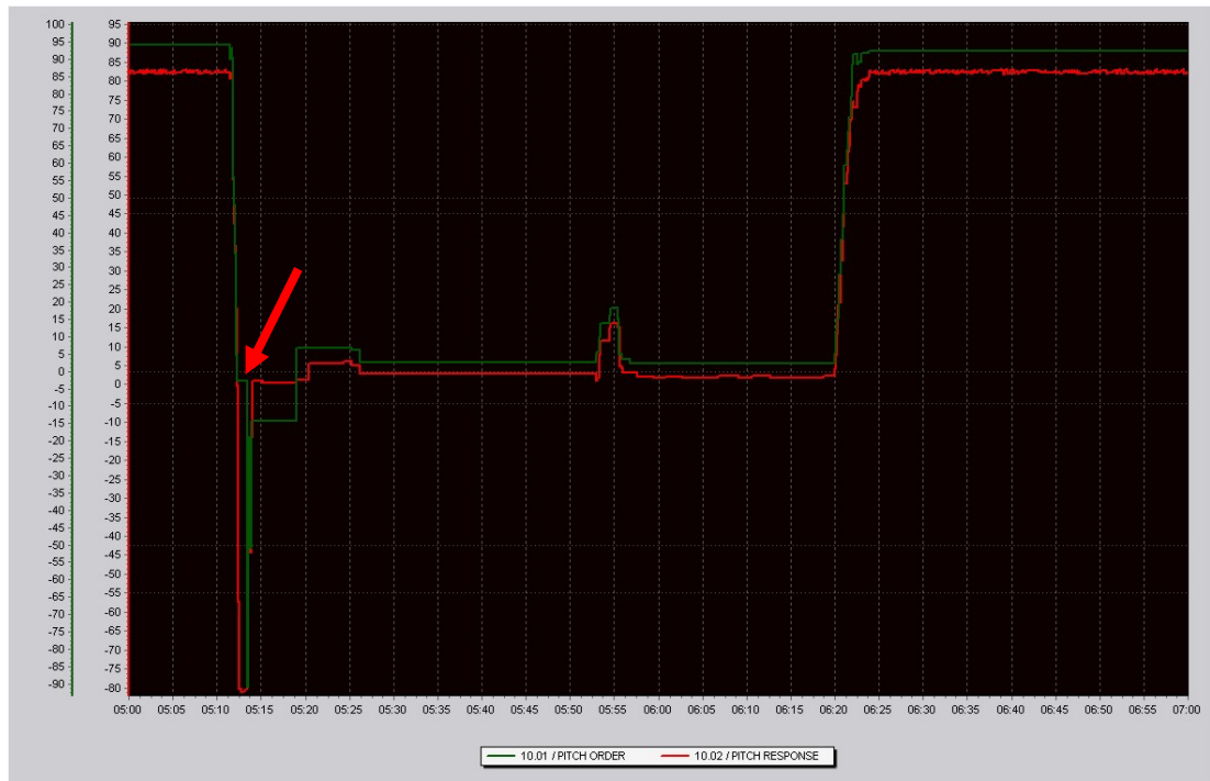
Kuva 8. Potkurinnousutallenne BIRKA TRANSPORTERilta. Nousukulmakomento on esitetty vihreällä ja toteutunut nousukulma punaisella käyrällä. Kellonaika on noin 12 minuuttia edellä S-VDR:n aikaa.
