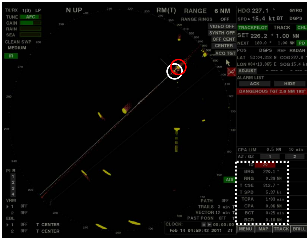
Kuva 6. Kello 3:59:43. BIRKA TRANSPORTERin nopeus alkaa vähentyä. Valkoinen ympyrä on WILLEMPJE HOEKSTRA, punainen ympyrä on BIRKA TRANSPORTER. WILLEMPJE HOEKSTRAN ARPA-tiedot on merkitty valkoisella pisteviivasuorakulmiolla. Aikaa törmäykseen on noin 1 minuutti. CPA 0,06 mpk ja TCPA 1,03 minuuttia.
