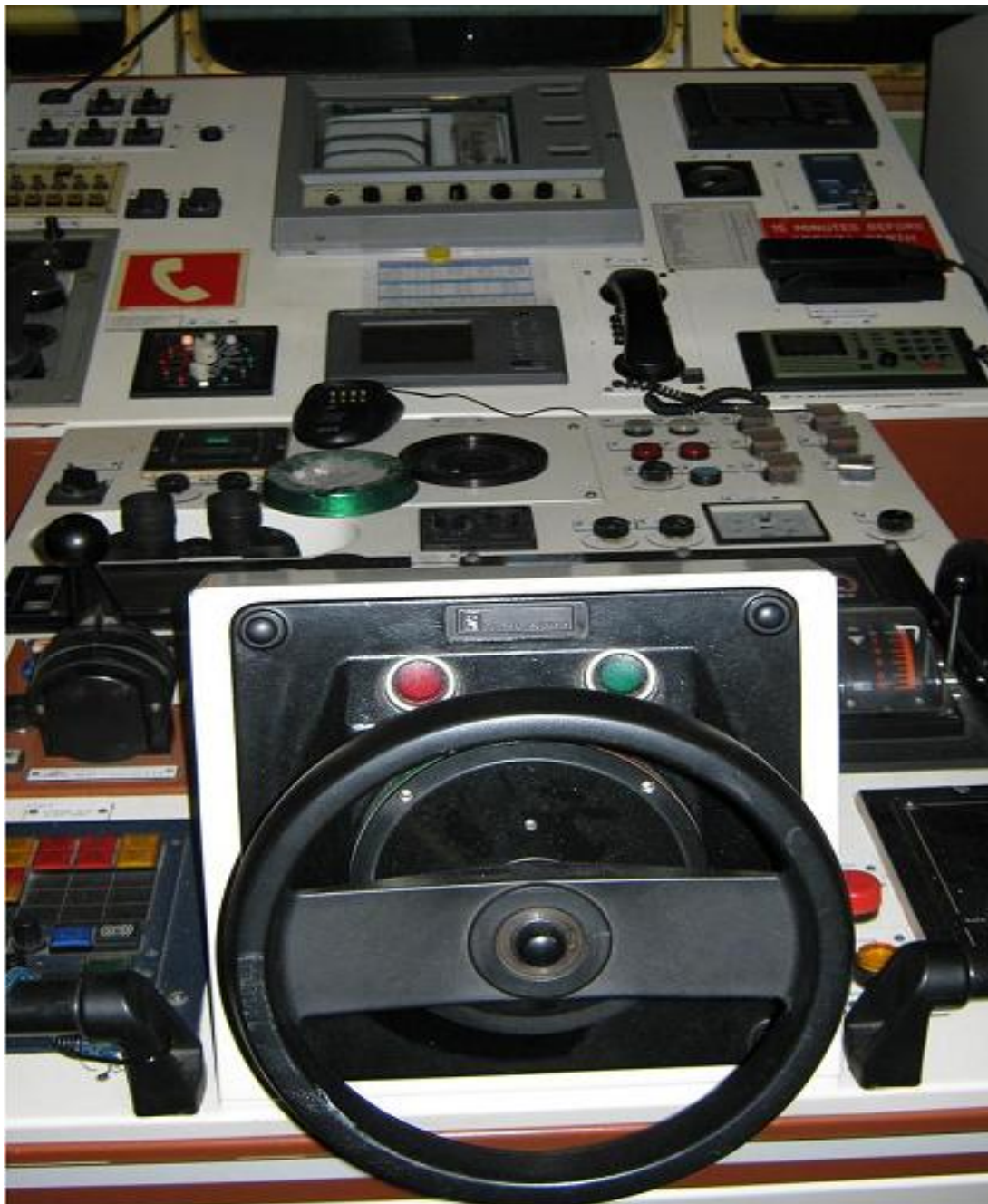
Kuva 3. Ohjaamon yleisjärjestely, hallintalaitteet ja ruoripylyvä keskikonsolissa.
