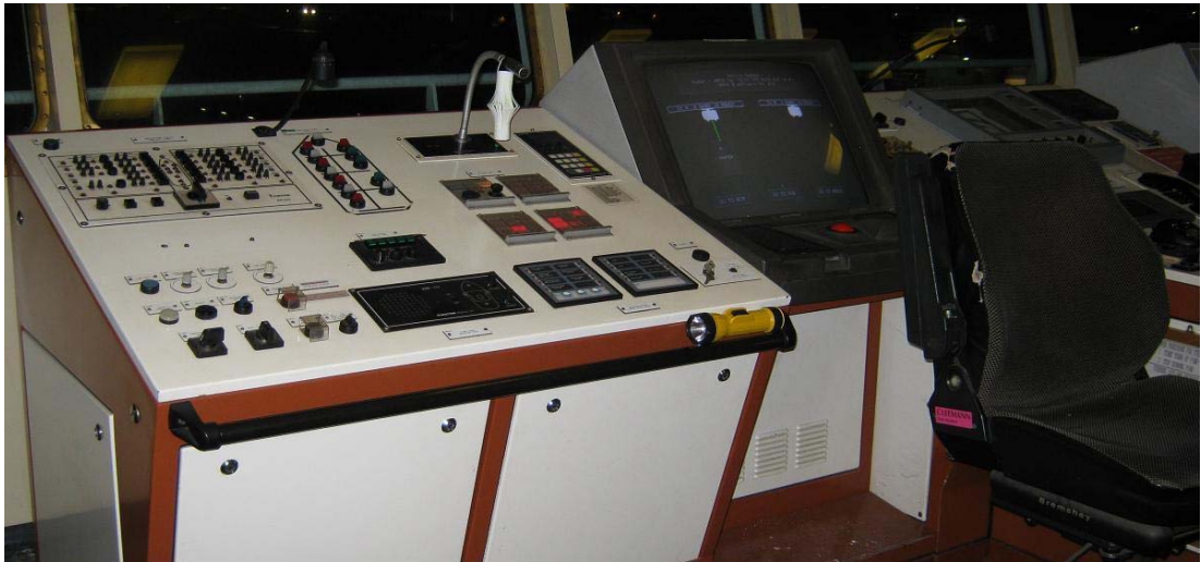
Kuva 4. Ohjaamon yleisjärjestely; vasemman puolen työpiste, tutkanäyttö, hallintalaitteet ja ohjauspaneelit pulpetissa.
