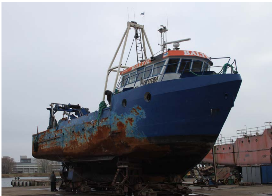
Kuva 4. BALTICin kyljen vaurioita kuvattuna telakalla 1.11.2011. (Kuva: OTKES)
