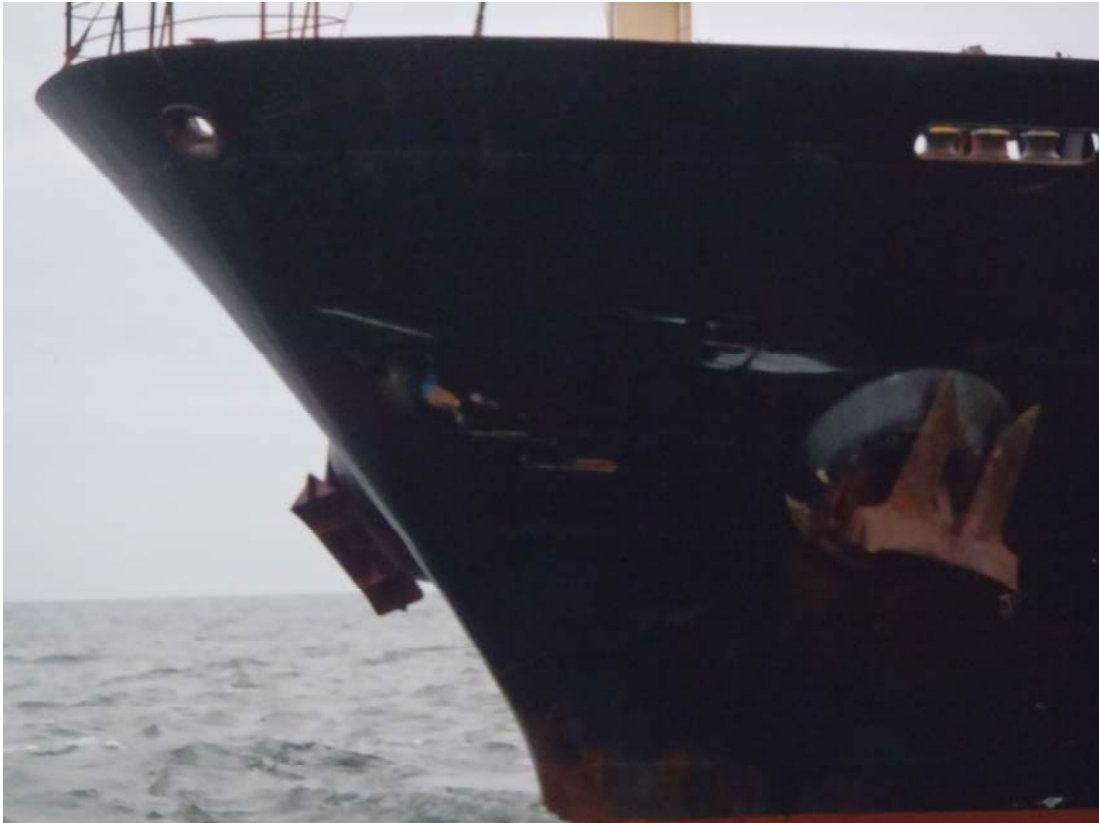
Kuva 17. Kuva AMAZONin keulasta, kun alus oli pysäytettynä Hangon edustalla onnettomuuden jälkeen. Keulan vasemmalla puolella on havaittavissa naarmuja ja maalijälkiä.
