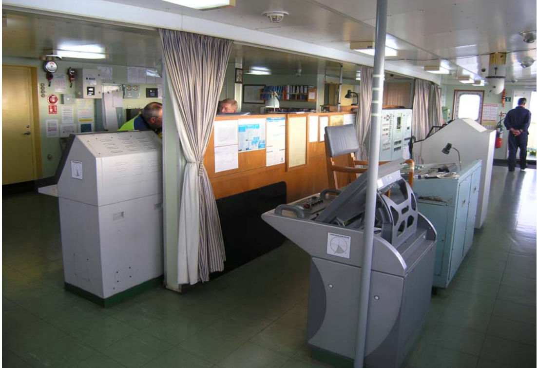
Kuva 5. AMAZONin komentosilta. Pimeällä karttapöytä eristetään muusta komentosillasta kuvassa näkyvällä verholla. Karttapöydän luota ei tällöin näe ulos.
