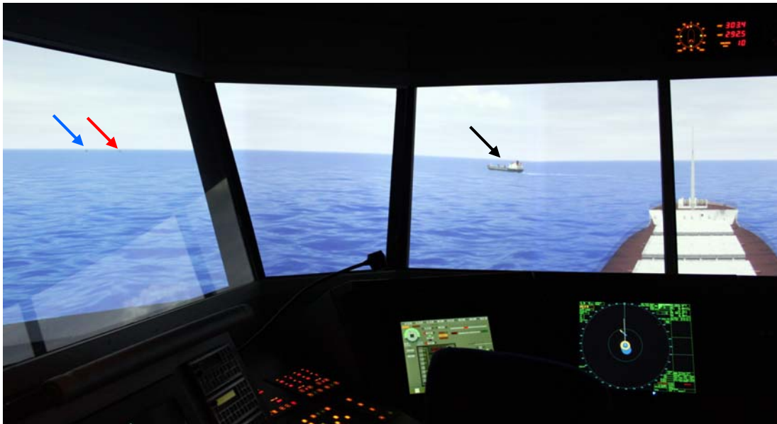
Kuva 6. FLORENCE on merkitty kuvaan sinisellä, MENHADEN punaisella ja STELLA POLARIS mustalla nuolella. Ohituksen aikana aloitetusta käännöksestä huolimatta lähtitilannetta STELLA POLARISin kanssa ei synny, sillä etäisyys siihen lisääntyy käännöksen aikana.
