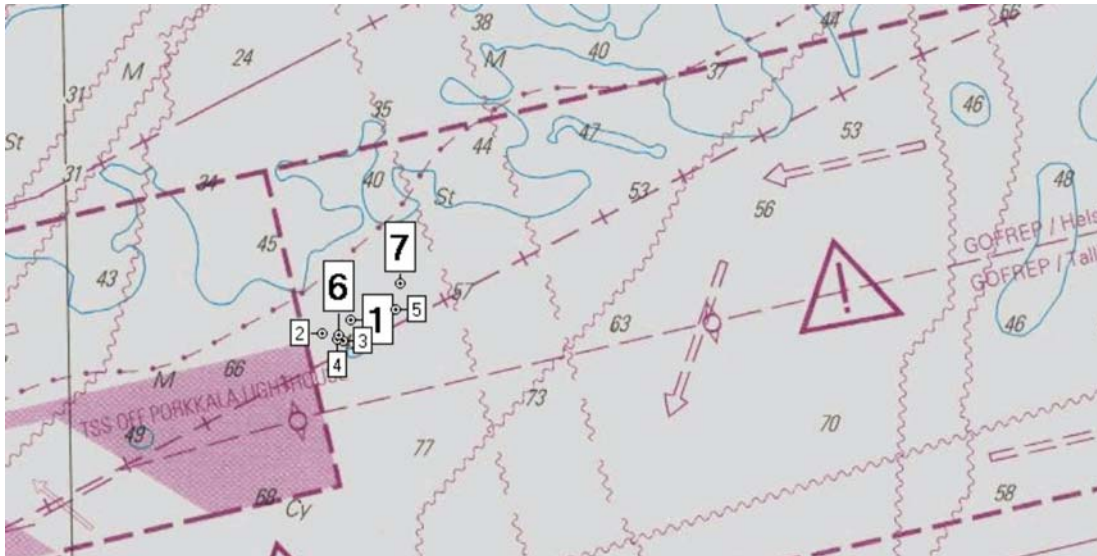
Kuva 20. Kuvassa esitettyjen paikkojen selitykset: 1) Törmäyspaikka, 2) KAUNAS havaitsi öljyä, 3) KAUNAS havaitsi vedessä olevan valon ja kelluvaa materiaalia, 4) Partiovene löysi vedestä hylkytavaraa, öljyä sekä lauenneen pelastuslautan kuoret, 5) Partiovene löysi FLORENCE:n EPIRB -poijun, 6) FLORENCE:n uppoamispaikka, 7) Partiovene löysi FLORENCE:n miehistön pelastuslautalta. Upoamispaikan ja pelastuslautan löytöpaikan välinen etäisyys on noin 0,75 mpk. (Karttapohja © Liikennevirasto)
