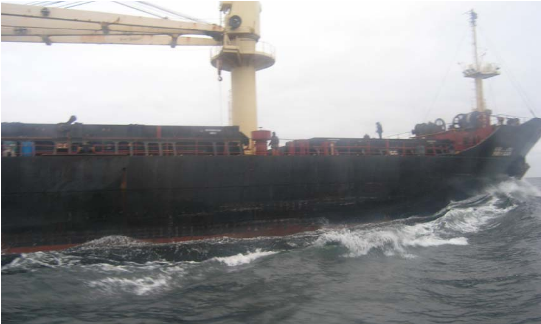
Kuva 27. AMAZONin liikkeessa lastattuna veden pinta nousee keula-aallon seurauksena. Kuva on otettu onnettomuuspäivänä 23.10.2011, joten syväys on sama kuin onnettomuushetkellä.
