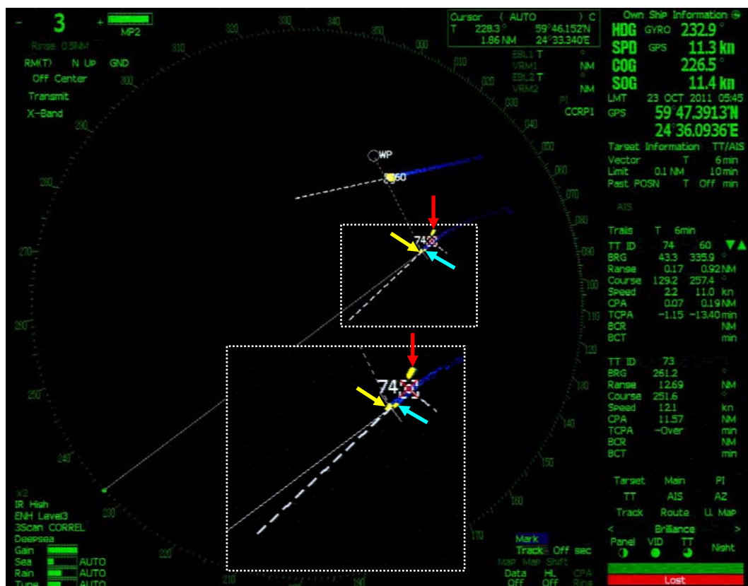
Kuva 15. Kello 04:45:25, yhteentörmäyksestä kulunut noin 1,5 minuuttia. AMAZON on aloittanut käännöksen takaisin oikealle ja ARPA-seuranta FLORENCEen on menetetty (punainen rasti). AMAZONin kurssi 226,5° ja nopeus 11,4 solmua.
