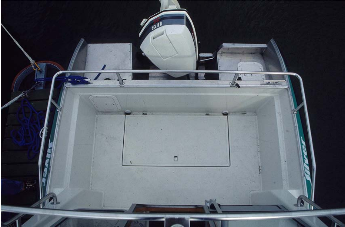
Kuva 2. Kuva vastaavanlaisen veneen perän avotilasta. Tila on selkeä ja sitä ympäröivät kaiteet kauttaaltaan. Onnettomuusveneen vuosimallissa knaapit, köysien kiinnittämiseen tarkoitetut kiinnityshelat, olivat veneen laidoilla pitkitäissuuntaisesti (© Moottorivenelehti Kippari)
