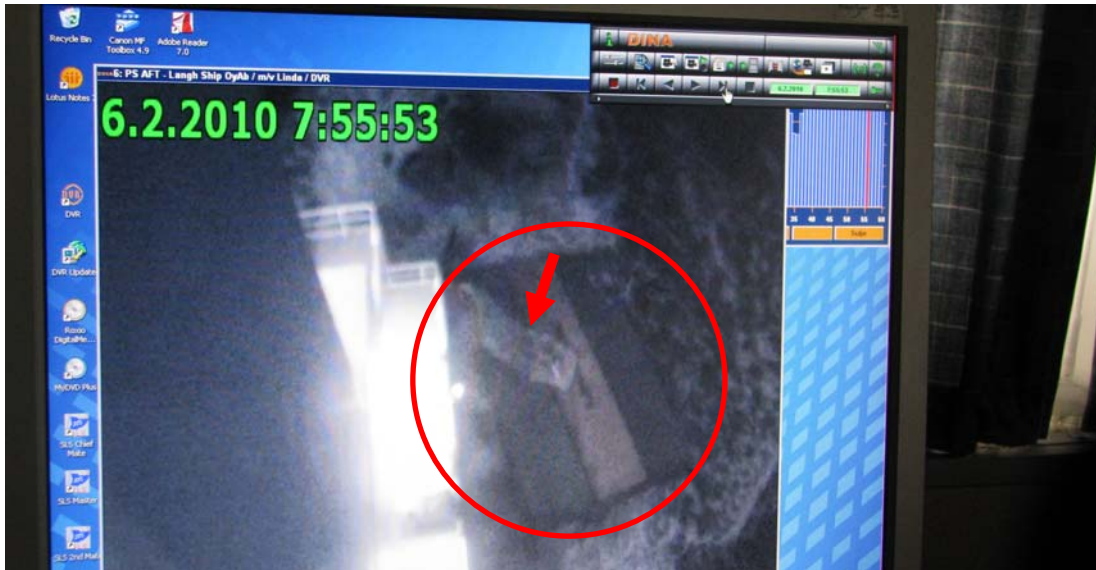
Kuva 6. CCTV-kameran tallentama kuva kuvattuna kameralla aluksen näytöltä. Kuvassa näkyy kolmen toisissaan kiinni olevan kontin blokki (punainen ympyrä), jonka päällä on rikkoontuneen reefer-kontin katto (punainen nuoli). Hie-man blokin perässä ajelehtii reefer-kontin seinä.
