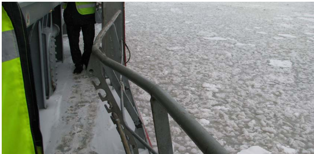
Kuva 5. Pudonneen konttipinon vaurioittama kaide aluksen vasemmalla puolella.
