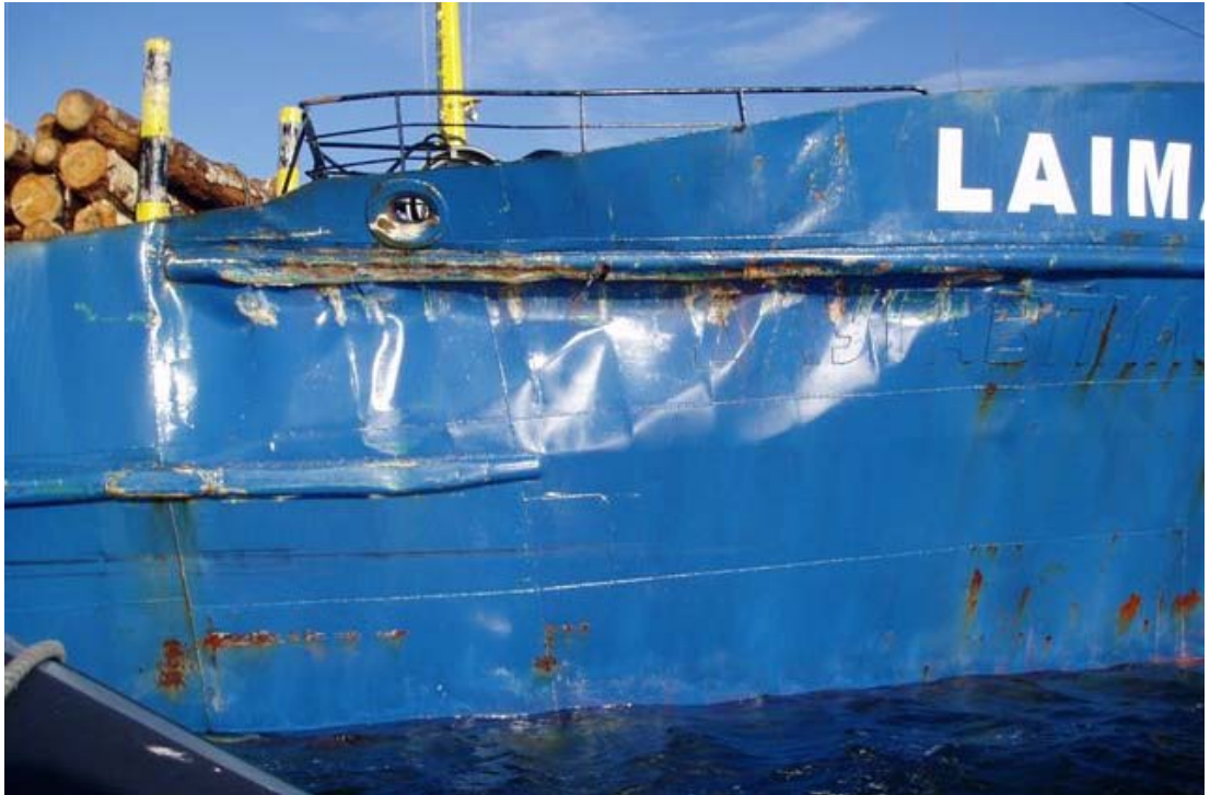
Kuva 8. LAIMAn keulan oikean puolen vauriot ulkoapäin. (Kuva:Rajavartiolaitos)
