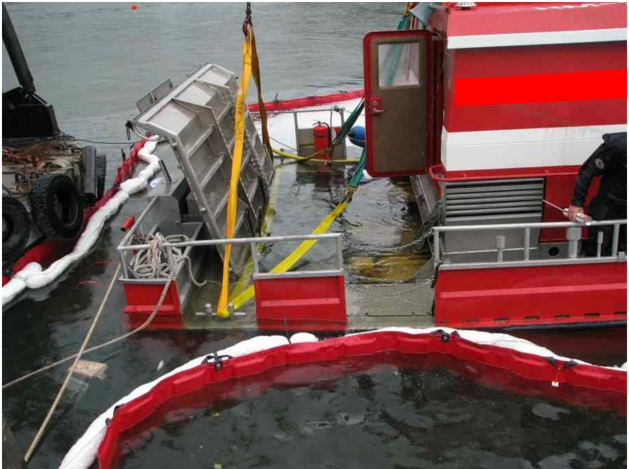
Kuva 3. Onnettomuusveneen nostoa tyhjennystä ja vuodontukkeamista varten aloitetaan.
