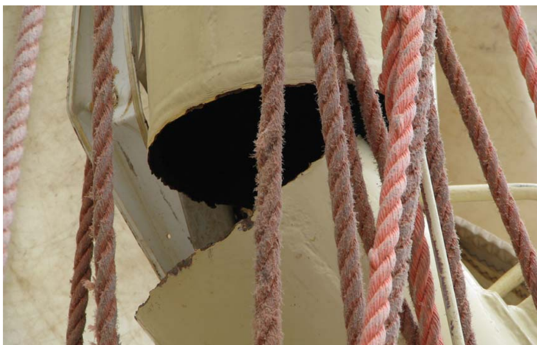
Kuva 9. Hitsausaumojen vierestä tapahtunut katkeaminen.
