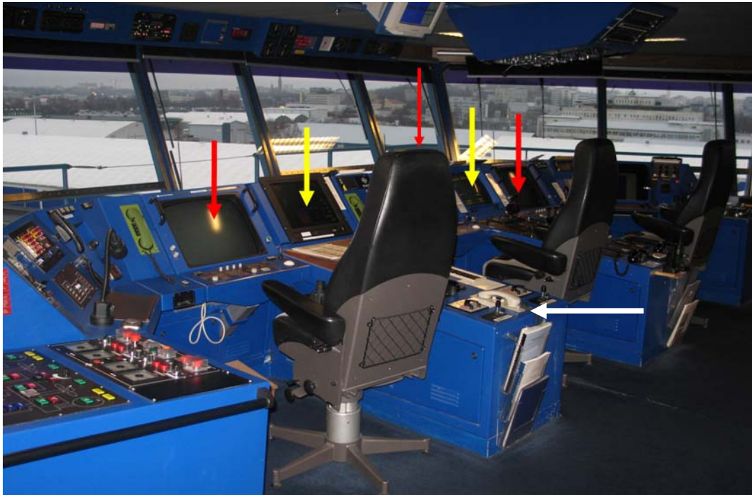
Kuva 2. Näkymä komentosillalla, aluksen ohjauspaikat. Kuvattu 24.11.2009 Turussa. Punaiset nuolet osoittavat tutkanäytöt (yksi näyttö on piilossa tuolin takana) ja keltaiset nuolet conning-näytöt. Keskellä on linjaluotsin (pääohjauspaikka), oikealla vahtipäällikön (monitoroiva navigaattori) ja vasemmalla päällikön tuoli.. Valkoinen nuoli näyttää peräsinkoneen paineakkujen käyttökonsolin, vivut oikealla ja vasemmalla.
