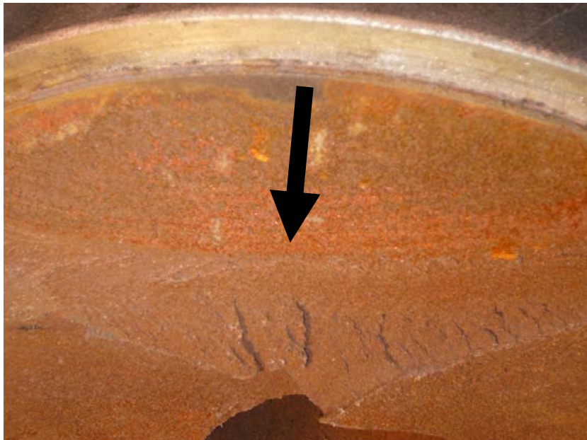
Kuva 38b. Lähikuva murtopinnasta akselin yläosassa. Kuvassa on näkyvissä harjanteet, jotka etenevät väsymisalueesta kohti akselin keskiötä. Voidaan päätellä, että tällä puolella akselia on katkeamishetkellä ollut vetojännitys. Kuva VTT.
