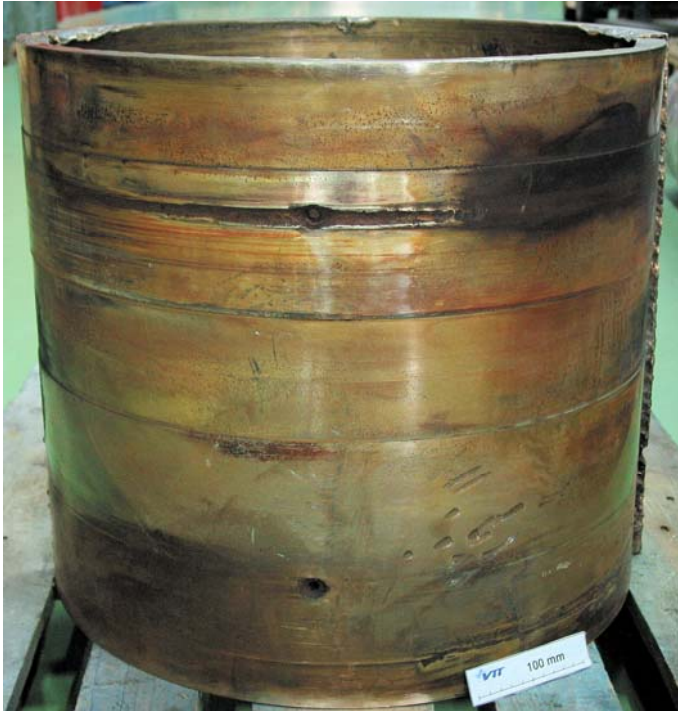
Kuva 44e. BB-alalaakerin pronssiholkin ulkopintaa, kuva VTT. Pinnassa on syvempiä naarmuja kuin SB-holkissa.
