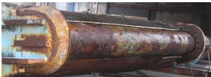
Kuva 9 Jastram-rulla kuvattuna irrotetussa SB-peräsimessä 4.12.2009. Vasemmal-la näkyvät vuonna 2004 asennetut rullan alaosan tuet, "sukset".
