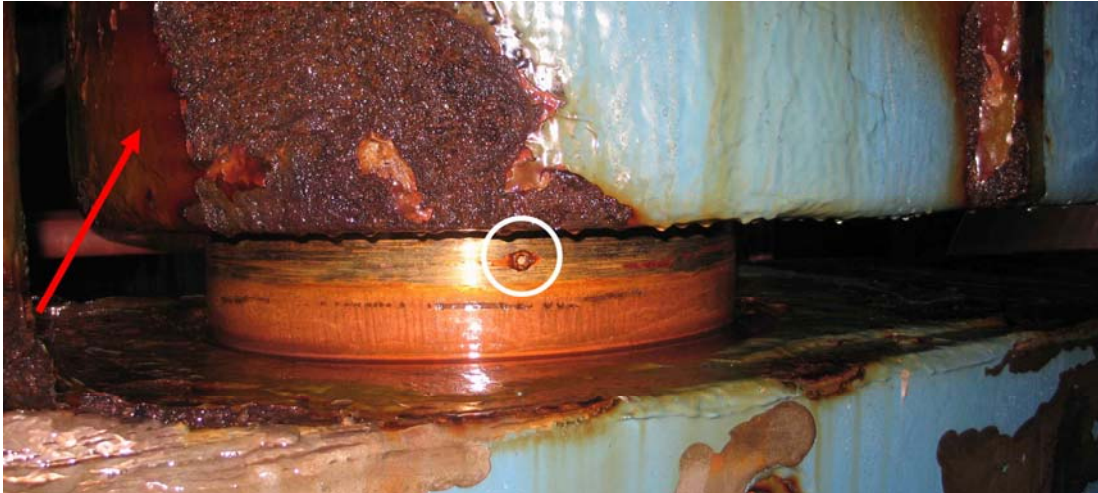
Kuva 23b. SB-peräsimen alalaakerin alas pudonnut pronssiholkki. (2.12 Gdansk). Ulkopuoli, keulan suunta on oikealle. Näkyvissä on yksi asennusruuveista (valkoinen ympyrä), jonka etäisyys holkin alareunasta on 100 mm. Peräsimen ja sarven väli on siten 130–140 mm. Nuoli näyttää kohdan, joka on saattanut hankautua peräsimen ollessa sarven varassa, katso kuva 22b.
