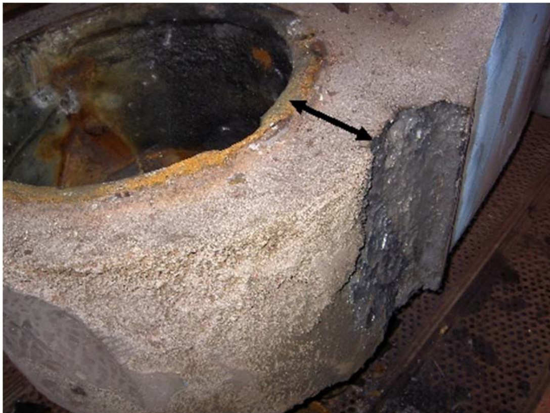
Kuva 44d. BB-puolen alalaakerin pesä pronssiholkin poiston jälkeen. Epoksin poiston jäljiltä on näkyvissä ruostetta; vesi on ollut jonkin aikaa epoksin ja pesän välissä. Ulkopinnalla on näkyvissä voimakas kavitaatiosta johtuva syöpymä. Ainesvahvuus on nuolen osoittamassa paikassa pienentynyt vaarallisen paljon. Sarvi on ulkopuolelta jo hiekkapuhallettu. Kuvattu 4.12. Vrt. kuvaan 28a.
