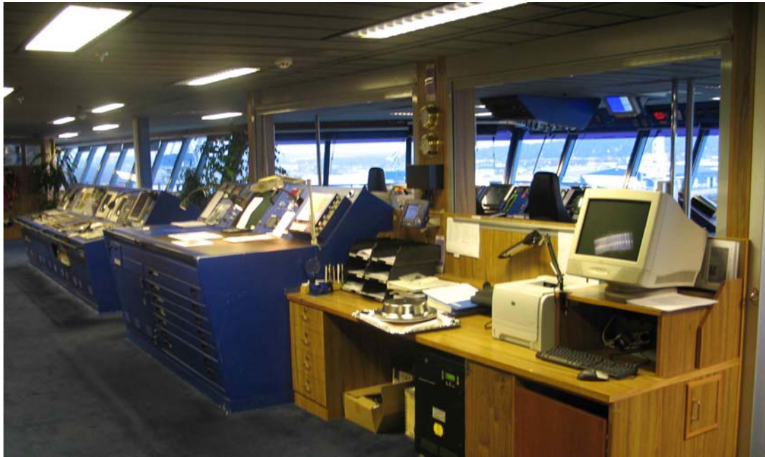
Kuva 2b. Näkymä komentosillalla ohjauspaikkojen takana. Kuvattu 24.11.2009 Turussa. Vasemmalta: turvakonsoli, karttapöytä ja työpöytä, jonka alla on VDR-laitteisto (musta laatikko).
