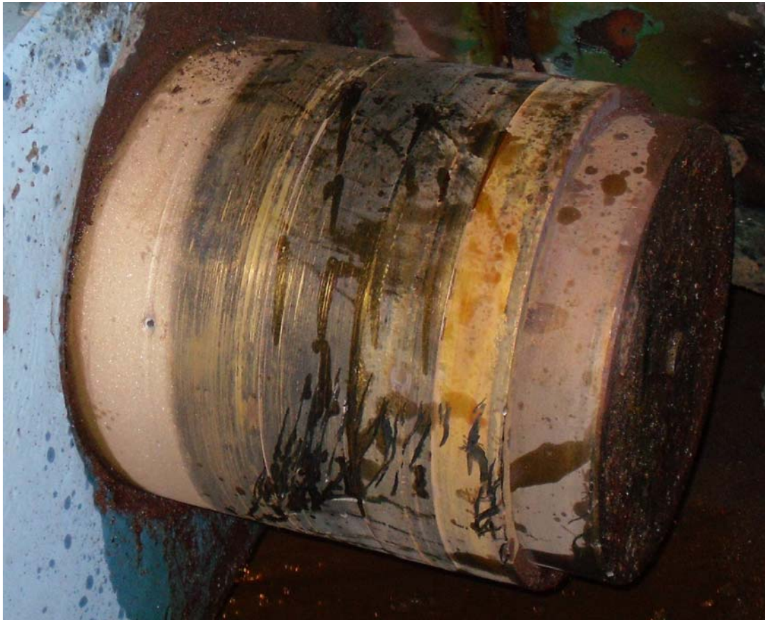
Kuva 42a. SB-ala-akselin yläpää, jonka päällä on alaspäin pudonnut pronssiholkki. Varustamon kuva peräsimen irrotuksen jälkeen 3.12.2009, peräsin oli vaaka-asennossa.
