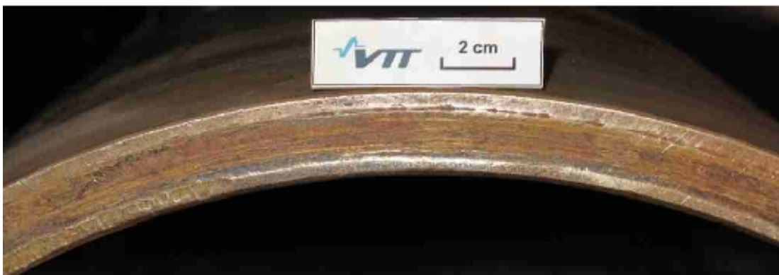
Kuva 42b. SB-alalaakerin pronssiholkin alareunaa. VTT:n kuva.
