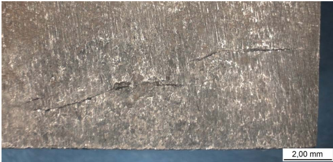
Kuva 6 Kohdan 1 säröt stereomikroskoopilla kuvattuina. Kuva VTT. Kuvassa näkyvät selvästi edestakaisen hankauksen jäljet.
