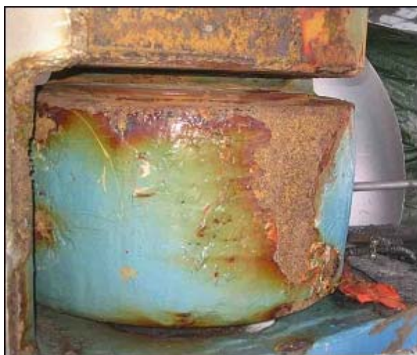
Kuva 28a ja b SB-alalaakeri kuvattuna vuonna 2007. (Bureau Veritasin tarkastaja).
