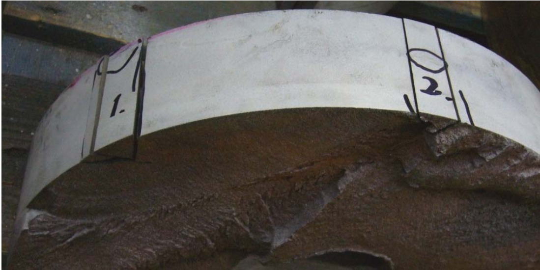
Kuva 5. Paikat, joista leikattiin säröjen tutkimista varten palaset katkenneesta akselistasta. Kuvassa alhaalla on hyvin näkyvissä murtopintaa. Kuva VTT.
