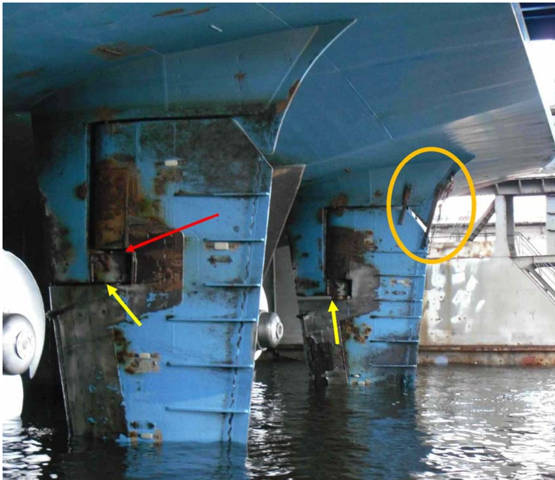
Kuva 21. Peräsimet varustamon kuvaamina Riikassa 28.11.2009 nostoyrityksen aikana. Huomaa pudonneen SB-peräsimen tuenta (oranssi soikio) aluksen siirtojen ajaksi. Punainen nuoli BB-peräsिमessä näyttää raon, jonka verran peräsin voi pudota. Keltaiset nuolet näyttävät sarven alapuolisen raon ehjässä ja vaurioituneessa peräsिमessä. Ruostumatonta teräslevypäälystettä oli irronnut.
