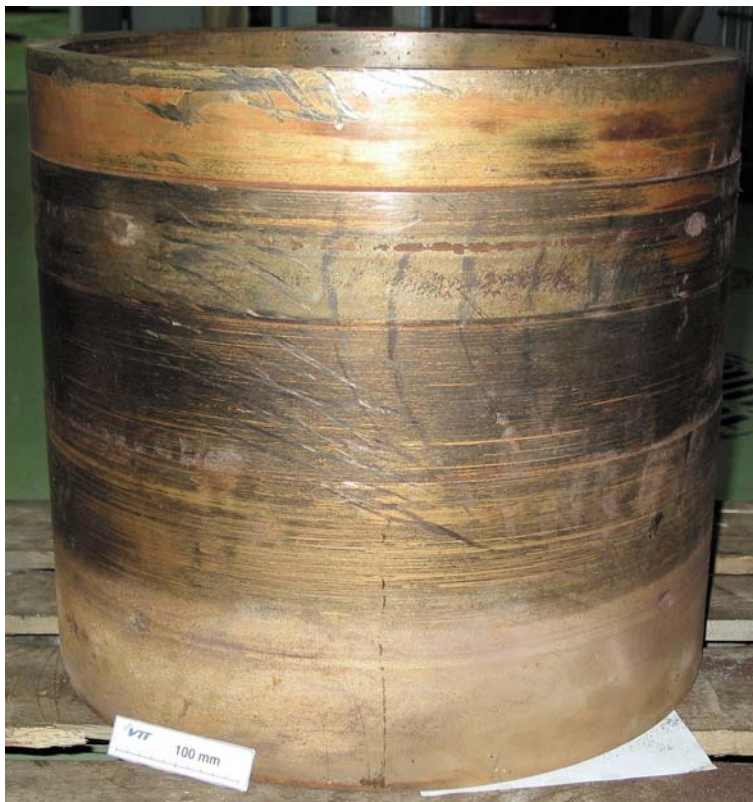
Kuva 43c. SB-alalaakerin pronssiholkin ulkopintaa, kuva VTT. Näkyvissä on naarmuja ja ruuvien jäänteitä. Tarkemmin liitteessä 1.
