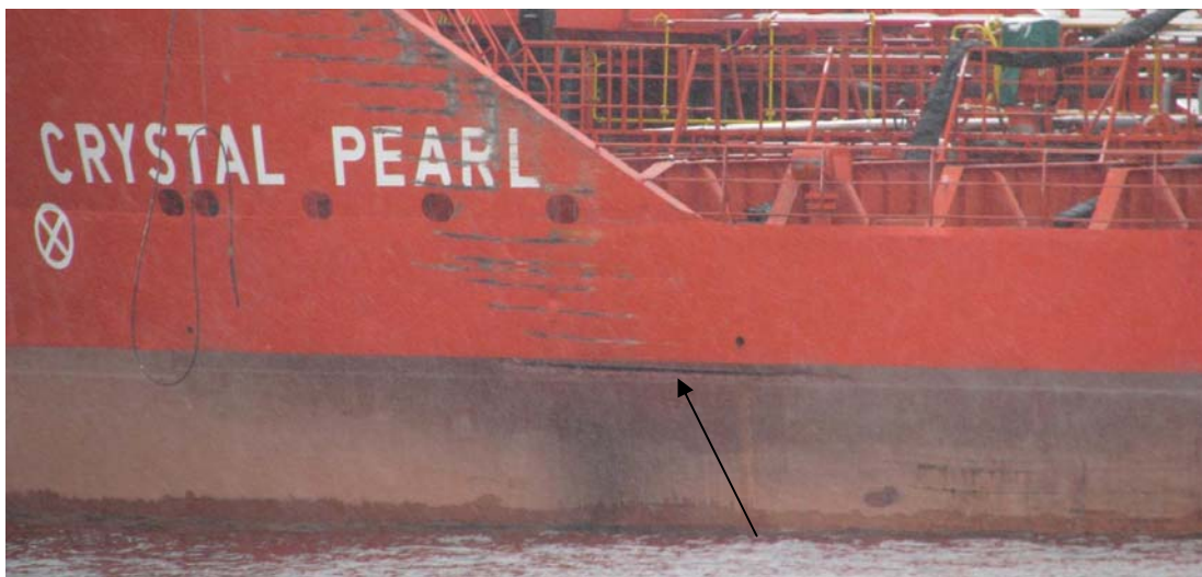
Kuva 15. Nuoli osoittaa repeämää keulassa vasemmalla sivulla.
