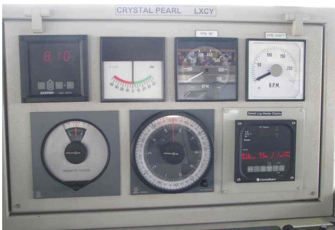
Kuva 4. Keskikulpetin sensori-, peräsinkulma- ja kierroslukutiedot. Ylhäällä vasemmalta alkaen kaikuluoti, ruorikulma, pääkoneen kierrosluku ja potkurin kierrosluku. Alhaalla vasemmalta alkaen magneetikompassi, hyrräkompassi ja nopeusloki.
