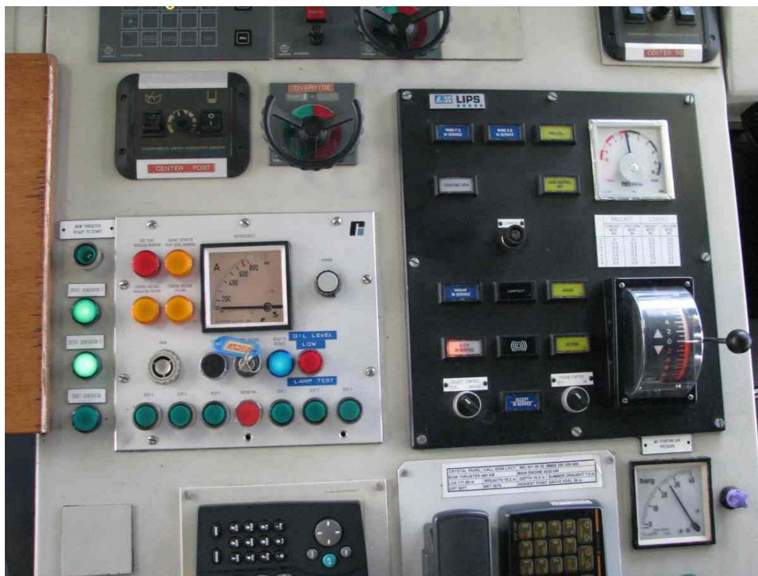
Kuva 7. Vasemmalla keulaohjauspotkurin hallintapaneeli ja oikealla potkurin nousun ja kierrosluvun säätökahva.
