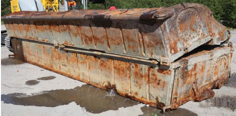
Kuva 14c. Keulajakson oikea ponttoniyksikkö, keskiponttonin perätankin kahdesta reiästä valuu vettä välittömästi maihin noston jälkeen 29.6. (Vuotokohtat ovat reikä D, vasemmalla, ja reikä E, oikealla, kuva 16). Kokkolan poliisin ottama kuva.
