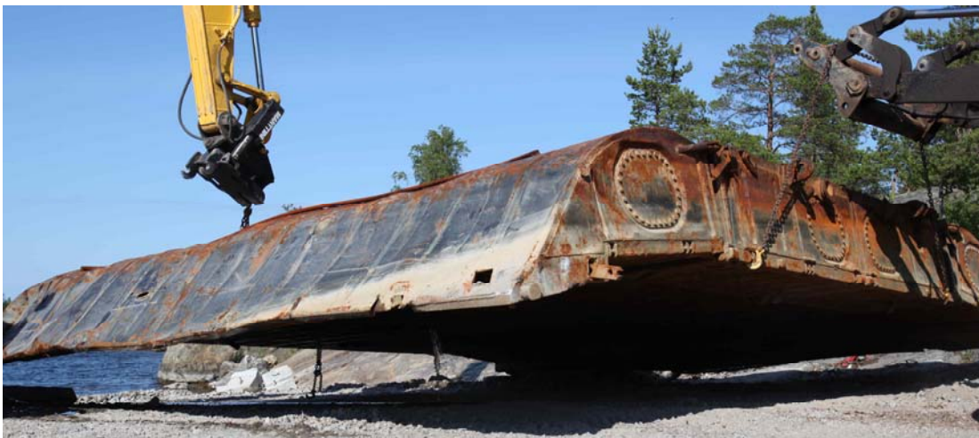
Kuva 14e. Peräjaksoa nostetaan maihin 29.6. Vettä valuu kannessa tai sivulaipiossa olevasta reiästä. Jakson peräpää on merelle päin. Kylki on lievästi painunut. Kokkolan poliisin ottama kuva.
