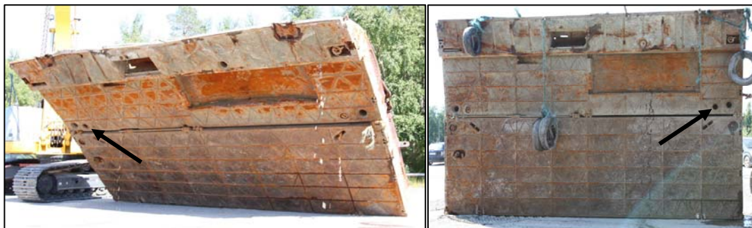
Kuva 14a. Keulajakson ponttoniyksiköitä käännetään 29.6. Vasemmalla vasen ponttoniyksikkö, jonka keulapää on oikealla. Oikealla oikea ponttoniyksikkö, jonka keulapää on vasemmalla. Pumppausaukot, joista puuttuu kierretulppa, on näytetty nuolella. Onnettomuusmatkan aikana pumppu sijaitsi vasemmalla ponttoniyksikössä. Ylhäällä on näkyvissä ankkurilaitteiston syvennys, jossa on aukot pohjan läpi mm. vaijerille. Kokkolan poliisin ottama kuva. Seuraavassa kuvassa oikea yksikkö on kuvattuna toiselta puolelta.
