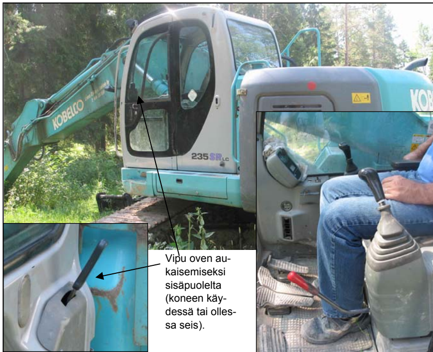
Kuva 3a. Rauman alueella toimiva vastaava kaivinkone 24 , vuosimalli 2000. Polkimilla (keskellä) ohjataan telaketjuja, kahdella mustalla vivulla puomia ja kauhaa. Punainen turvavipu on käännetty ala-asentoon, jolloin kaivinkone on käynnistyksen tapahduttua toimintakunnossa. Onnettomuusversiossa oli lisäksi polkimien luona kaksi vipua, joilla myös voi ohjata telaketjuja. Polkimien vieressä ovat jalkatuet.
