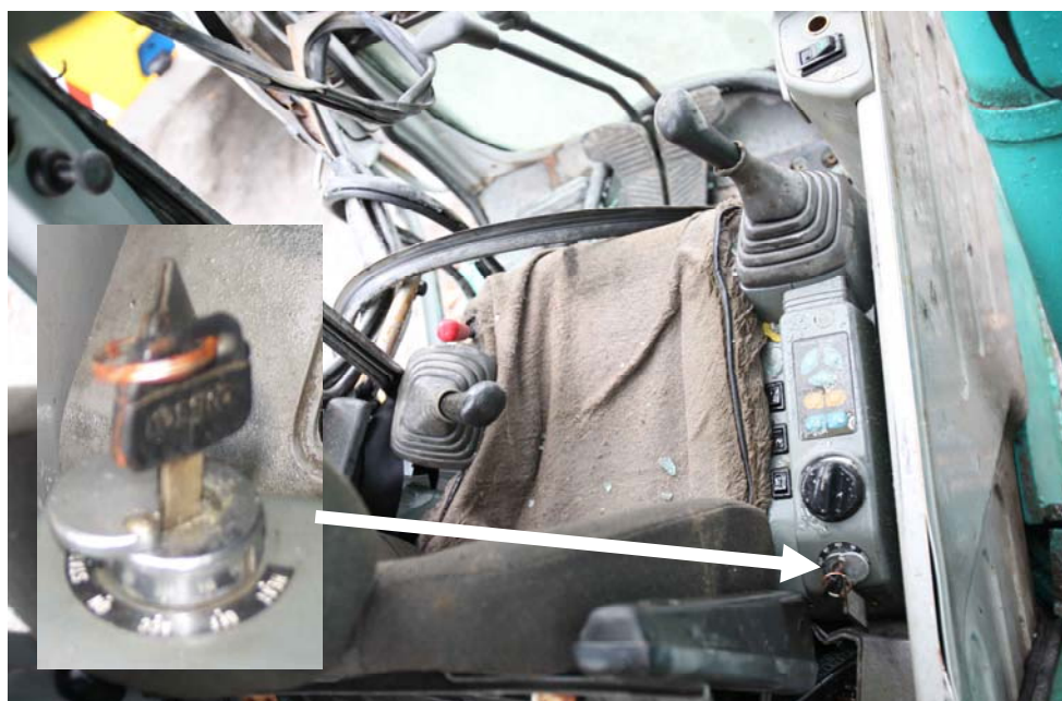
Kuva 17b. Maihin nostetun kaivinkoneen hytti 11.6. Käynnistysavain on asennossa "ON". Asennot ovat myötöpäivään: HEAT, OFF, ACC, ON, START.
