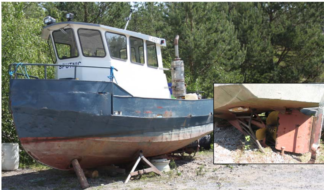
Kuva 18. Hinaaja nostettuna maihin kalasatamassa 30.6. Isompi kuva on Kokkolan poliisin ottama. Entisen keulapotkurin aukko on näkyvissä tukena olevan tukin kohdalla.
