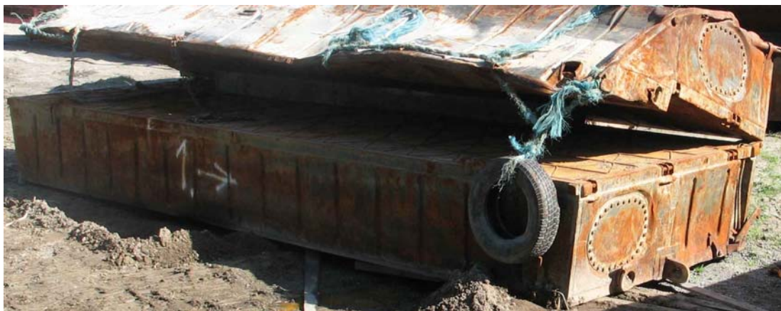
Kuva 16c. Toinen ponttoniyksikkö (perän oikea), josta vielä valui vettä kuvattaessa 5.8. Valumiskohta on pohjassa 170 cm oikeasta päädystä ja 30 cm kuvassa näkyvästä laipiosta (jossa merkintä 1.->). Reiän poikkipinta-ala 1–2 mm 2 .
