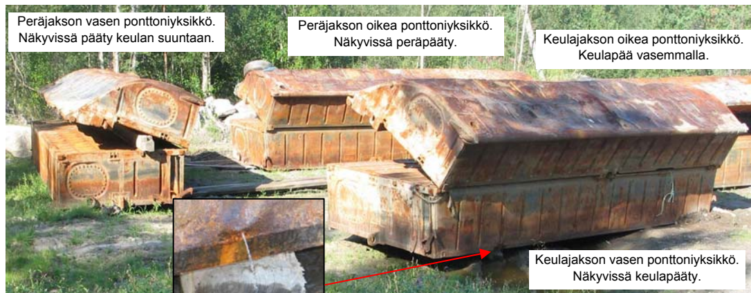
Kuva 16b. Ponttoniyksiköt kuvattuina 5.8 toisesta suunnasta. Vettä valui edelleen kahdesta reiästä, kuvassa niistä toinen. Reiän poikkipinta-ala 1–2 mm 2 .
