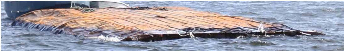
Kuva 6b. Ylösalaisin kelluva lautta kuvattuna perästä. Tätä, yllä olevaa ja vastaavia kuvia on käytetty hyväksi arvioitaessa nurinpäin olevan lautan syväyksiä painolaskelmia varten. Näiden ja muidenkin kuvien perusteella oikein päin kelluvan lautan (perästä katsottuna) oikea pallepyöritys on voimakkaammin lommoilla kuin vasen. Molemmat kuvat ovat Kokkolan poliisin ottamia.
