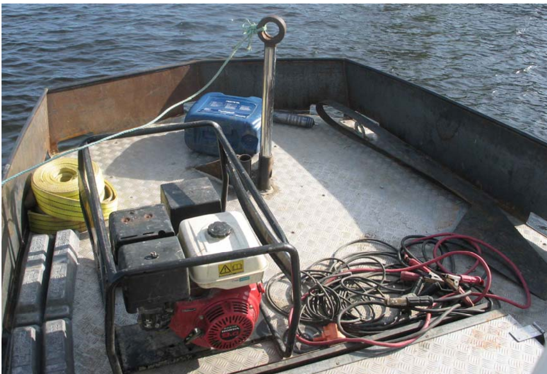
Kuva 1b. Hinaajan peräkansi, jossa on aggregaatti ja tanko hinausköyttä varten. Pumpun letkua on myös näkyvissä.
