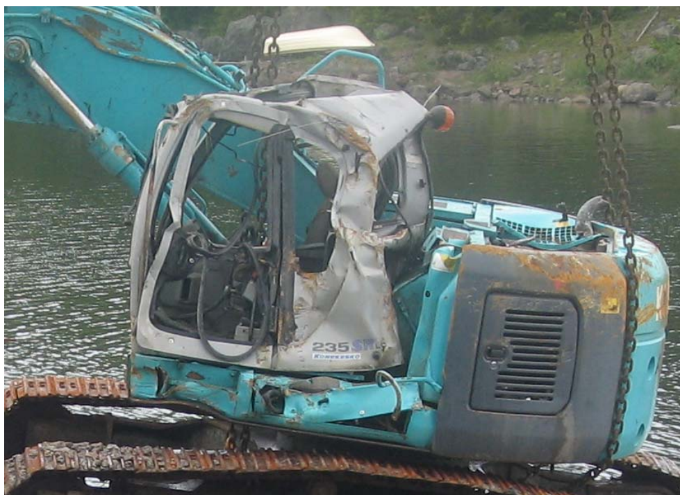
Kuva 17a. Ylösnostettua kaivinkonetta ollaan siirtämässä kuljetusalustalle Luodon ka- lasatamassa 11.6. Hytti vaurioitui meressä noston ja merikuljetuksen aika- na 69 .
