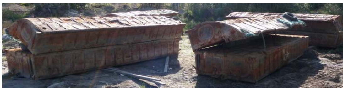
Kuva 16a. Ponttoniyksiköt kuvattuina 5.8. Sivuponttonit ovat käännettyinä keskiponttonien päälle tutkintaa varten. MKL:n tarkastajan ottama kuva. Lommot ovat selvästi näkyvissä.
