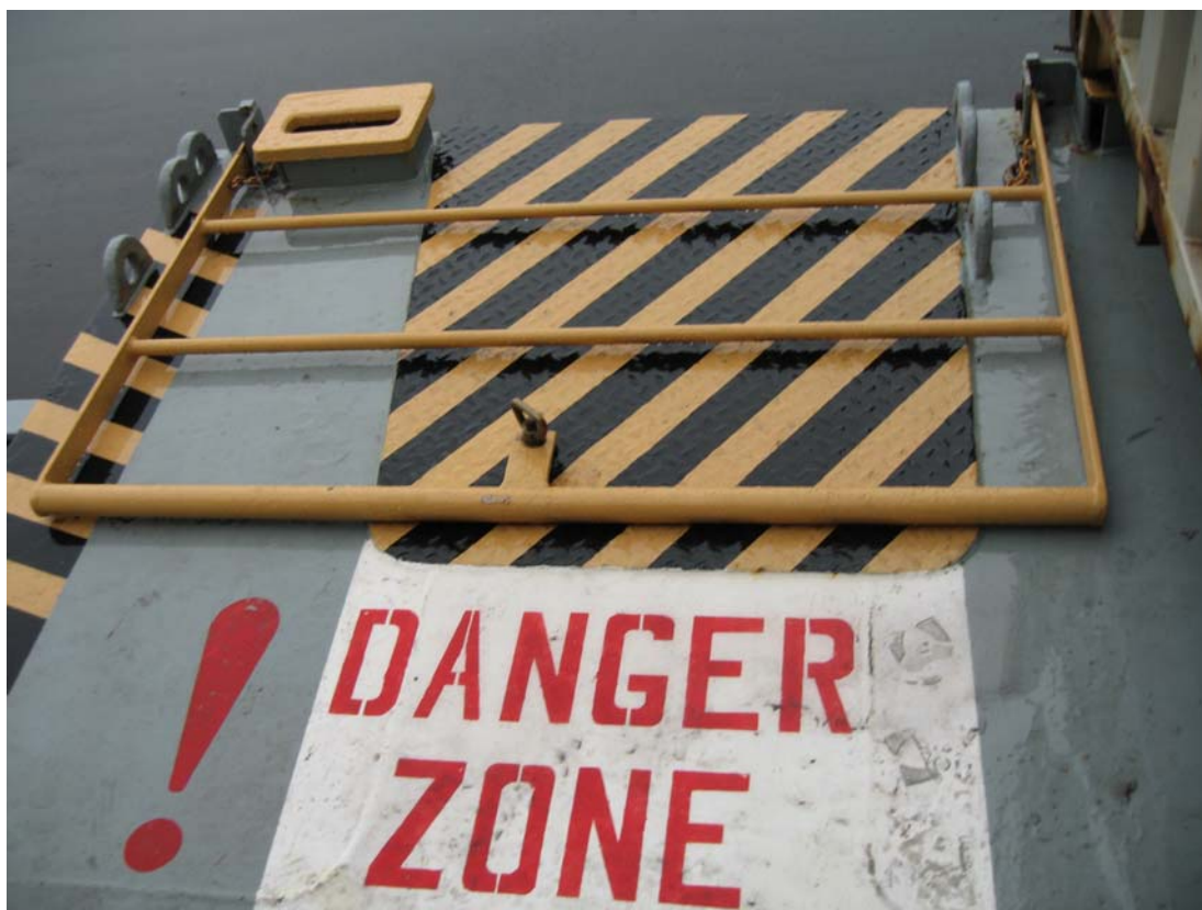
Kuva 7. Onnettomuuspaikalle lisätty kaide ja varoitusmaalaus, aluksen SB-puoli..
