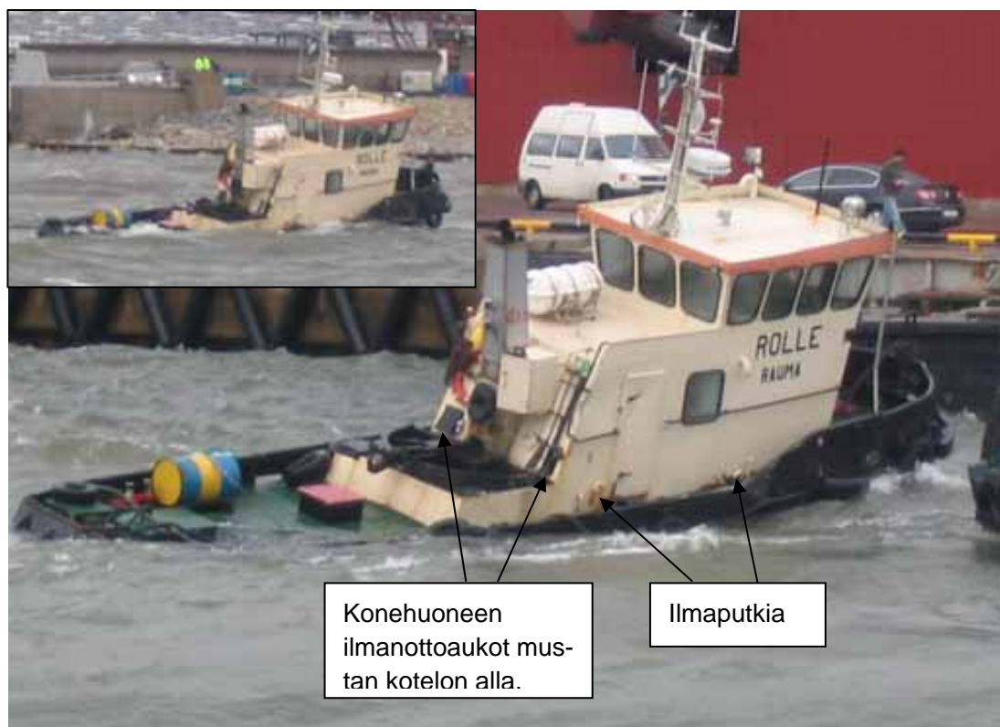
Kuva 5 ROLLE noin 10 minuuttia ennen uppoamistaan laiturin ja proomu SCG3:n luona. Pienemmässä kuvassa tilanne on vielä hinauksen alussa viisi minuuttia aiemmin. Vuodot ovat vielä edenneet hitaasti. Näkyvissä olevat ikkunat näyttävät ehjiltä. Oven yläosa ja rakennuksen peräkulma ovat saaneet kolhuja. (Katso myös. kuvaa 14).
