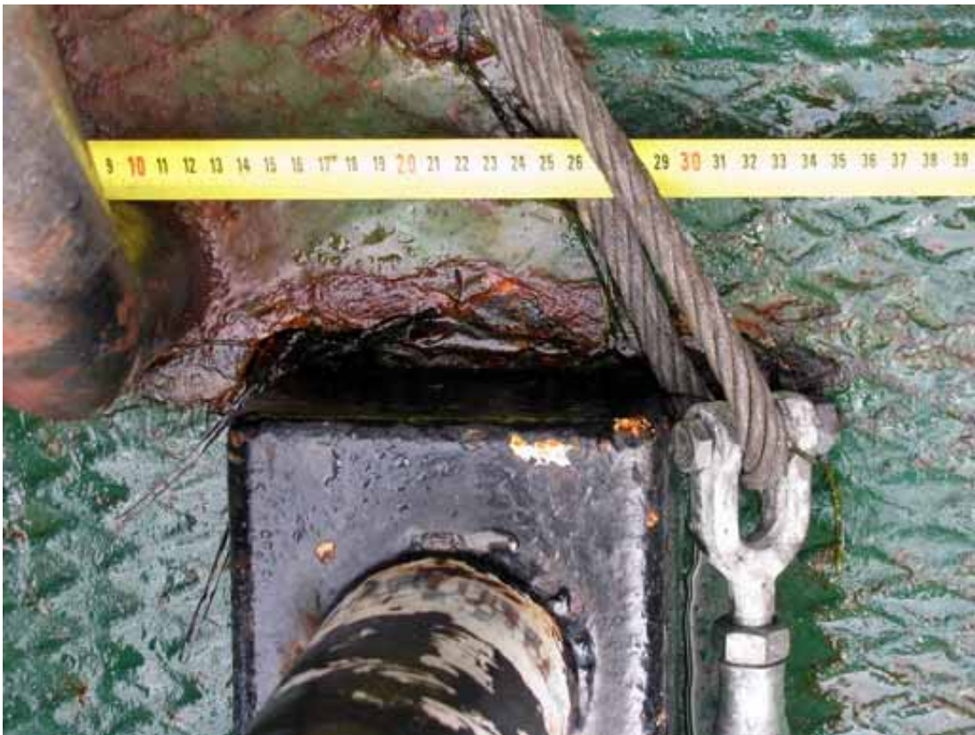
Kuva 8. Eestin tutkijoiden ottama kuva perän pollarin repeämispaiasta.
