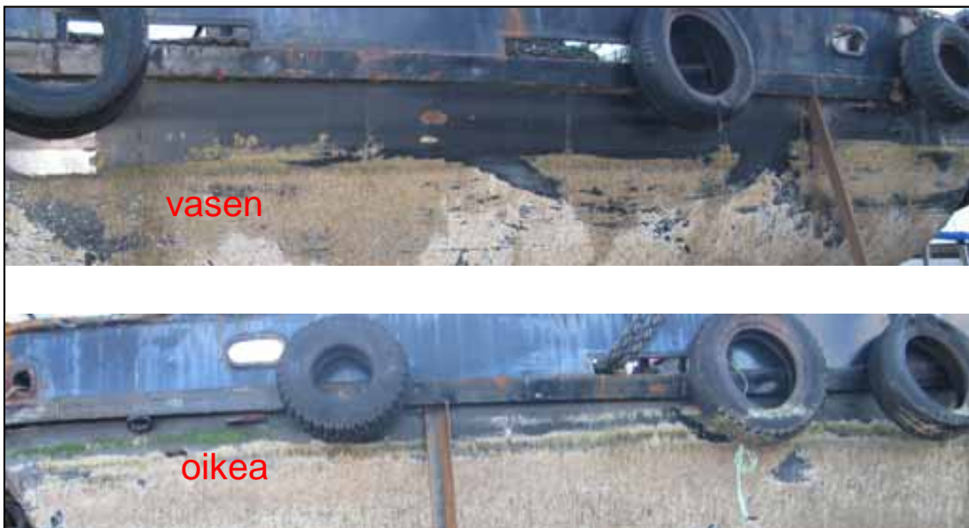
Kuva 11. ROLLEn vasen ja oikea kylki, joista on päätelty, että alus on ollut jonkin ver- ran kallellaan oikealle.
