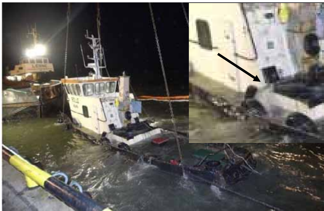
Kuva 7. ROLLEn nosto menossa illalla 2.10.2008. Eestin onnettomuustutkijoiden raportista saatu kuva. Kuvasta on suurennettu osa, jossa näkyy konehuoneen ilmaottoaukosta valuva vesi.
