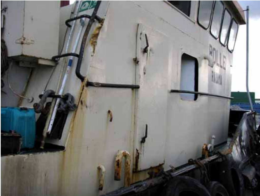
Kuva 14. Nostetun ROLLEN kansirakennuksen oikeaa laitaa. Oven yläosan korkeudelle näyttää tulleen kolhuja kontaktista REGAL STARin kanssa. Alaikkunallasi on poistettu, se vaurioitui joko kontaktin yhteydessä, uppoamisen tai ylösnoston aikana.
