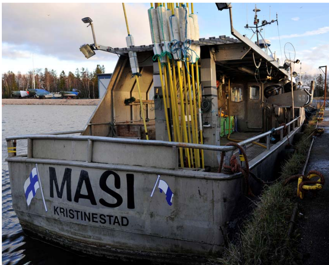
Kuva 6. MASIn peräosa, partaan korkeus vedenpinnasta on suuri
