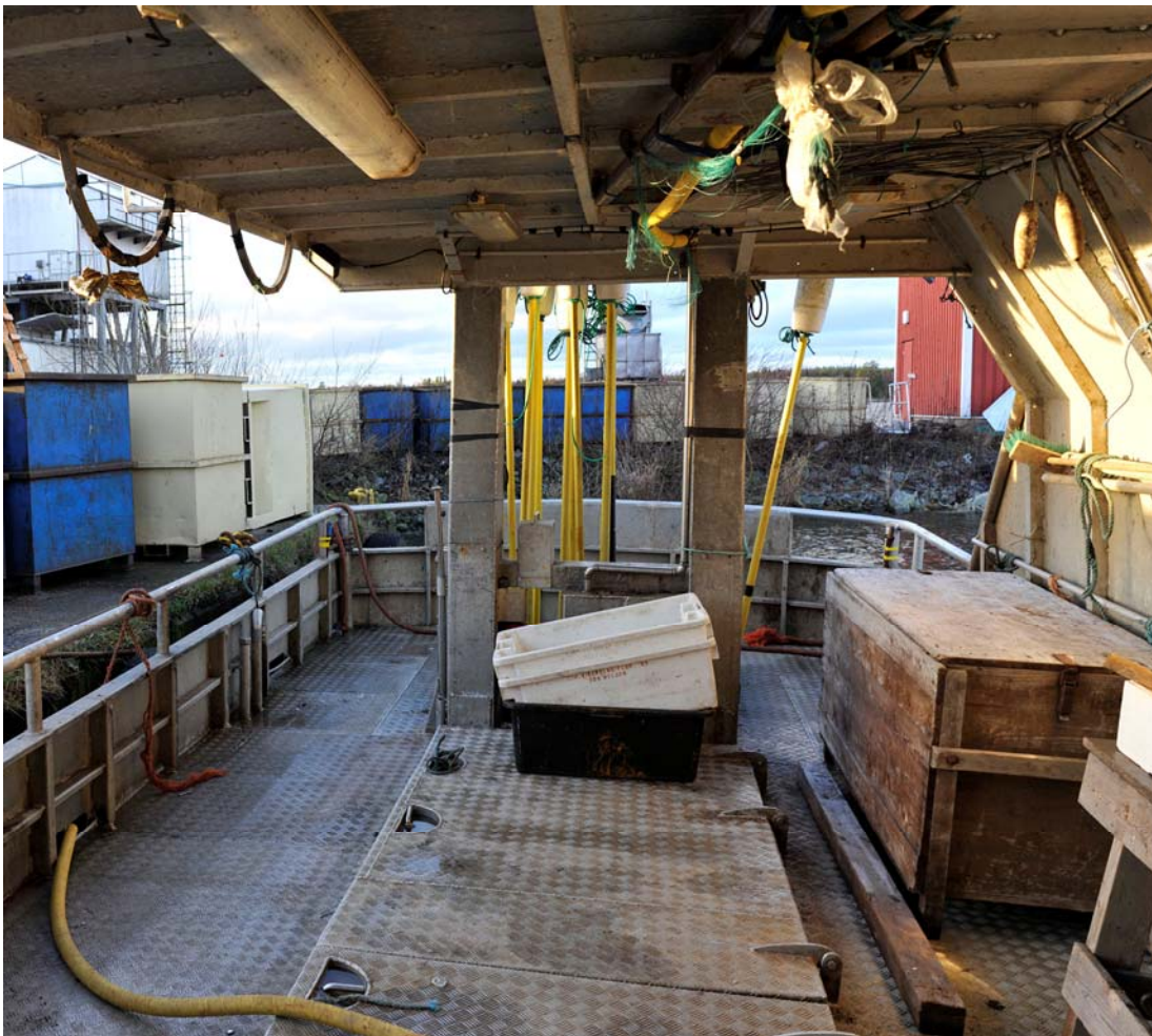
Kuva 2. MASIn peräkansi, josta verkot lasketaan perän partaan yli mereen. Partaan korkeus kannesta on noin 85 cm. (kuva uuden omistajan ajalta).
