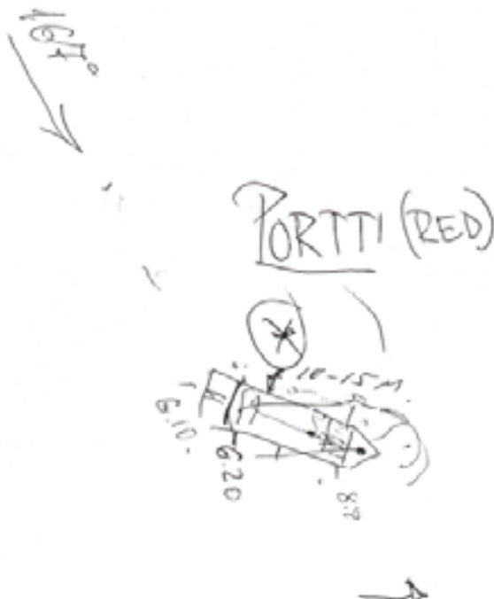
Kuva 7. Yliperämiehen tekemä piirros karilleajopaikasta, joka kuvaa aluksen kääntymisen karilleajon jälkeen. Aluksen suunta oli karilleajossa 120°.
