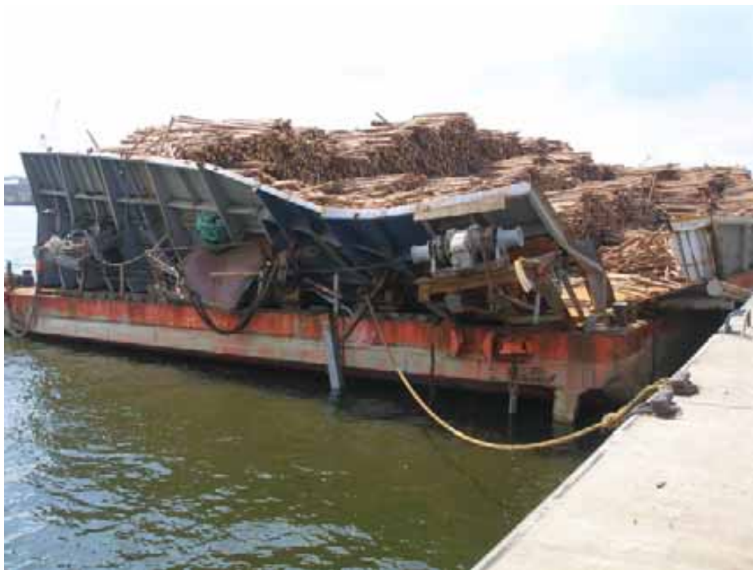
Kuva 10. Proomu CARRIERin perän vauriot.
