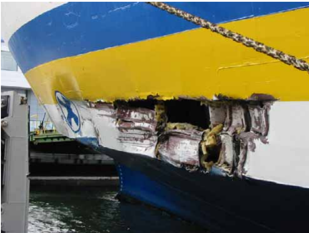
Kuva 20. NORDLANDIAN vaurio aluksen keulassa vasemmalla puolella. Vaurion aiheutti törmäys laiturin törmäysvaimentimeen (fenderiin). Kuvassa vasemmalla näkyy myös samanlaisen, mutta ehjän fenderin vaimenninosa.
