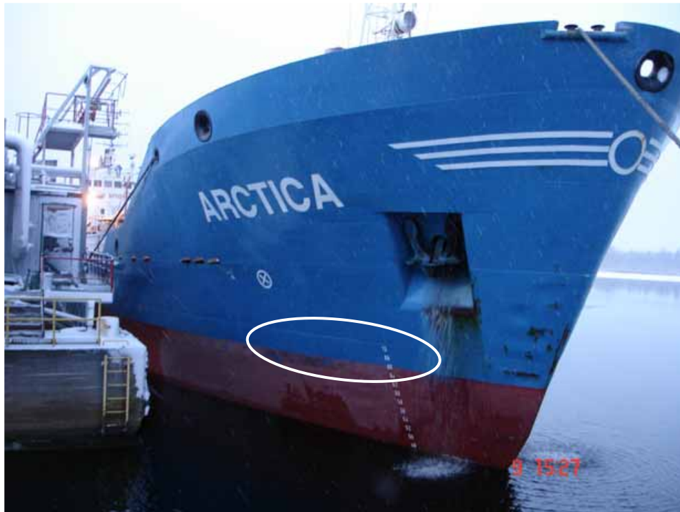
Kuva 11. ARCTICA Oulussa vauriokohta korjattuna. Vauriokohta on kuvassa rajattu valkoisella ellipsillä.
